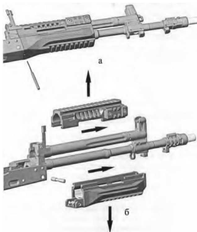
а - выдавливание пружины выколоткой; б - отделение цевья
