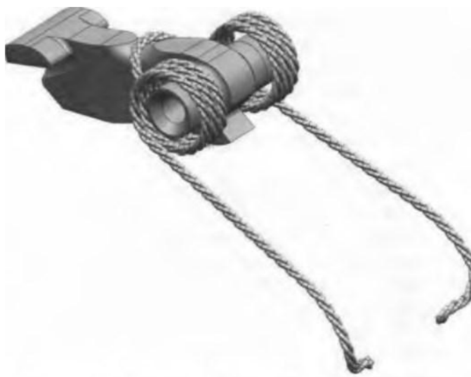
Рисунок 45 – Положение боевой пружины на курке
