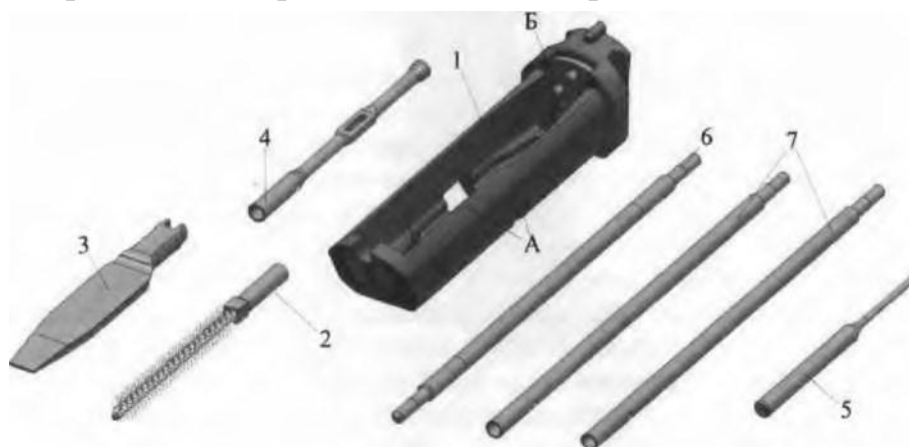
1 - контейнер в сборе; 2 - ерш в сборе; 3 - отвертка; 4 - протирка; 5 - выколотка; 6 - основание шомпола; 7 - шомпол; А - прямоугольные отверстия; Б - отверстие с резьбой.
