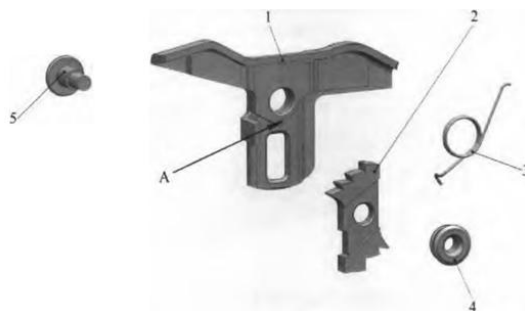
Рисунок 13 – Механизм отсечки очереди
