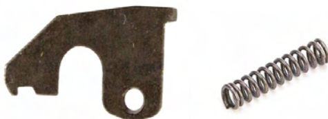
Рис. 19. Выбрасыватель с пружиной
