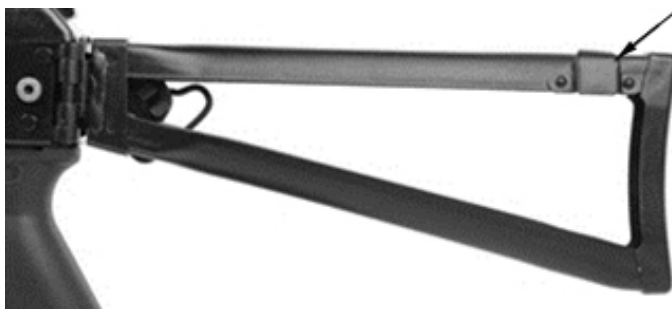
Рис. 27. Приклад (стрелкой отмечена защелка фиксации приклада в сложенном положении)
