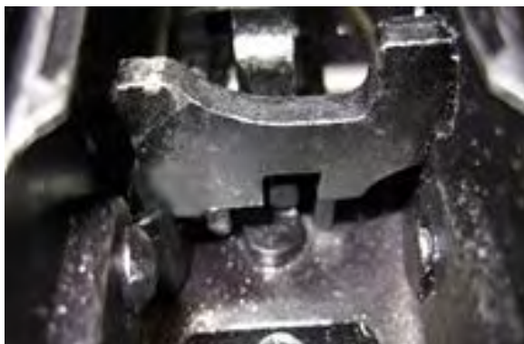
Рис. 24. Положение сектора предохранителя в затворной коробке
