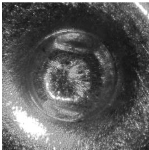
Рис. 33. След бойка ударника
