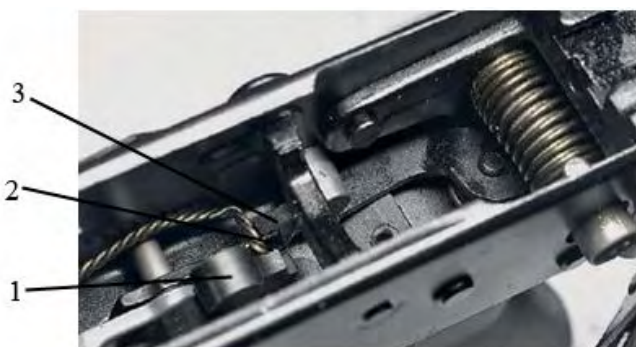
Рис. 20. Механизм блокировки спускового крючка: 1 — шептало одиночного огня; 2 — прямоугольный выступ спускового крючка; 3 — передний конец блокировочного рычага
