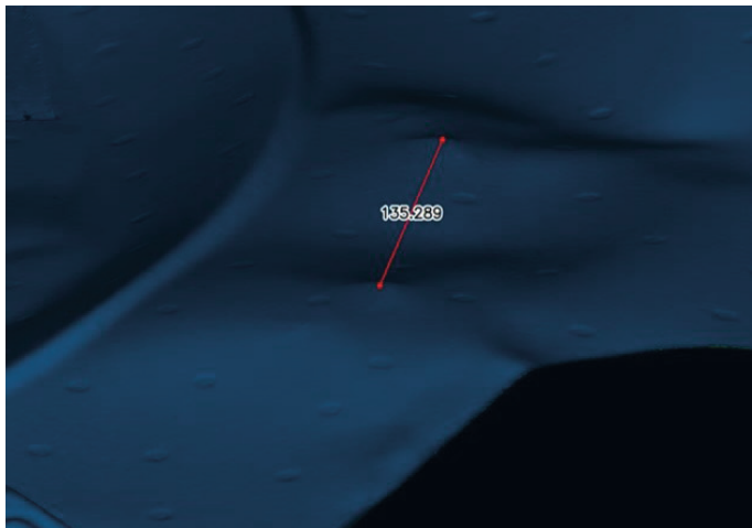
Рисунок 3 – Инверсия повреждения на левом переднем крыле автомобиля «Volkswagen Polo», зафиксированного при помощи 3D-сканера «Calibry Mini»
