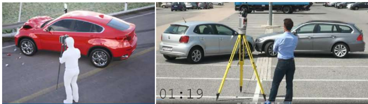
Рис. 3. Примеры применения 3D-сканера для фиксации следов на месте ДТП
