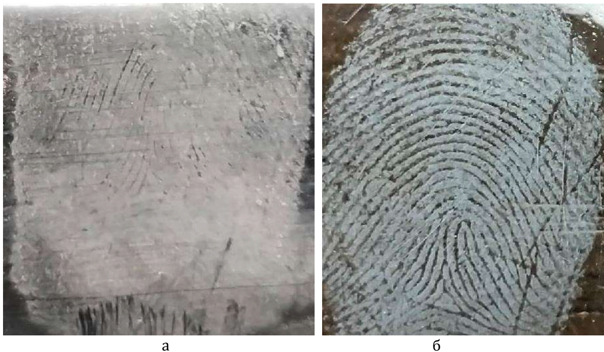
Рис. 6. Следы рук на полимерном материале, находившемся в течение 5 суток при температуре -18^{\circ}\text{C} , выявленные дактилоскопическим порошком «ПД-Б» после отогревания: а – в естественных условиях; б – с помощью фена
