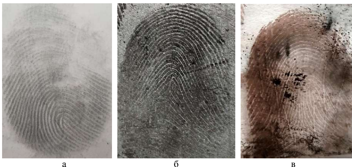
Рис. 10. Следы рук, выявленные на различных поверхностях при температуре воздуха от -7 °С до -11 °С: а – мелкодисперсным проявителем на основе водного раствора этанола; б – суспензией оксида железа ( \text{Fe}_3\text{O}_4 ) на основе водного раствора пропиленгликоля; в – суспензией оксида железа ( \text{Fe}_2\text{O}_3 ) на основе водного раствора пропиленгликоля
