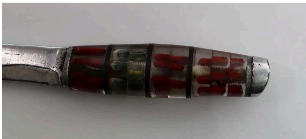
Рис. 7. Рукоять самодельного ножа, изготовленная из полиметилметакрилата
