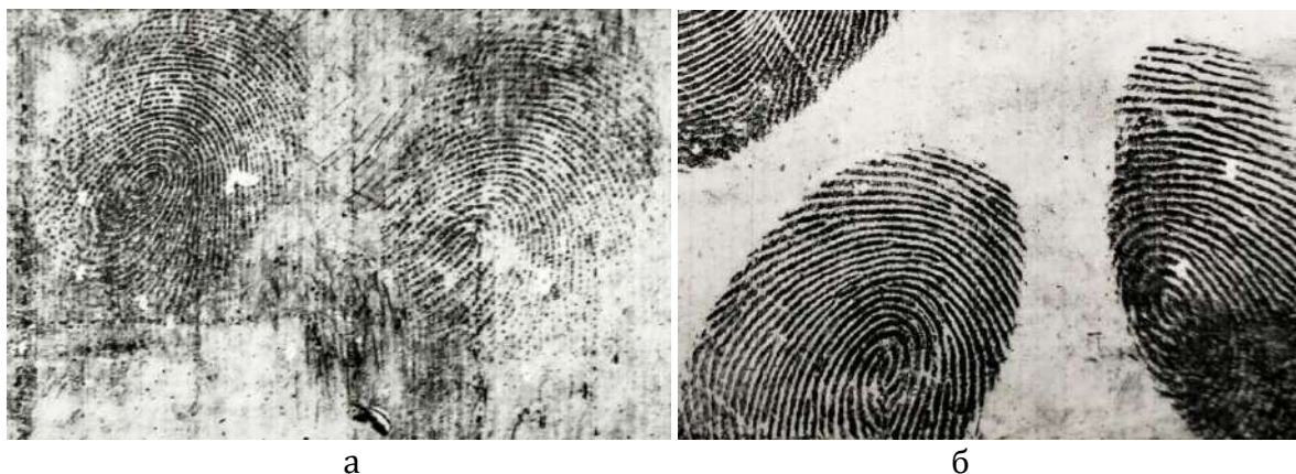
Рис. 11. Следы рук, образованные на охлажденном оцинкованном металле, пребывавшие в течение 1 суток при температуре от -11 до -18 °С и выявленные вне помещения при температуре -12 °С: а – дактилоскопическим порошком «Сажа»; б – смесью № 2 (табл. 4)
