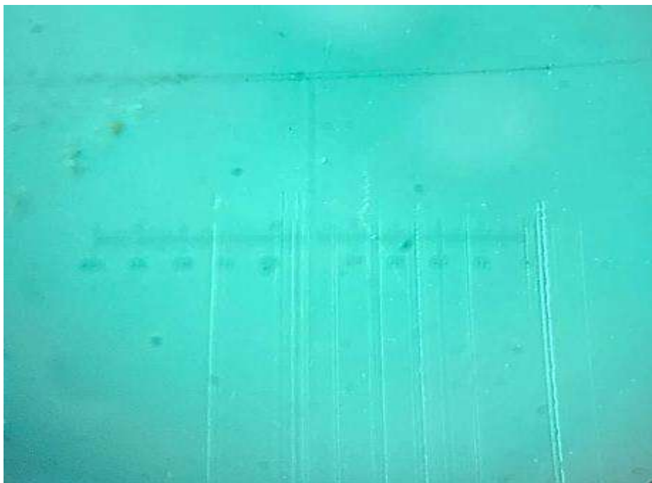
Рис. 7. Применение направленного источника освещения и синего светофильтра для контрастирования следа скольжения на полимерной поверхности (слева) и фрагмент динамического следа скольжения на полимерной поверхности исследуемого объекта в поле зрения микроскопа. МСП – ТМ в отраженном косопадающем при увеличении объектива микроскопа 0,65х с применением синего светофильтра
