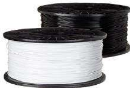
Рис. 20. Полимерный материал (пластик PETG), применяемый для изготовления макетов
