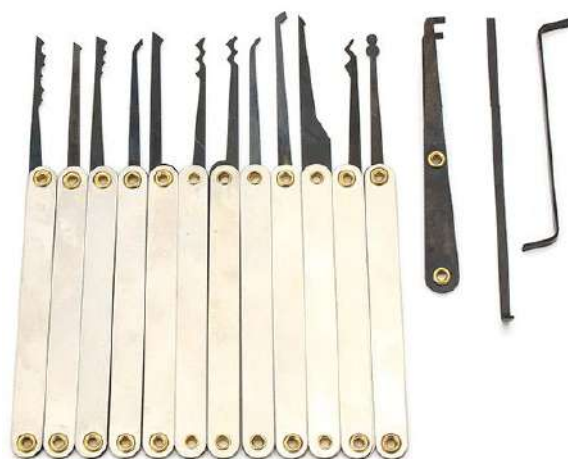
Рис. 1. Комплект отмычек для отмыкания цилиндрических блоков секрета со штифтовым и рамочным видами задержки
