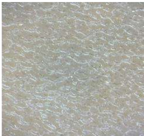
Образец № 6 (искусственная кожа) отвер- стий от волосяных луковиц не обнаружено, имеется их имитация в виде нанесения краски более темного цвета чем фон в виде «клякс»
