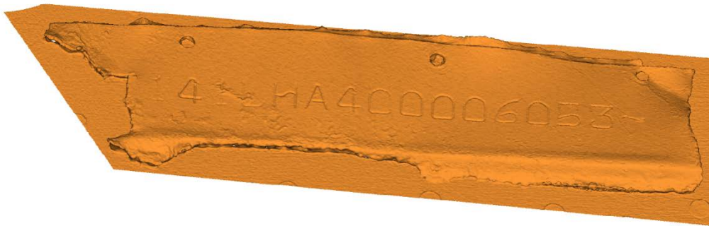
Рис. 2. 3D-модель-фрагмент информационной таблички, полученная с помощью ручного 3D-сканера Calibry Mini
