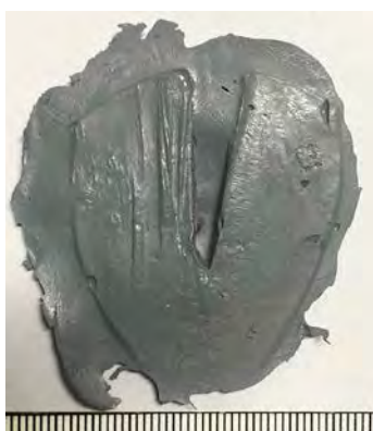
Рис. 7. Модель следа орудия взлома, полученная с помощью слепочной массы «MIKROSIL»
