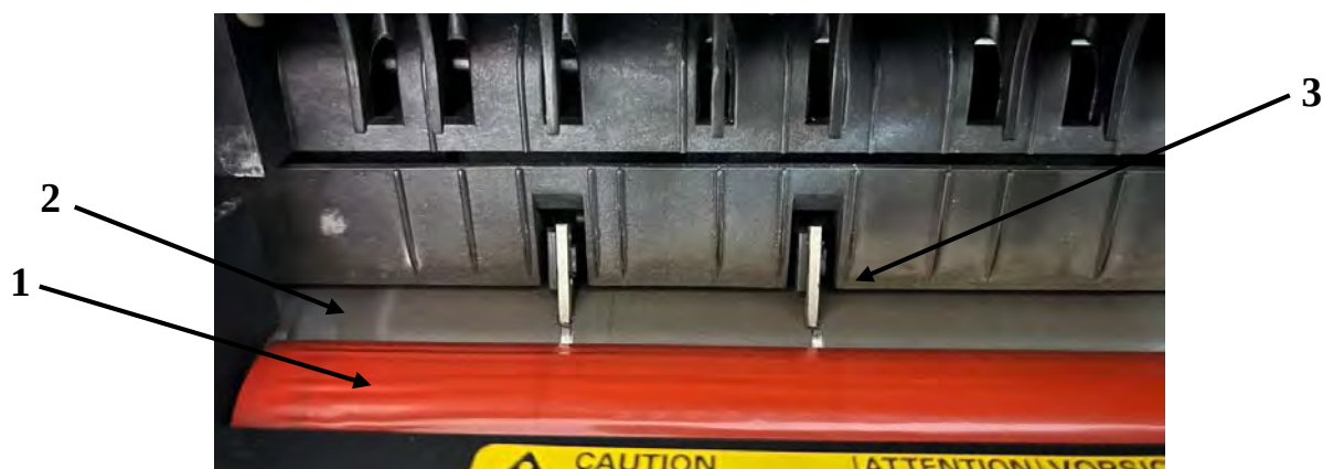
Рис. 4. Узел термозакрепления МФУ Kyocera KM 1635: прижимной вал (1), нагревательный вал (2) и подающий механизм (3) на нем (указаны стрелками)
