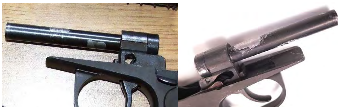
Рис. 1. Примеры восстановления структурной целостности ствола пистолета посредством применения холодной сварки, отмечено стрелками
