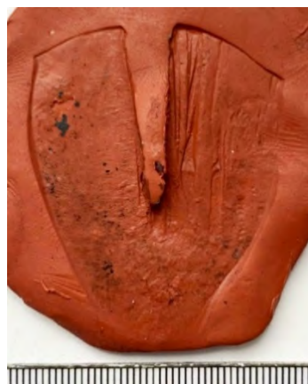
Рис. 6. Экспериментальный след орудия взлома, образованный лапчатой частью лома-гвоздодера
