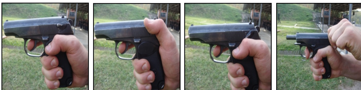
Рис. 240 б. Снятие пистолета с предохранителя и досылание патрона в патронник способом захвата рукой за заднюю часть затвора
