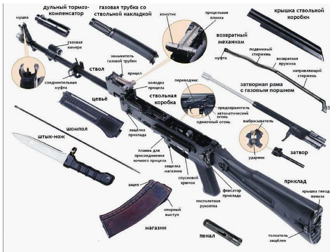
Устройство автомата АК-74
