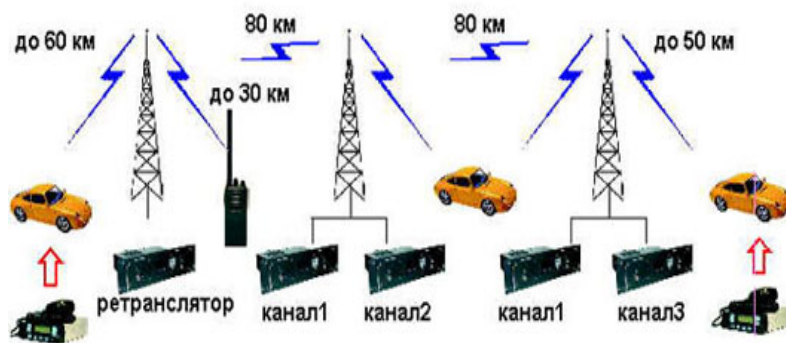
Рис. 16. Системы радиосвязи с ретранслятором
