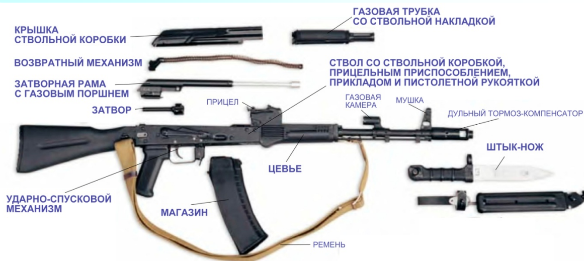
Рис. 36. Основные части и механизмы автомата АК74
