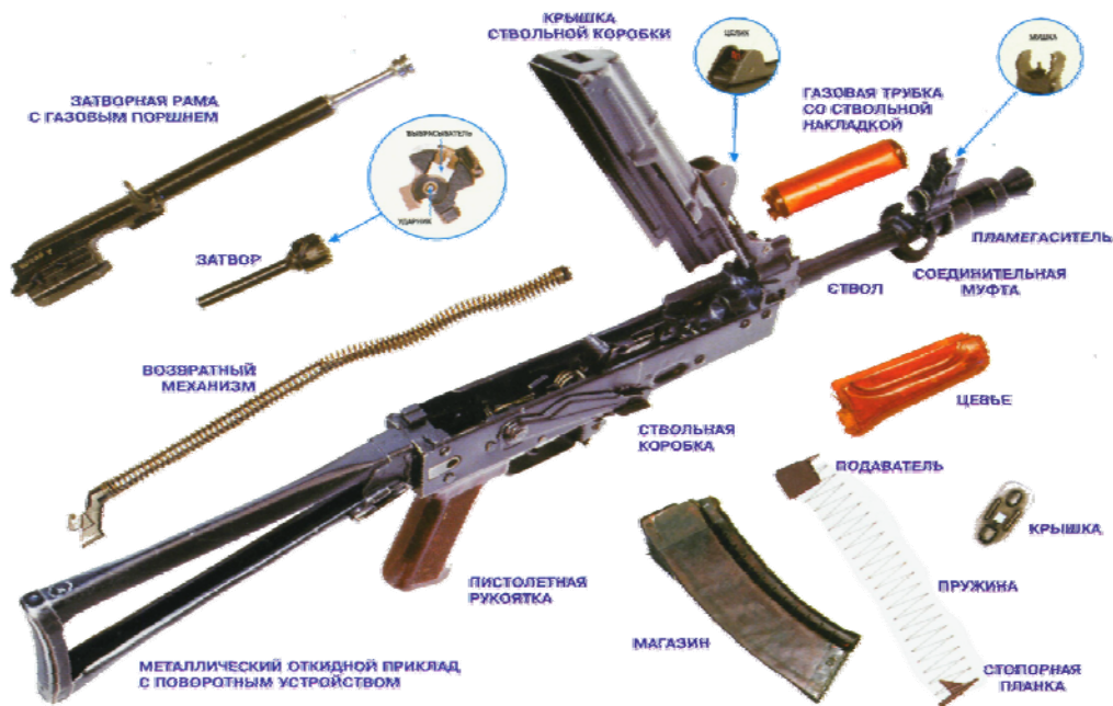
Рис. 37. Основные части и механизмы автомата АКС74У
