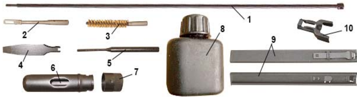
Рис. 41. Принадлежность: 1 – шомпол; 2 – протирка; 3 – ершик; 4 – отвертка; 5 – выколотка; 6 – пенал; 7 – крышка; 8 – масленка; 9 – обойма; 10 – переходник
