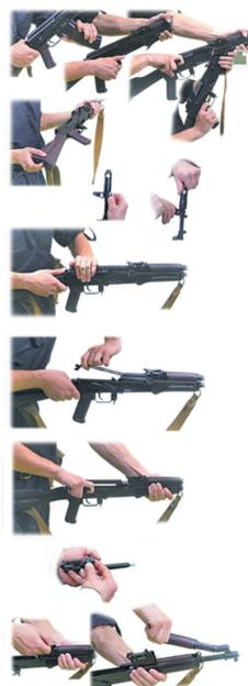
Сборка автомата после неполной разборки производится в обратной последовательности (после присоединения (закрытия) крышки ствольной коробки — спустить курок с боевого взвода и поставить автомат на предохранитель).
