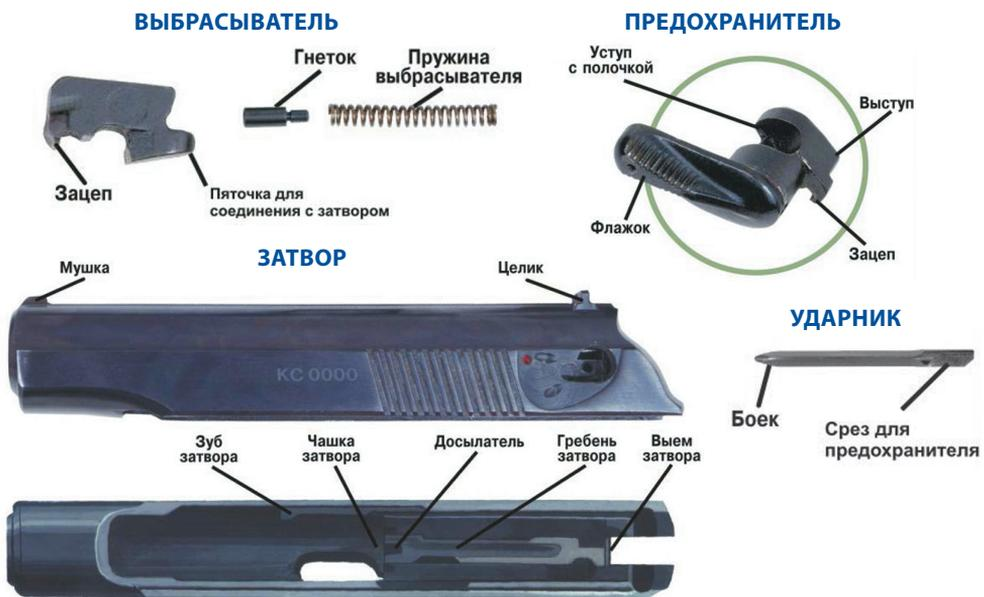
*Затвор с ударником, выбрасывателем и предохранителем*
