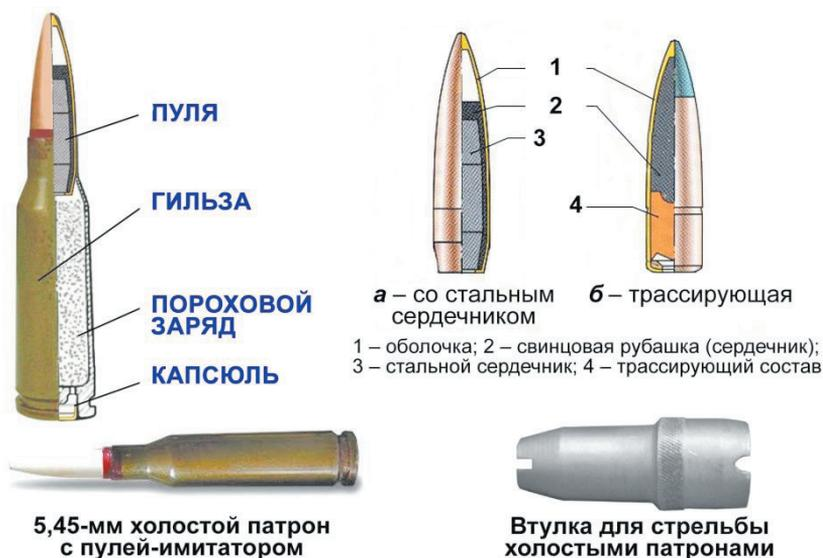
Общий вид 5,45-мм автоматного патрона и его устройство
