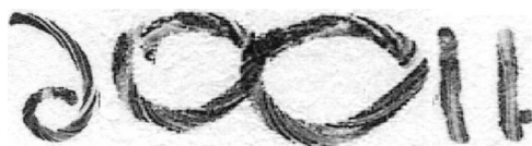
Рис. 59. Полосатая структура штриха шариковой ручки
