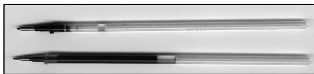
Рис. 61. Стержни гелевых ручек (конический и игольчатый)
