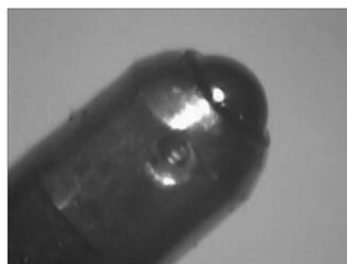
Рис. 66. Изображение кончика игловидного пишущего узла
