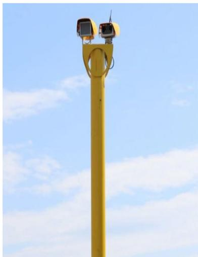
В условиях низкой освещенности для фиксации событий система использует ИК-лампу VECTOR IR, которая может быть закреплена на столбе вместе с камерой. Синхронизированная импульсная подсветка позволяет снизить энергопотребление. Не создает видимых лучей света, что позволяет избегать светового загрязнения затемненных участков дороги. Лампа имеет компактные габаритные размеры и весит 3 кг.
