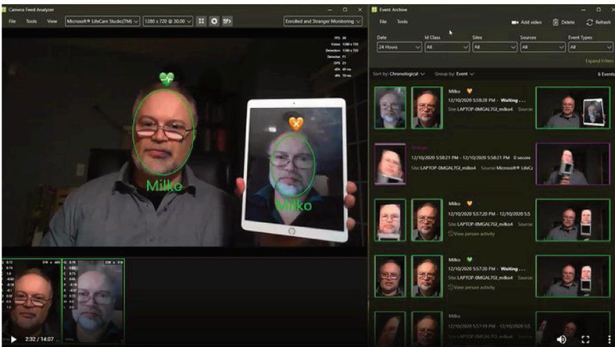
Независимо от типа 2D-камеры (IP-камера, встроенная в терминал управления доступом, миниатюрная АТМ-камера, USB-камера или камера ноутбука), алгоритм системы анализирует текстуру и контекст изображения, основанные на данных спектра видимого излучения в системе RGB.
