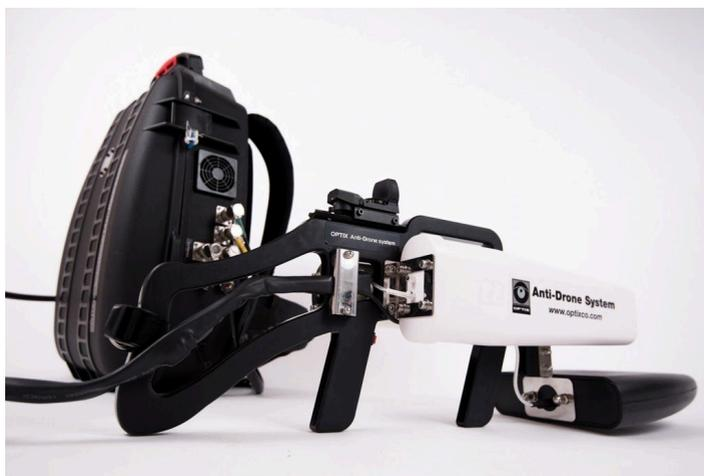
в точку старта. Использует сочетание радиочастотной системы обнаружения и системы радиопротиводействия, комбинируя направленные и всенаправленные помехи. Система прерывает удаленное управление БПЛА, телеметрическую связь, телевизионную линию связи, передачу данных по GPS/GLNOSS. Эффективна против БПЛА стандартных, малых и сверхмалых размеров.
