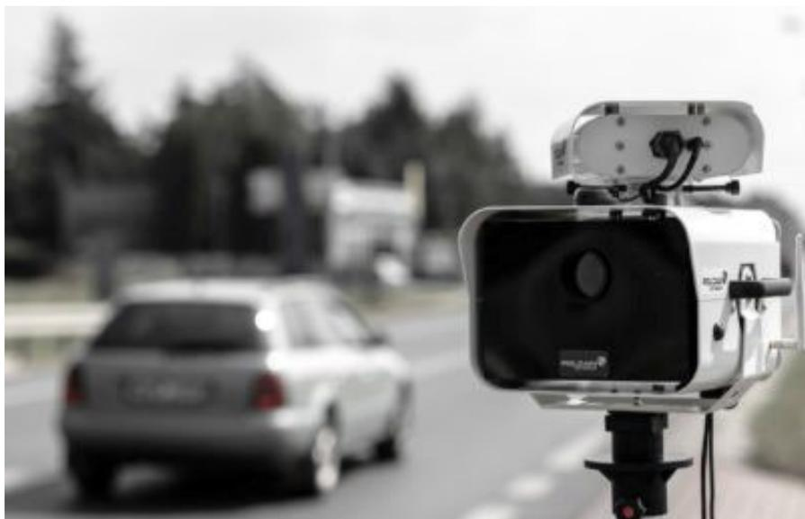
сте с ИК-экраном или стационарно на высоте 3-9 м над дорогой, а также на обочине на расстоянии до 9 м от дороги с настройкой удаленного управления. Система отслеживает до 32 автомобилей с одновременным измерением скорости, дистанции и других ключевых параметров каждого автомобиля. Параметры автоматического мониторинга могут быть настроены для каждой полосы и каждой модели автомобиля.
