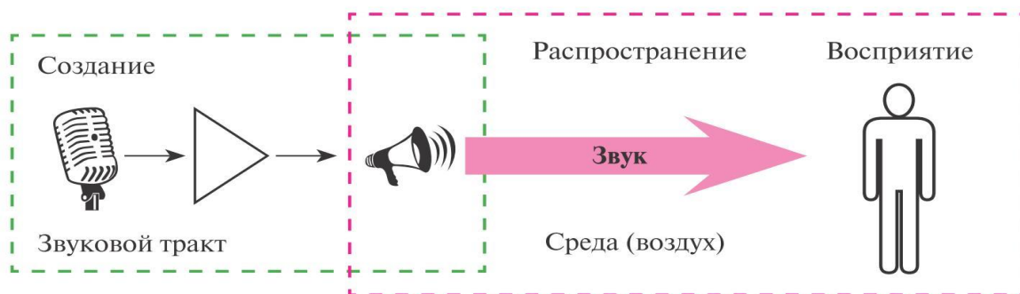
Рис. 1. Распространение звукового сигнала
