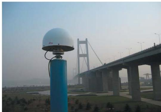
Рис. 2. Постоянно действующая базовая станция ГНСС.
