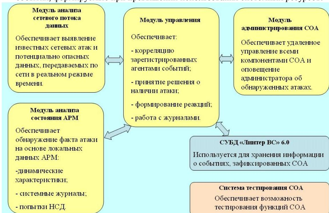
Рисунок 1.2 – Схема СОА
