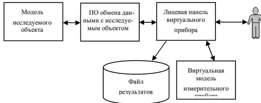
Рис. 1. Структурная схема лабораторной работы
