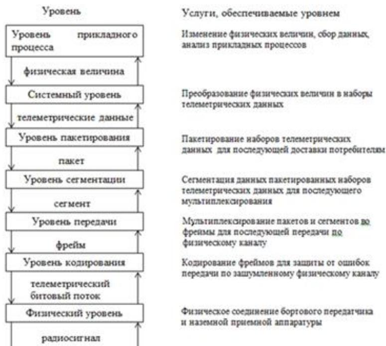
Рис. 1. Иерархическая модель телеметрических служб
