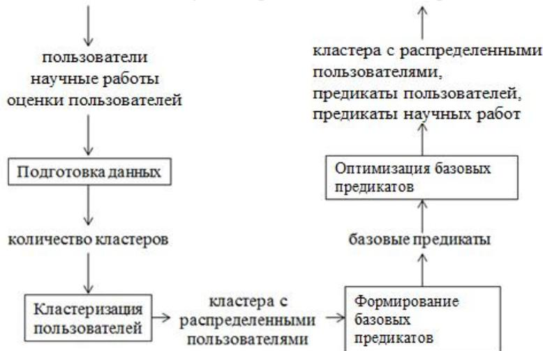
Рис. 1. Схема рекомендательной системы научных работ
