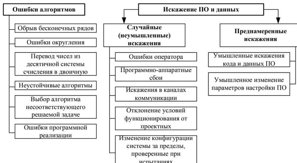
Рис. 1. Источники ошибок, вносимых программным обеспечением метрологического назначения
