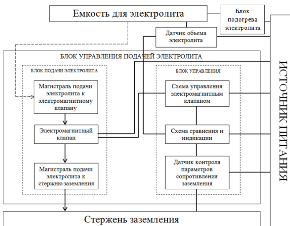
Рисунок 3 – структурная схема устройства автоматической подачи электролита к стержню заземления
