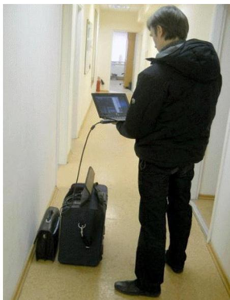
Комплекс может также использоваться и для скрытого обследования подозрительных лиц (групп лиц). В этом случае комплекс камуфлируется под наплечную сумку и позволяет с расстояния метра за секунду получить изображение различных предметов с разрешением 2 мм.
