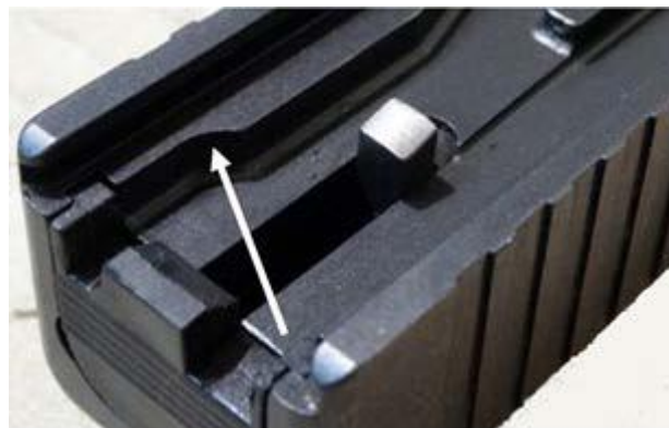
Рис. 8. Скос выступа на нижней плоскости затвора
