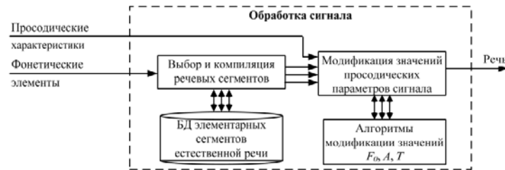
Рис. 4. Схема конкатенативного метода генерации речевого сигнала
