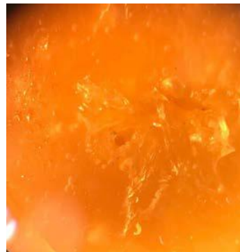
б – увеличенное изображение повреждения на компаунде, причиненное орудием, обладающим колющими свойствами (увеличение 16 х )
