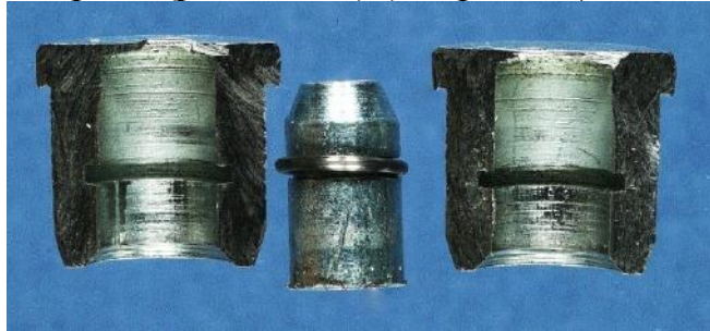
Рис. 13. Запирающий механизм ЗПУ, после разборки
