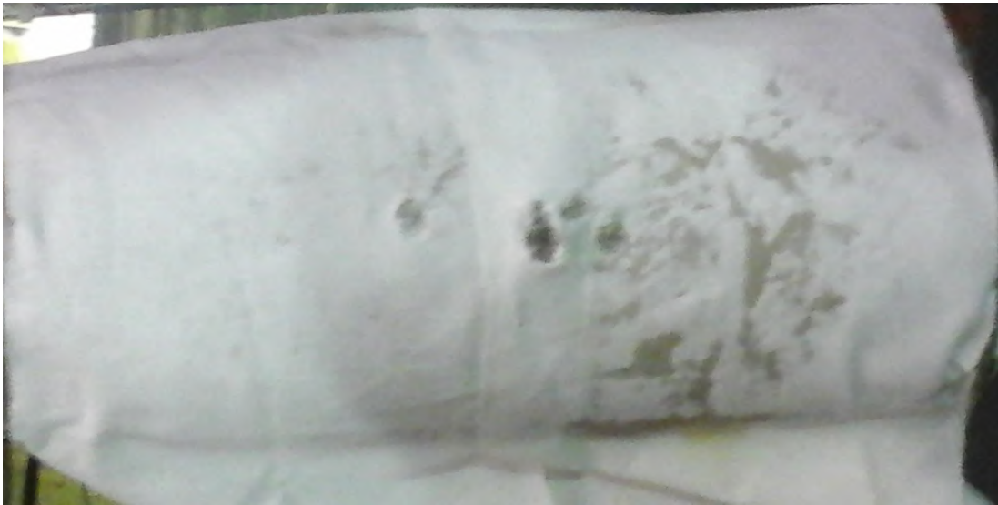
Рис. 2. Блок компаунда. Моделирование огнестрельных повреждений на различных по форме частях тела человека
