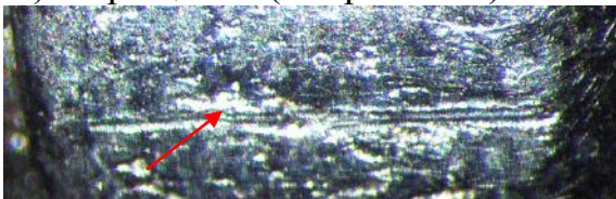
Рис. 14. Фрагмент стержня ЗПУ (А) и фрагмент внутренней поверхности корпуса (Б) (красителем красного цвета показан след вторичного запирания, красителем желтого цвета-следы вращения)
