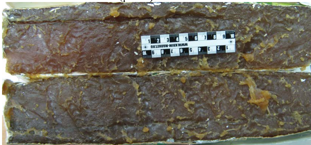
Рис. 1. Блок компаунда в разрезе. Канал повреждения, образованный 9 мм пулей при стрельбе из пистолета Макарова, патронами 9x18 мм (ППО), дистанция 60 см (стрелками отмечен пулевой канал)
