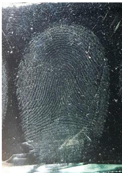
Рис. 2 Жировой след пальца на стекле после нагрева при температуре 600 °С в течение 15 минут
