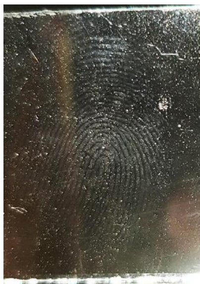
Рис. 1 Потовой след пальца на стекле после нагрева при температуре 300 °С в течение 20 минут
