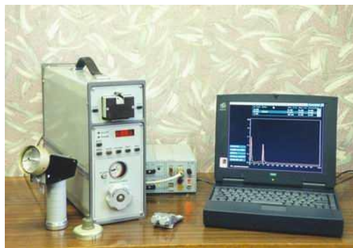
Рисунок 2. Высокочувствительный газохроматографический анализатор взрывчатых веществ «ЭХО - М» (с детектором электронного захвата)
