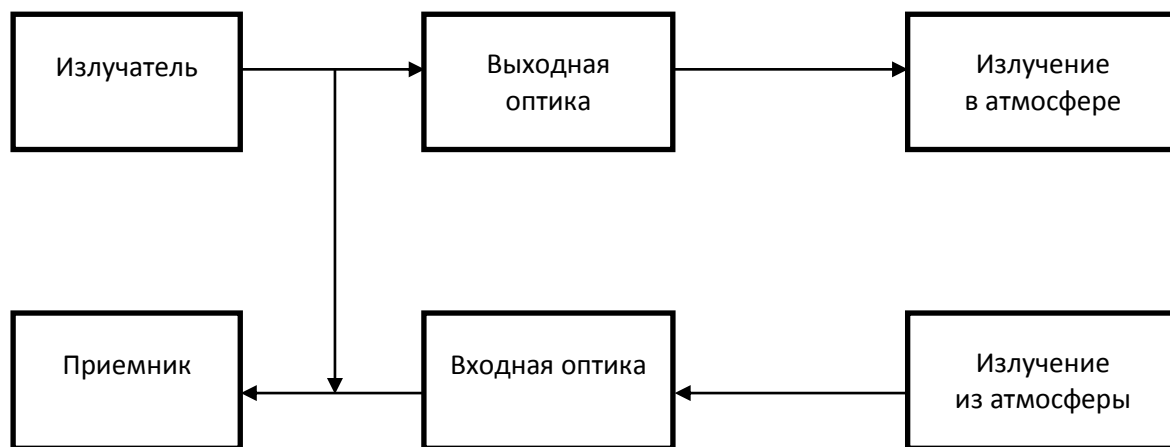
Рисунок 2. Схема доплеровского измерителя скорости с гетеродином
