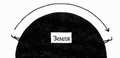
*Рисунок 4. Распространение радиосигнала поверхностной волной*
