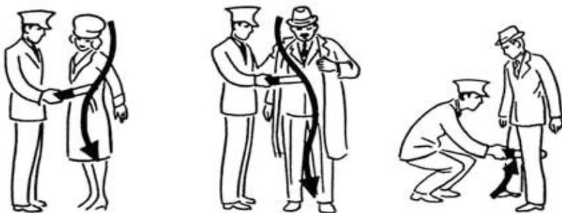
Рис. 14. Правильное перемещение ручного металлоискателя
