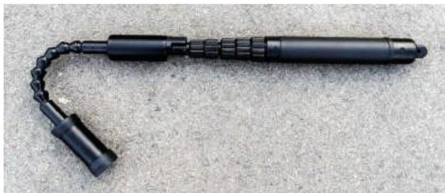
Рис. 32. Видеоэндоскоп «Констебль»
