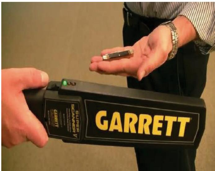
Рис. 10. Ручной металлодетектор
