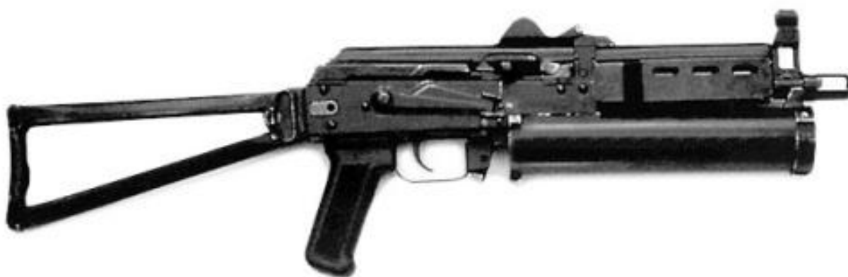
Ранний вариант ПП-19 "Бизон" со шнековым магазином на 64 патрона калибра 9х18мм ПМ
