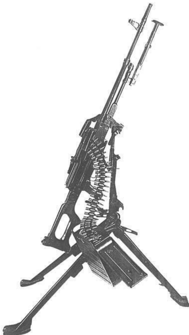
Пулемет ПКС в положении для стрельбы по воздушным целям
