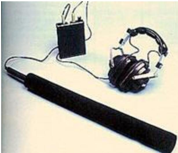
*Рис. 3.27. Комплекс специальных остронаправленных микрофонов «Вереск»*
