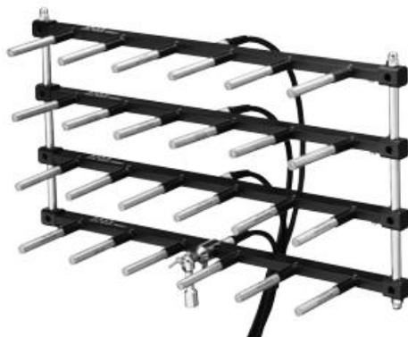
Рис. 3.14. Внешний вид микрофонной решетки, обладающей направленностью звуковосприимчивости
