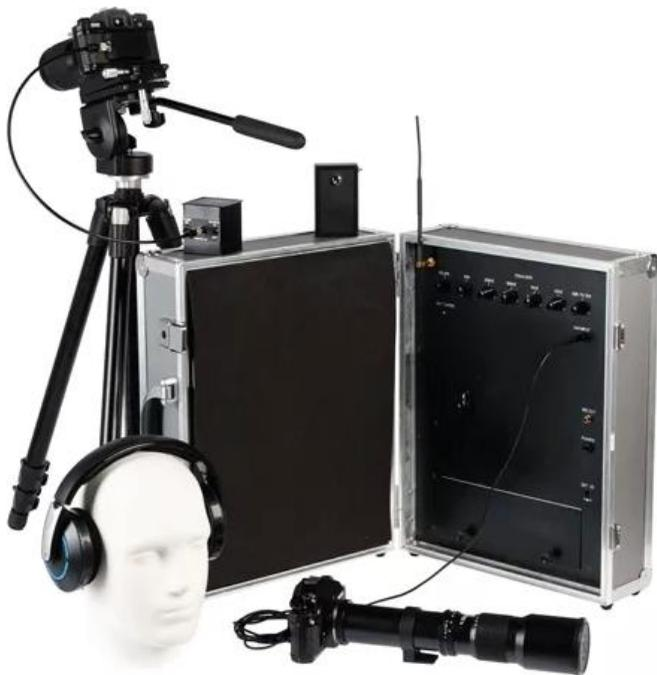
*Рис. 3.19. Лазерный микрофон для акустического наблюдения*
