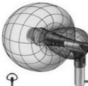
*Рис. 3.3. Односторонне направленный микрофон*
