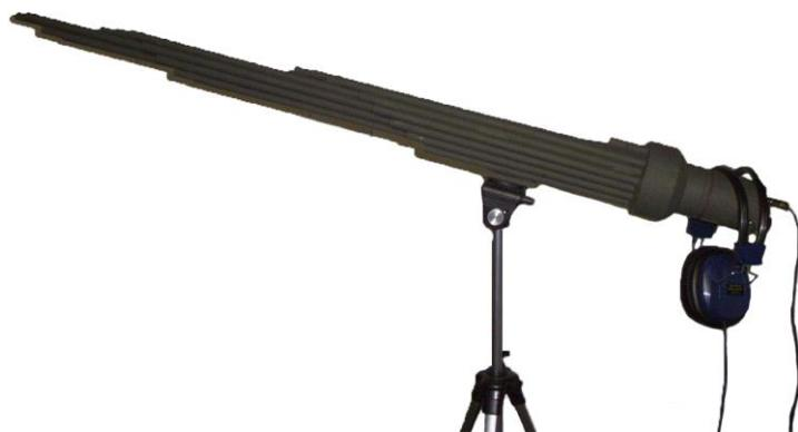
*Рис. 3.10. Внешний вид резонансного микрофона*
