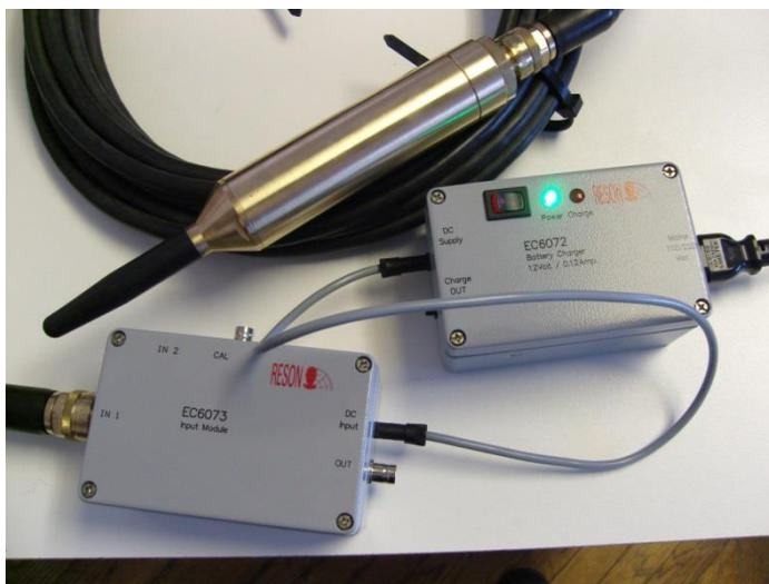
Рис. 3.18. Внешний вид гидрофона
