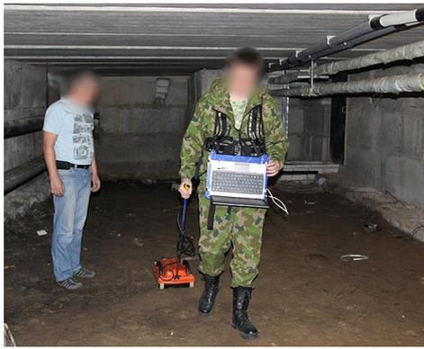
Рис. 64. Фотография осмотра места происшествия в подвале георадаром «Око-3»
