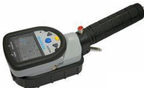
Рис. 68. Устройство поиска неоднородностей Polimaster УПН-РМ 2030
