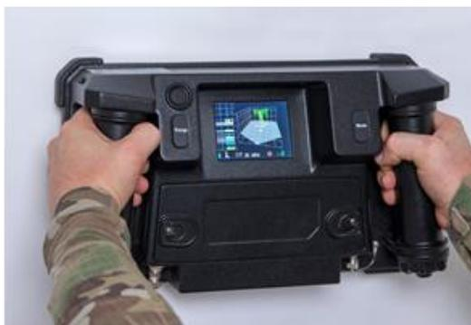
Рис. 71. Компактный радар Xaver-400
