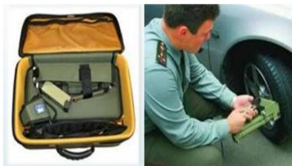
Рис. 55. Рентгеновский сканер скрытых полостей «Ватсон»
