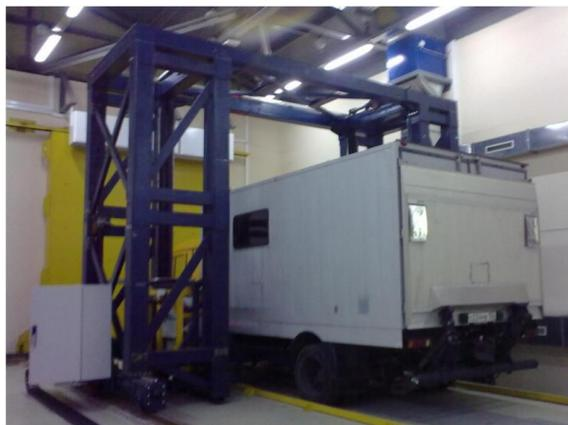
Рис. 22. Нейтронный портал для досмотра крупногабаритных транспортных средств
