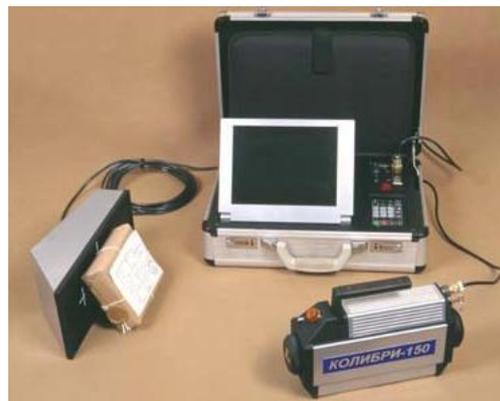
Рис. 56. Переносной цифровой рентгеновский комплекс «Колибри-150 ТВ»
