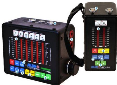
Рис. 73. Устройство Delsar LifeDetector LD3 (вибро- и акустический анализатор)
