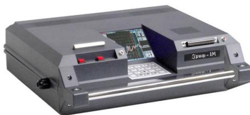
Рис. 26. Портативный экспресс-анализатор (спектрометр) «Гриф-1М»
