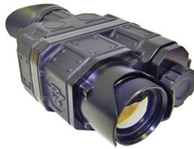
Рис. 75. Портативный поисковый тепловизор «КАТРАН-М»
