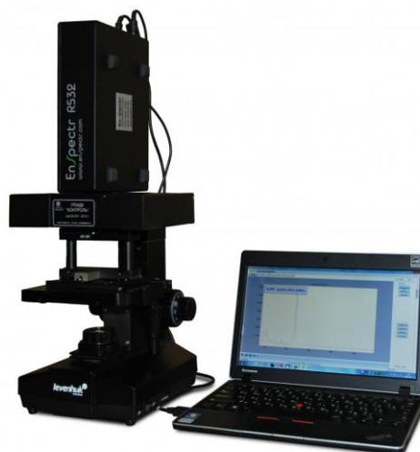
Рис 28. Портативный прибор идентификации драгоценных камней «КОНТРОЛЬ»
