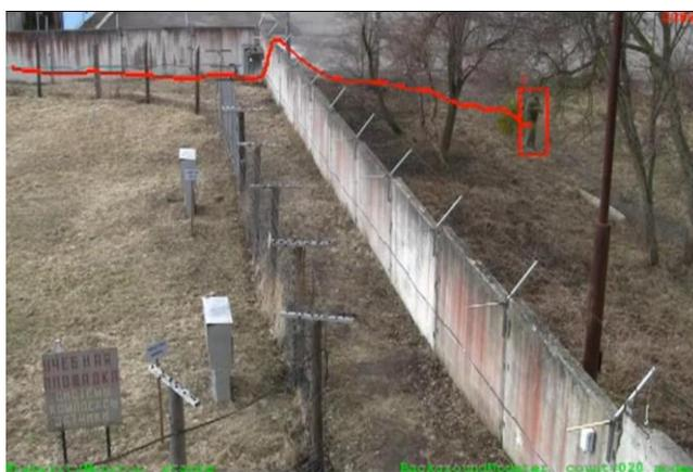
Рис. 86. Пример работы периметральной видеоаналитики
