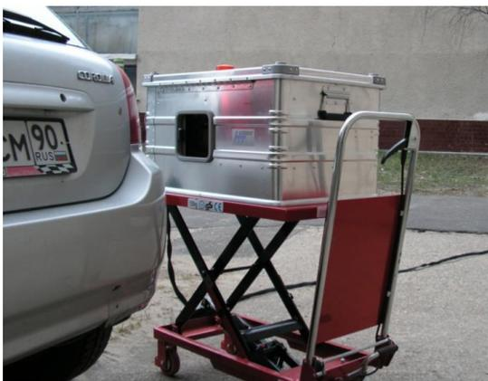
Рис. 21. Переносной детектор взрывчатых веществ «ДВИН-1»
