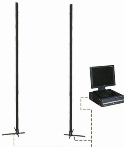
Рис. 9. Магнитный томограф «Зонд-П»
