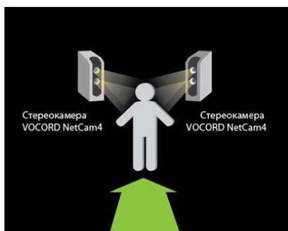
Рис. 91. Принцип работы рубежа контроля системы *VOCORD FaceControl 3D*
