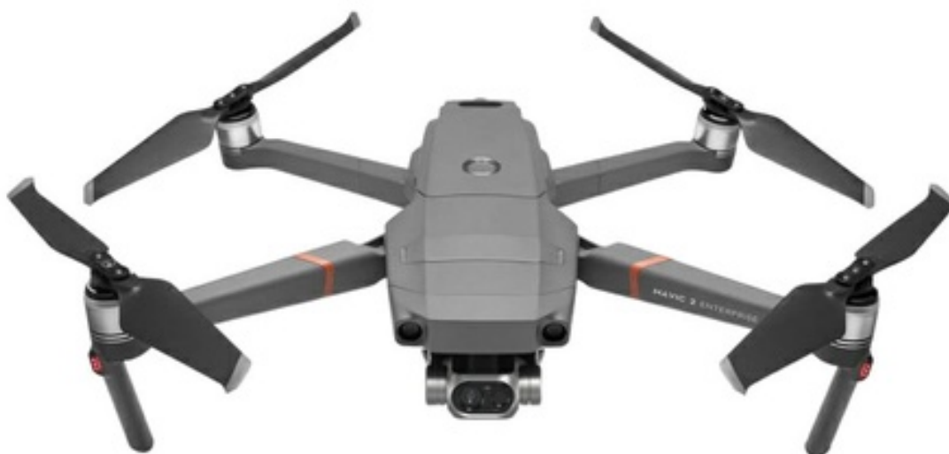
Рис. 50. Квадрокоптер DJI Mavic 2 Enterprise Dual
