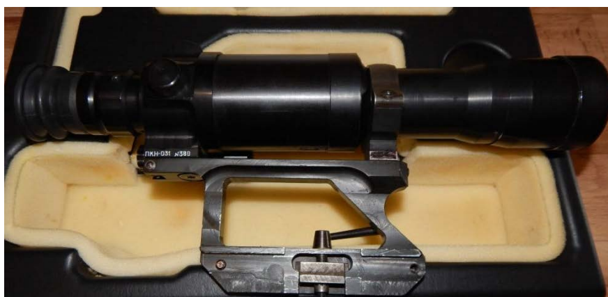
Рис. 29. Ночной коллиматорный прицел ПКН-03
