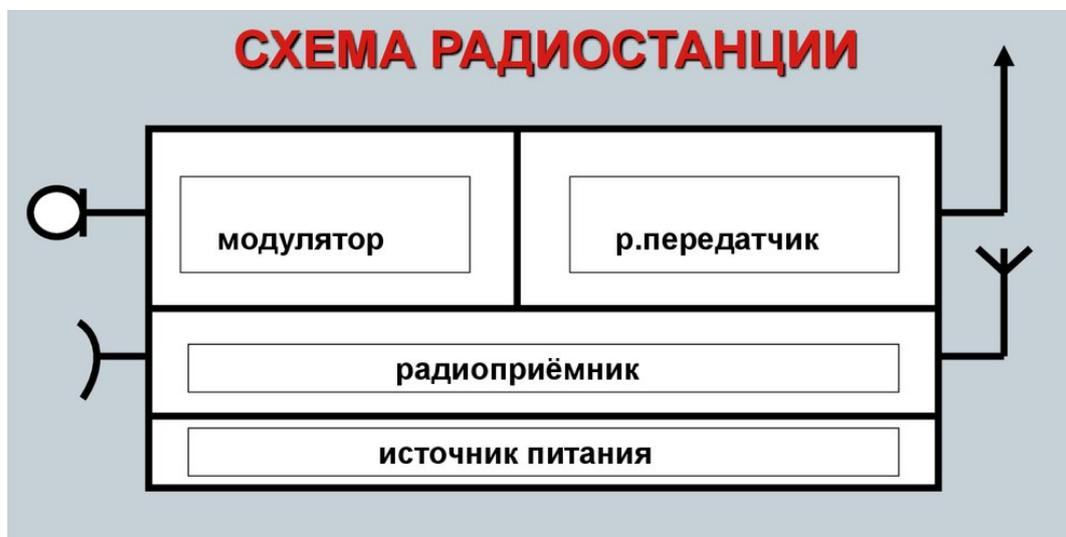
Рис. 2.1. Структурная схема ОВЧ - радиостанции
