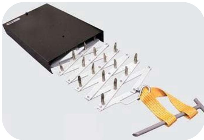
Заграждение «Лиана-6000» предназначено для механического повреждения пневматических шин легкового и грузового автотранспорта с любой нагрузкой на ось и толщиной протектора не более 45 мм. Рабочая часть изделия представляет собой раздвижную ленту, состоящую из перфораторов, оснащенных съемными остроконечными трубчатыми шипами. Для увеличения эффективности при наезде автомобиля на изделие шипы остаются в покрышке колеса, стравливая воздух даже при наличии подкачки.
