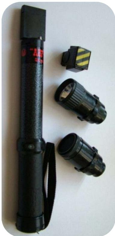
Электрошоковое устройство предназначено для контактно-дистанционного нелетального воздействия на правонарушителя сериями коротких электрических разрядов тока высокого напряжения. Корпус устройства выполнен в виде цилиндрической трубки из стеклопластика, с диэлектрической головкой в передней части, в которой размещены разрядные электроды. В корпусе расположены блок формирования высокого напряжения, блок управления, блок электропитания.
