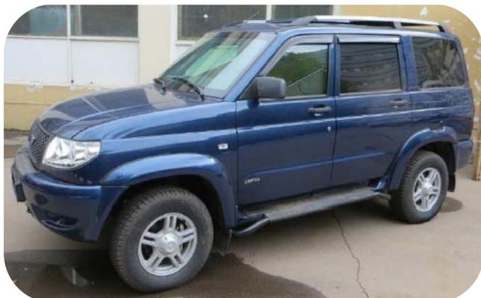
Предназначен для перевозки личного состава и ценных грузов, выполнения функций группы сопровождения, с обеспечением защиты экипажа от поражения из стрелкового оружия и взрывных устройств. Изготовлен на базе легкового автомобиля повышенной проходимости УАЗ-3163 «Патриот» и его модификаций. Бронирование выполнено по технологии объемно-дифференцированной броникапсулы без внешних признаков бронирования. В окнах устанавливаются бойницы, которые по требованию заказчика могут быть скрытого исполнения.
