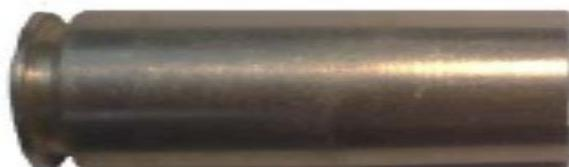
Патрон предназначен для создания на расстоянии 0,8 м от открытого торца гильзы мощной вспышки, сопровождающейся направленной в сторону нападающего звуковой волны, что приведет к временному ослеплению и оглушению нападающего. Эффект ослепления длится от 5 до 30 с в зависимости от освещенности окружающего фона. Наибольший эффект достигается в вечернее и ночное время и в плохо освещенных помещениях. Отстреливается из пистолета бесствольного ПБ-4СП.
