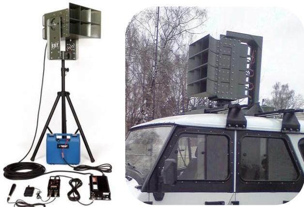
Электропитание ЗВУ-К осуществляется от литиевой аккумуляторной батареи RT-L55-24 со встроенной схемой баланса и защиты, емкостью 55 Ач и выходным напряжением 24 В. Заряд аккумуляторной батареи производится от сети ~220 В или от бортовой сети 12 В. Режим работы – произвольный, в том числе круглосуточный.
