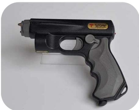
Для дистанционного воздействия используется дистанционный электрический картридж «изделие «ДЭК», позволяющий производить выброс токоведущих проводников на расстояние до 4,5 м.
