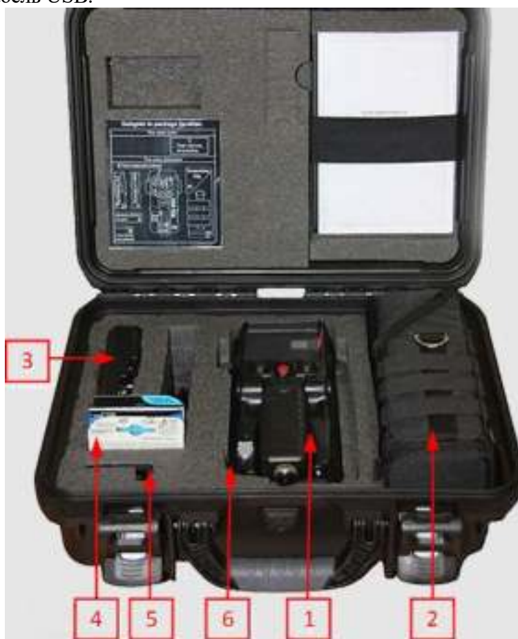
Рис. 5.187. Состав комплекта радара-обнаружителя РО-900 в кейс-укладке
