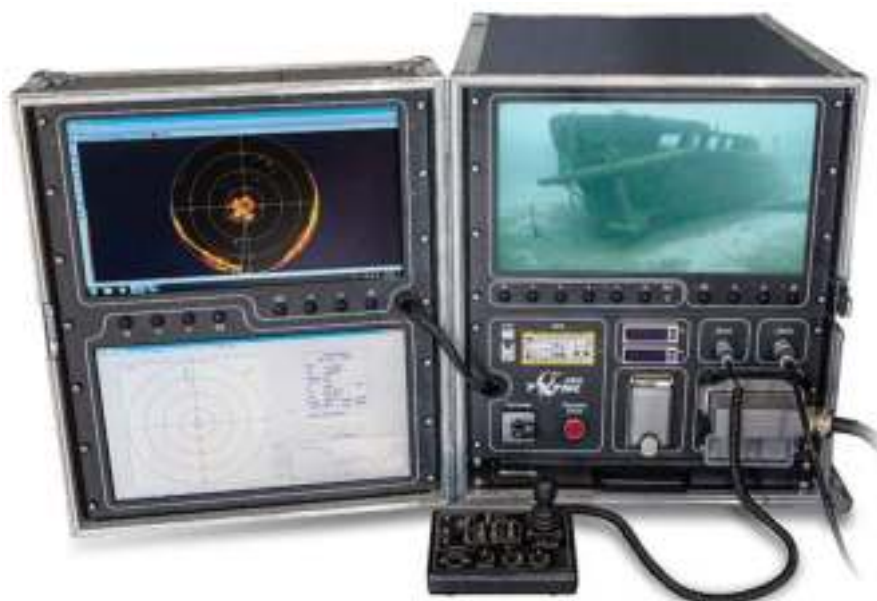
Рис. 5.296. Надводный модуль ТНПА «Марлин-350»
