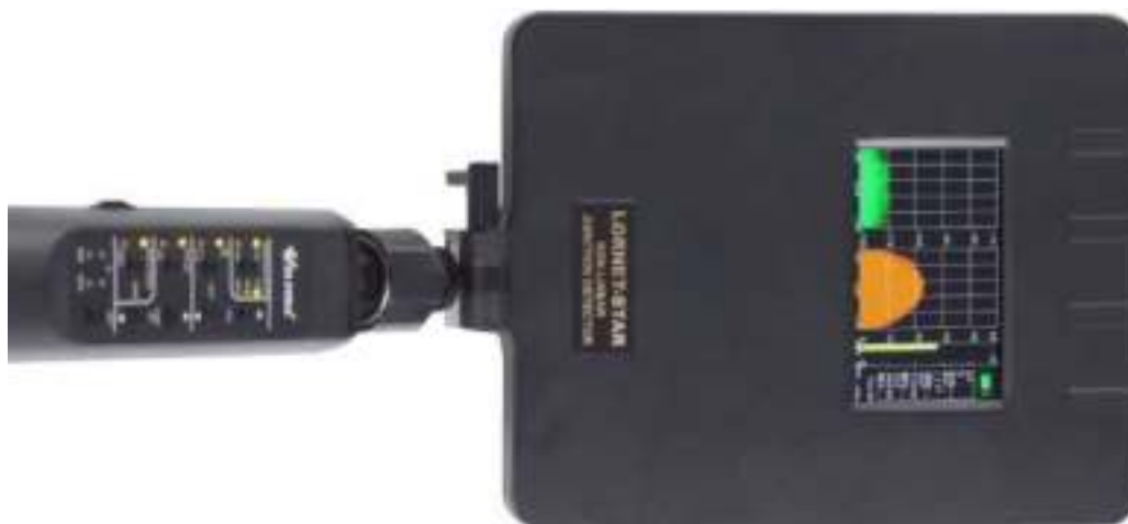
Рис. 5.145. Нелинейный лоатор «Лорнет Стар», использующийся в качестве компактного досмотрового прибора (без телескопической штанги)
