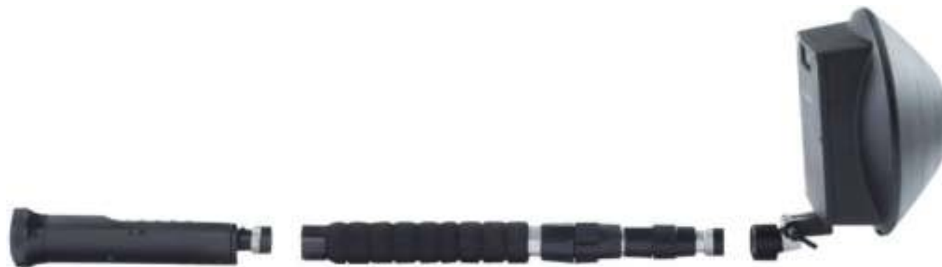
Рис. 5.144. Использование нелинейного локатора «Лорнет Стар» в качестве поискового прибора (с телескопической штангой)
