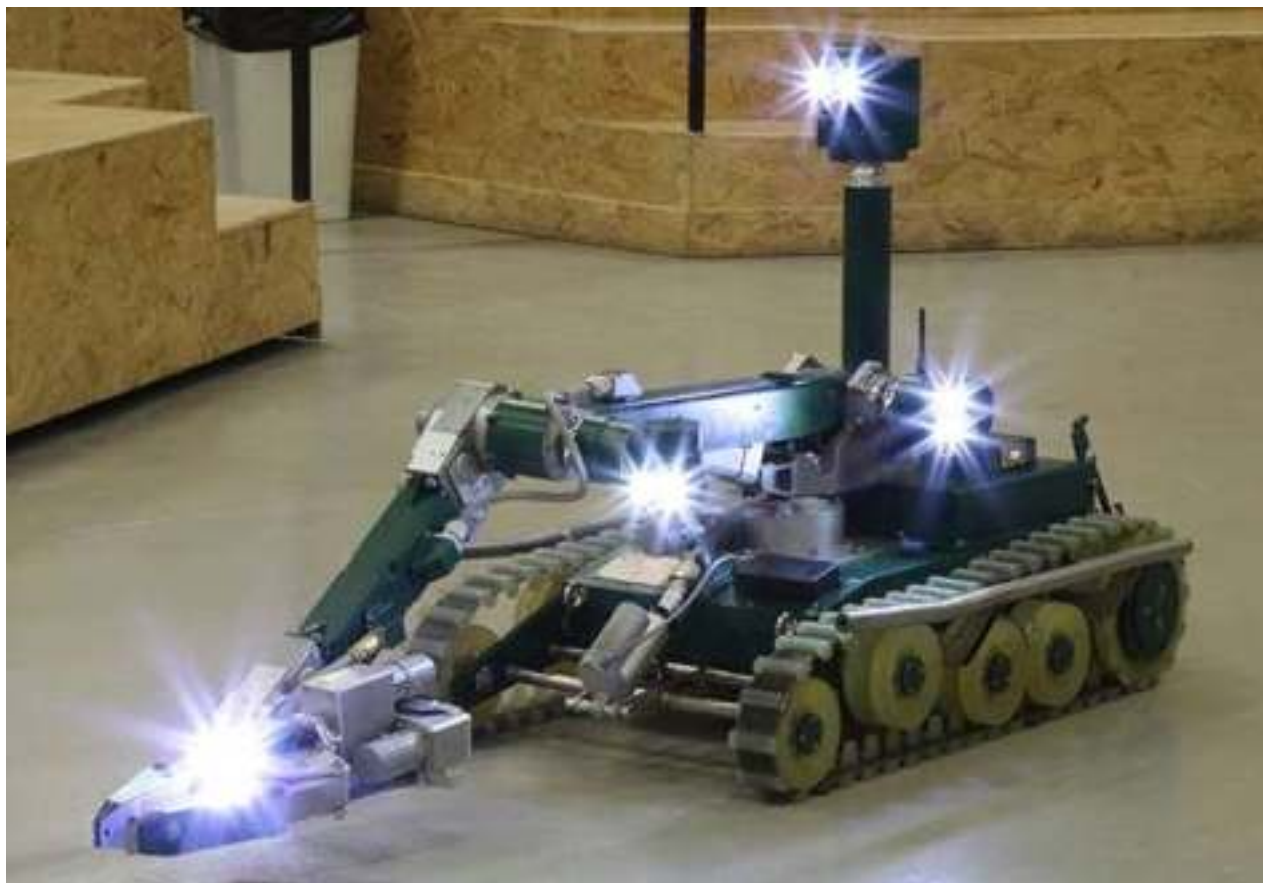
Рис. 5.206. Модернизированный МРК-15 с вытянутым манипулятором и включенной системой освещения
