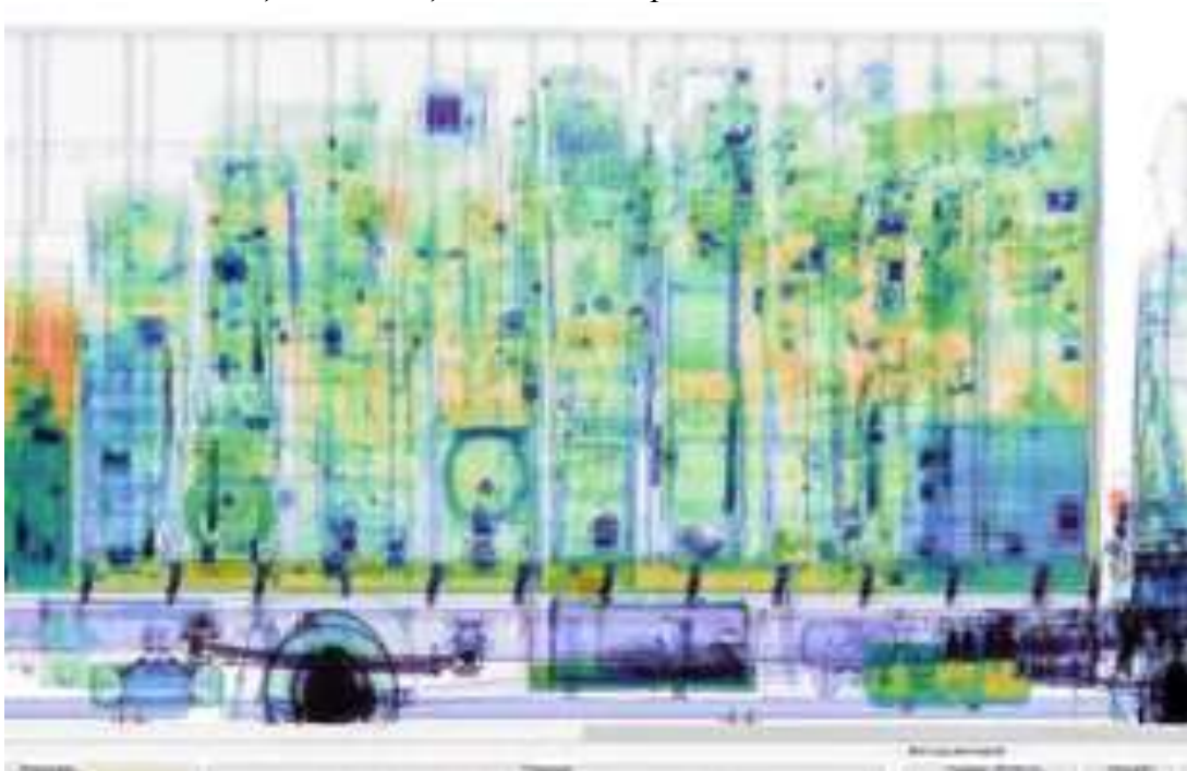
Рис. 5.108. Изображение с высоким разрешением, полученное с помощью инспекционно-досмотрового комплекса СТ-6035
