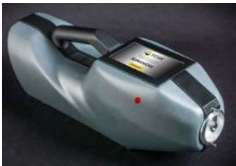
Рис. 5.70. Детектор взрывчатых веществ со встроенным поисковым радиометром «Дианон»
