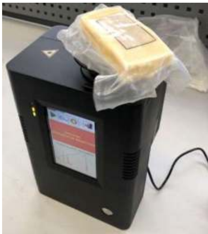
Рис. 5.64. Идентификация взрывчатого вещества (гексоген) через герметичную упаковку
