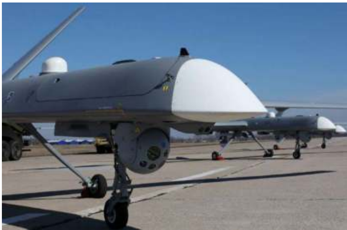
Рис. 5.303. Многофункциональная оптико-электронная система на борту БПЛА «Орион-Э»
