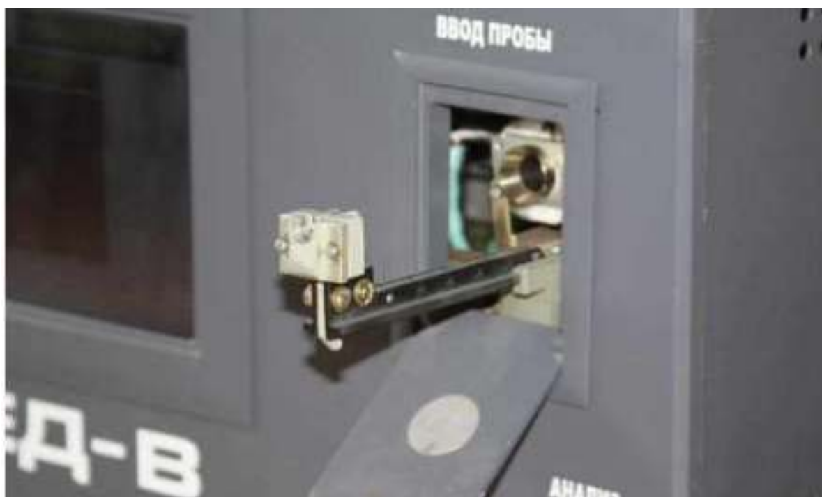
Рис. 5.49. Устройство ввода пробы (каретка в выдвинутом состоянии)
