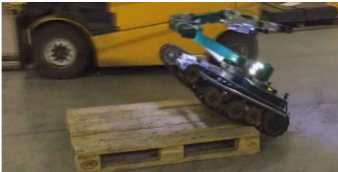
Рис. 5.213. Преодоление порогового препятствия высотой до 150 мм
