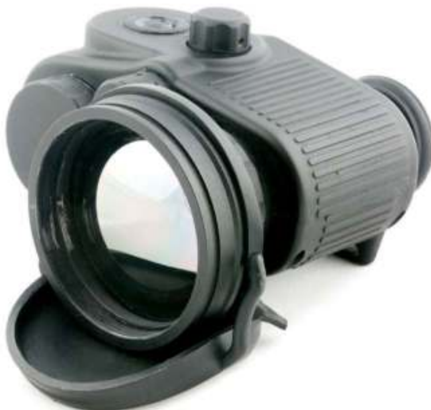
Рис. 6.78. Портативный тепловизор «СЫЧ-3 ПС» (вид со стороны объектива)
