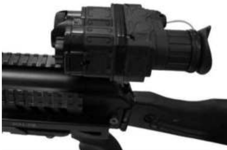
Рис. 6.76. Пример установки тепловизионного прибора «КАТРАН-М» на оружие
