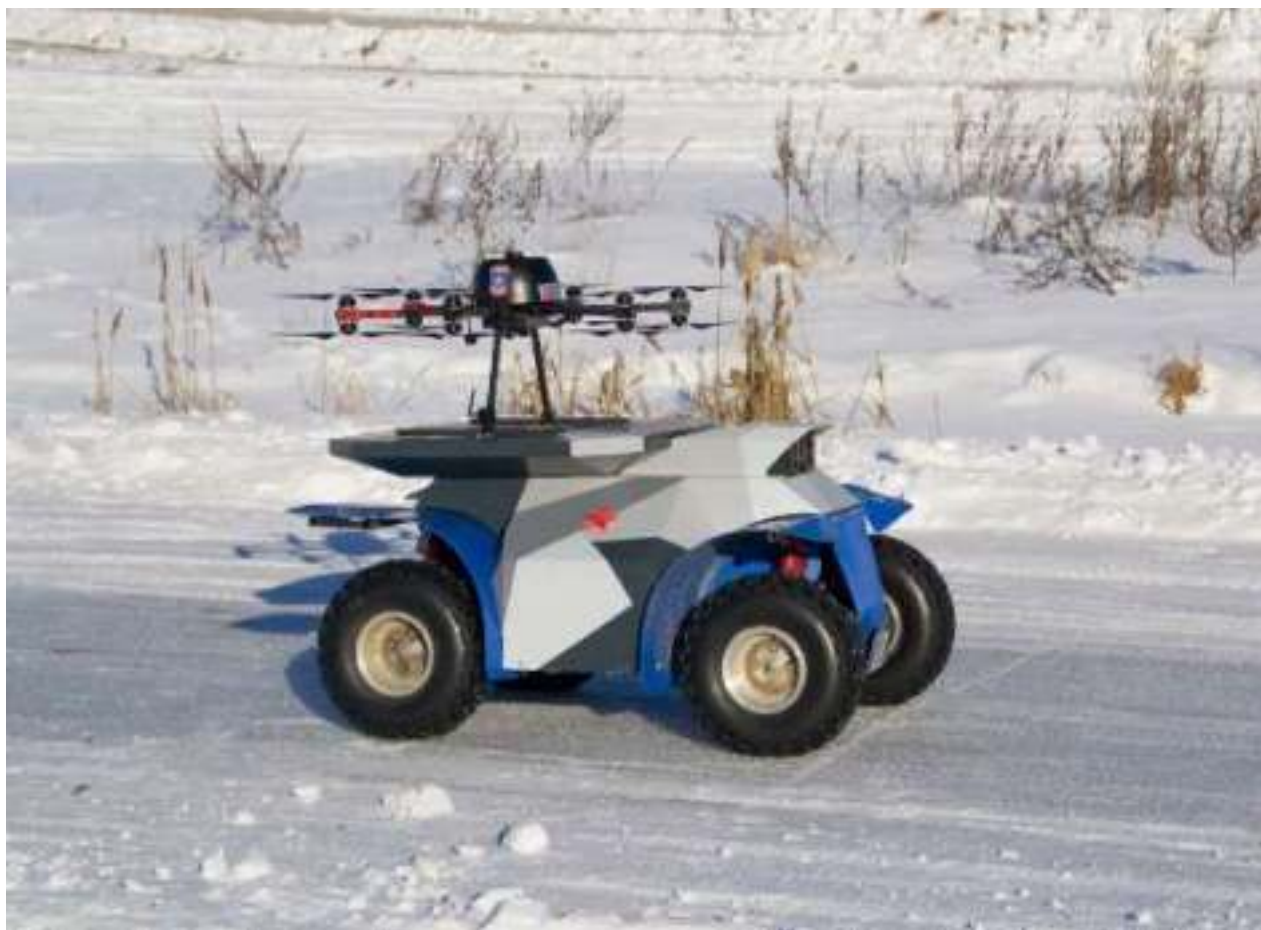
Рис. 5.320. Заряд аккумуляторных батарей мультикоптера от энергетической установки наземного робота
