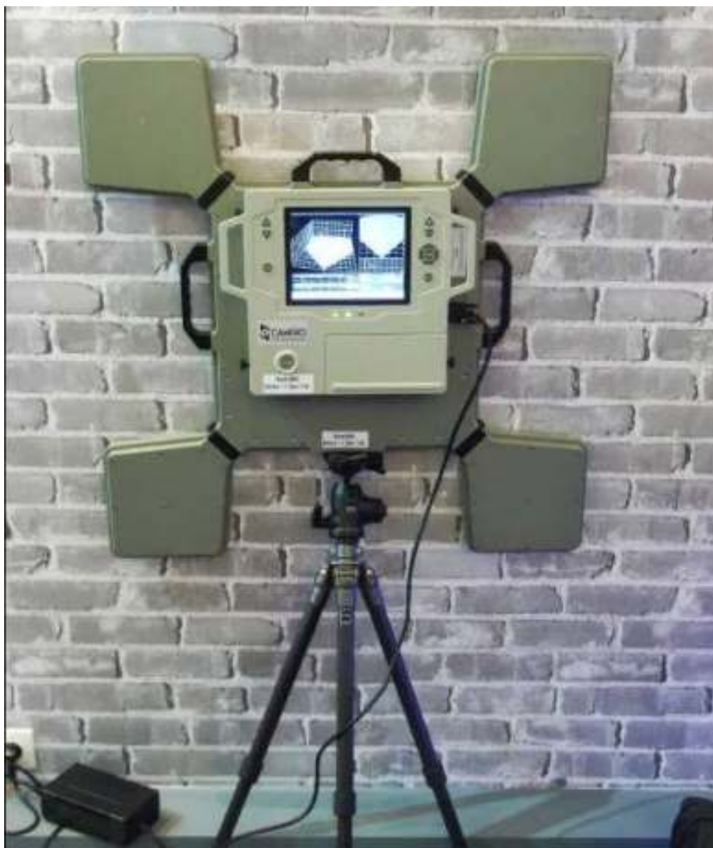
Рис. 5.163. Портативный стеновизор «Xaver-800» в рабочем положении на треноге. На экране показана трехмерная модель помещения за стеной
