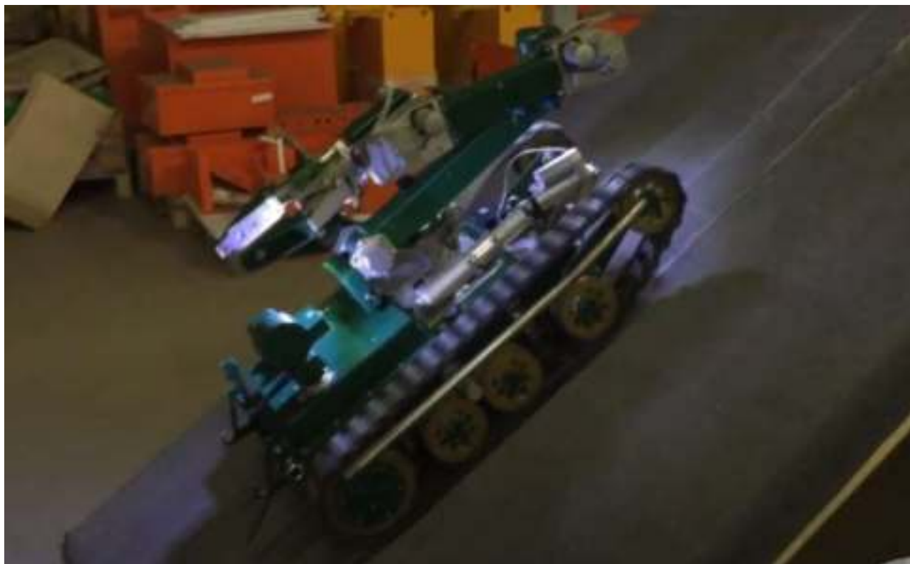
Рис. 5.215. Преодоление косогора по курсу не более 25°
