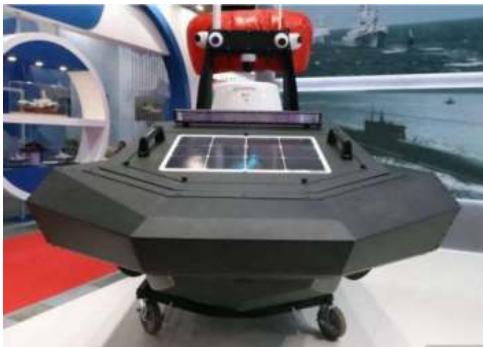
Рис. 5.300. Модуль полезной нагрузки в носовой части «Кибербоат-330»
