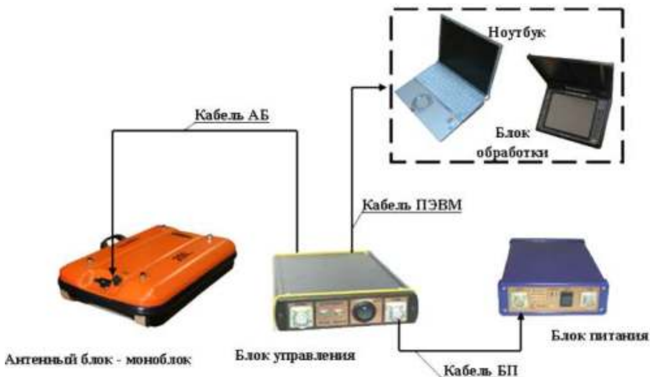
Рис. 5.203. Функциональная схема георадара с универсальным базовым комплектом и антенным блоком АБ-250М
