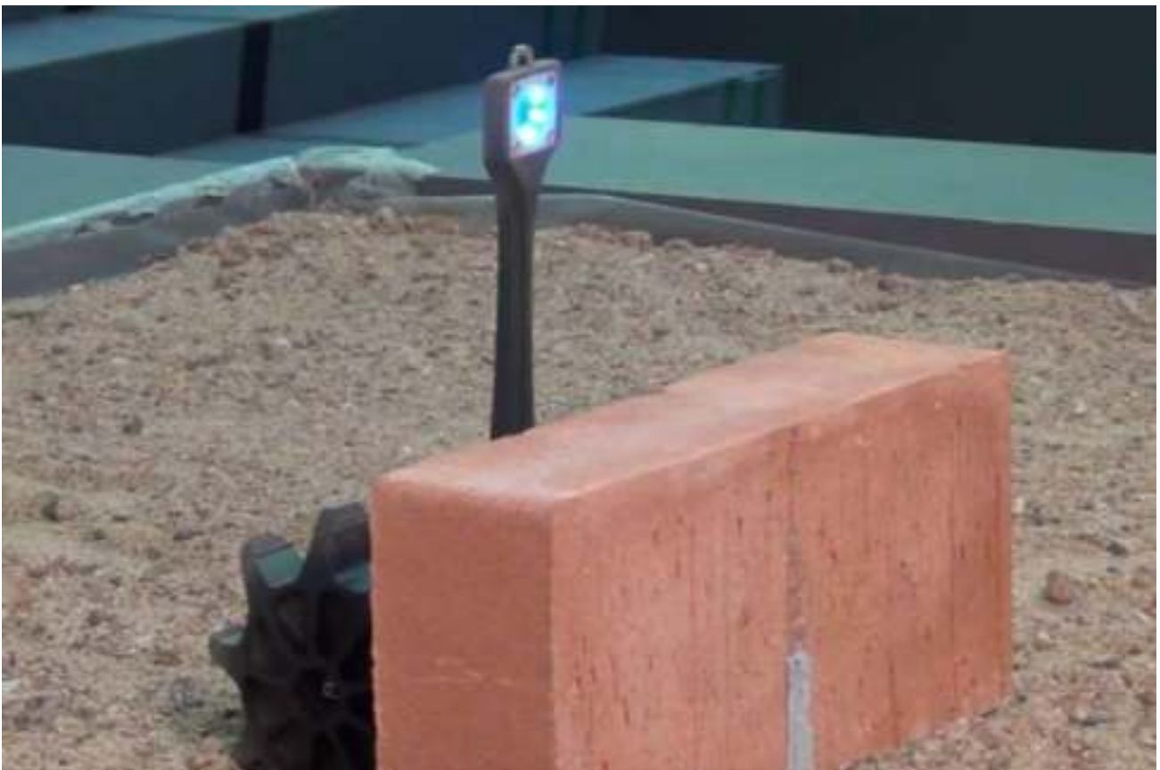
Рис. 5.268. Робот «Юла-2» ведёт аудиовизуальную разведку из-за преграды
