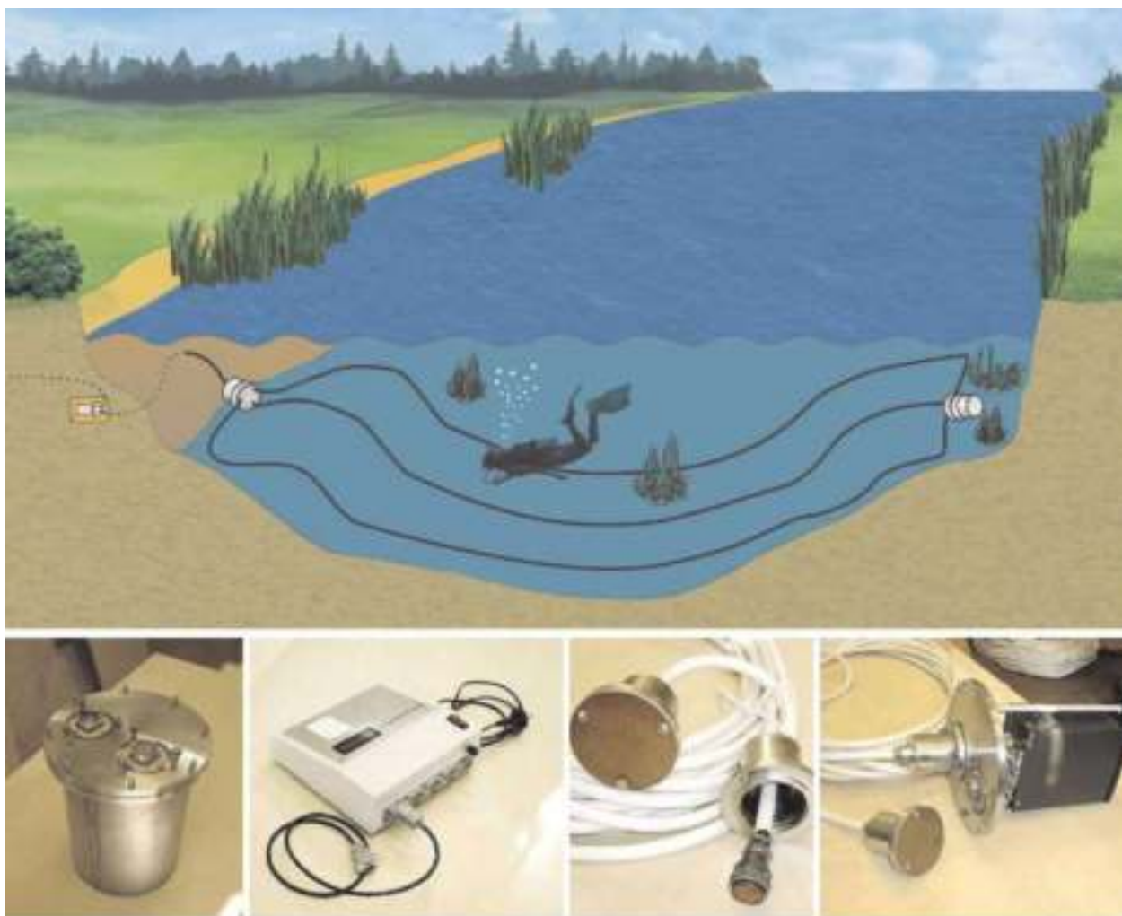
Рис. 5.100. Элементы магнитометрического средства «НЕПТУН» и тактика его применения
