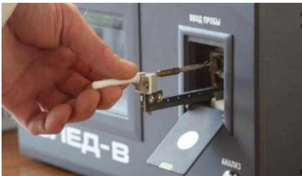
Рис. 5.50. Установка пробоотборного элемента в устройство ввода пробы
