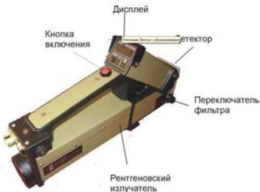
Рис. 5.134. Основные конструктивные элементы рентгеновского сканера скрытых полостей «Ватсон»
