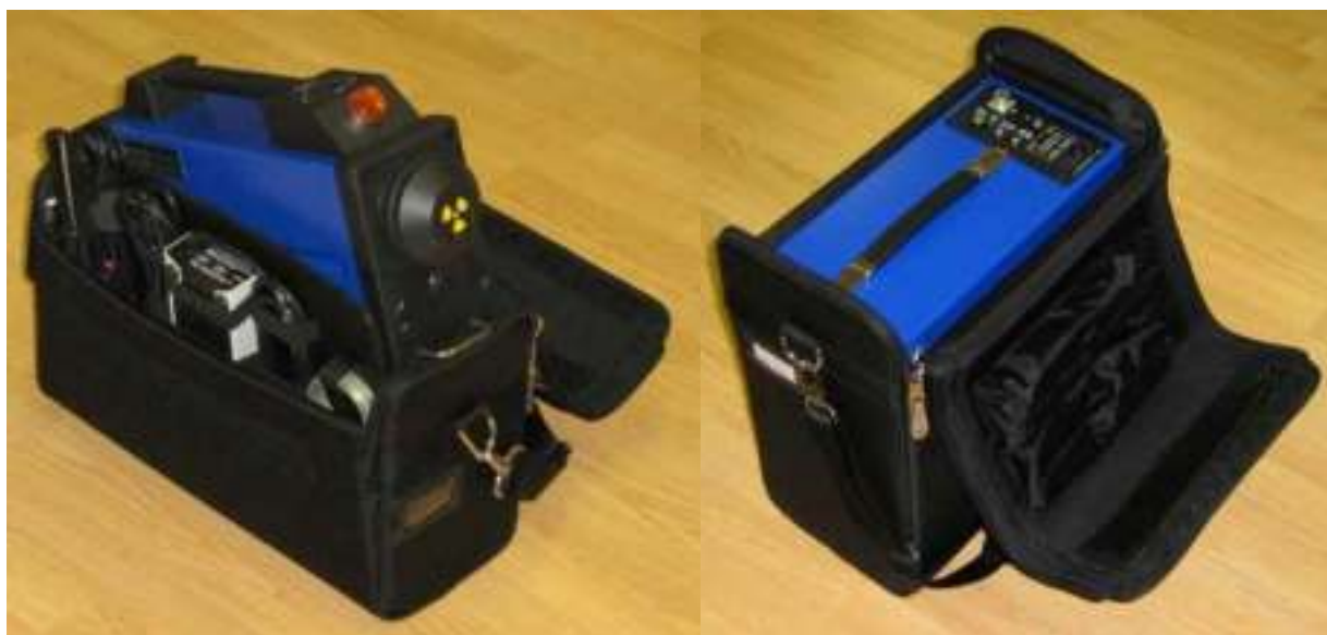
Рис. 5.123. Рентгеновский аппарат и рентгенооптический преобразователь рентгенотелевизионной установки «Шмель-240ТВ»
