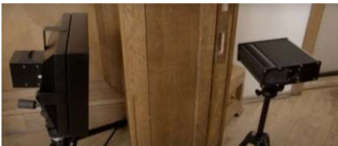
Рис. 5.117. Пример использования рентгентелевизионной установки «Норка» для выявления устройств съема информации
