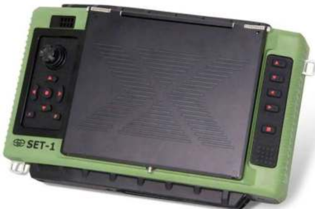
Рис. 5.259. Пульт видеонаблюдения и дистанционного управления (для устройства «СФЕРА») в сложенном состоянии
