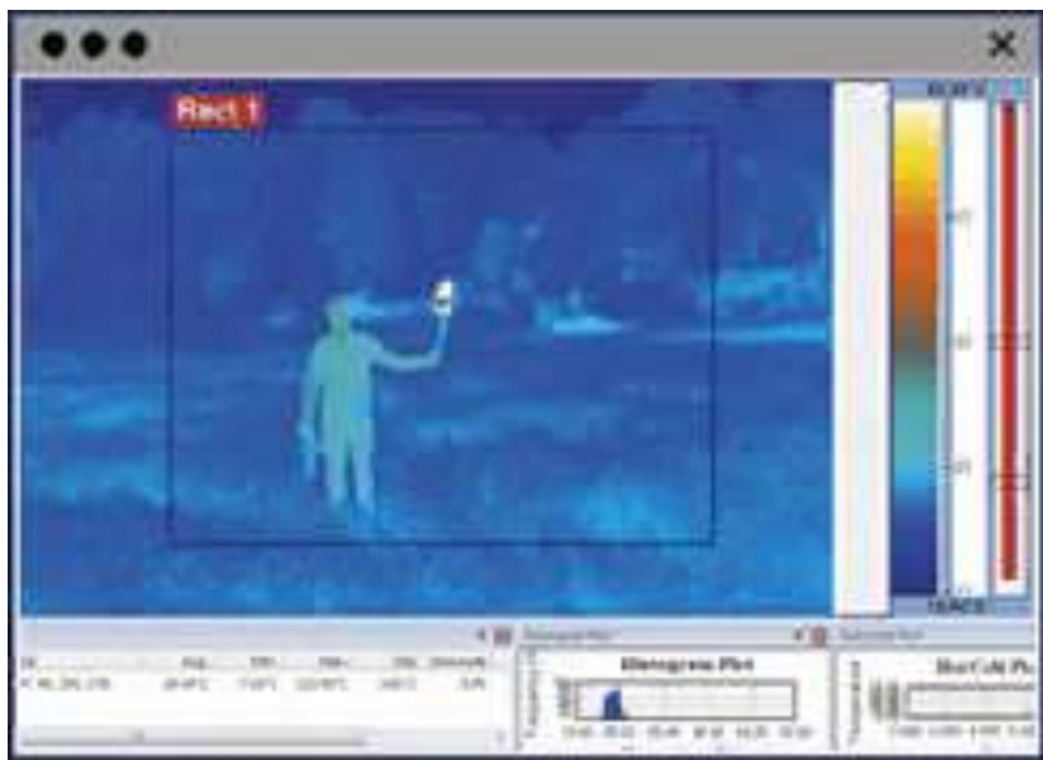
Рис. 6.103. Функция измерения температуры в заданной области с сигнализацией о превышении заданного порогового значения
