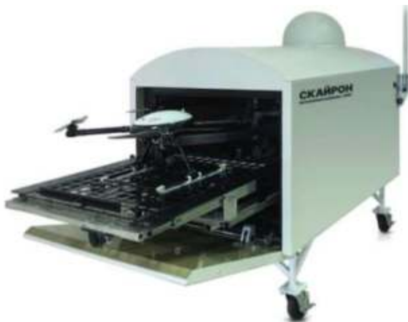
Рис. 5.312. Комплекс контроля прилегающей территории на основе беспилотного летательного аппарата «Скайрон СО»
