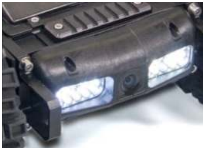
Рис. 5.20. Досмотровое устройство «Скарабей» с курсовой камерой
