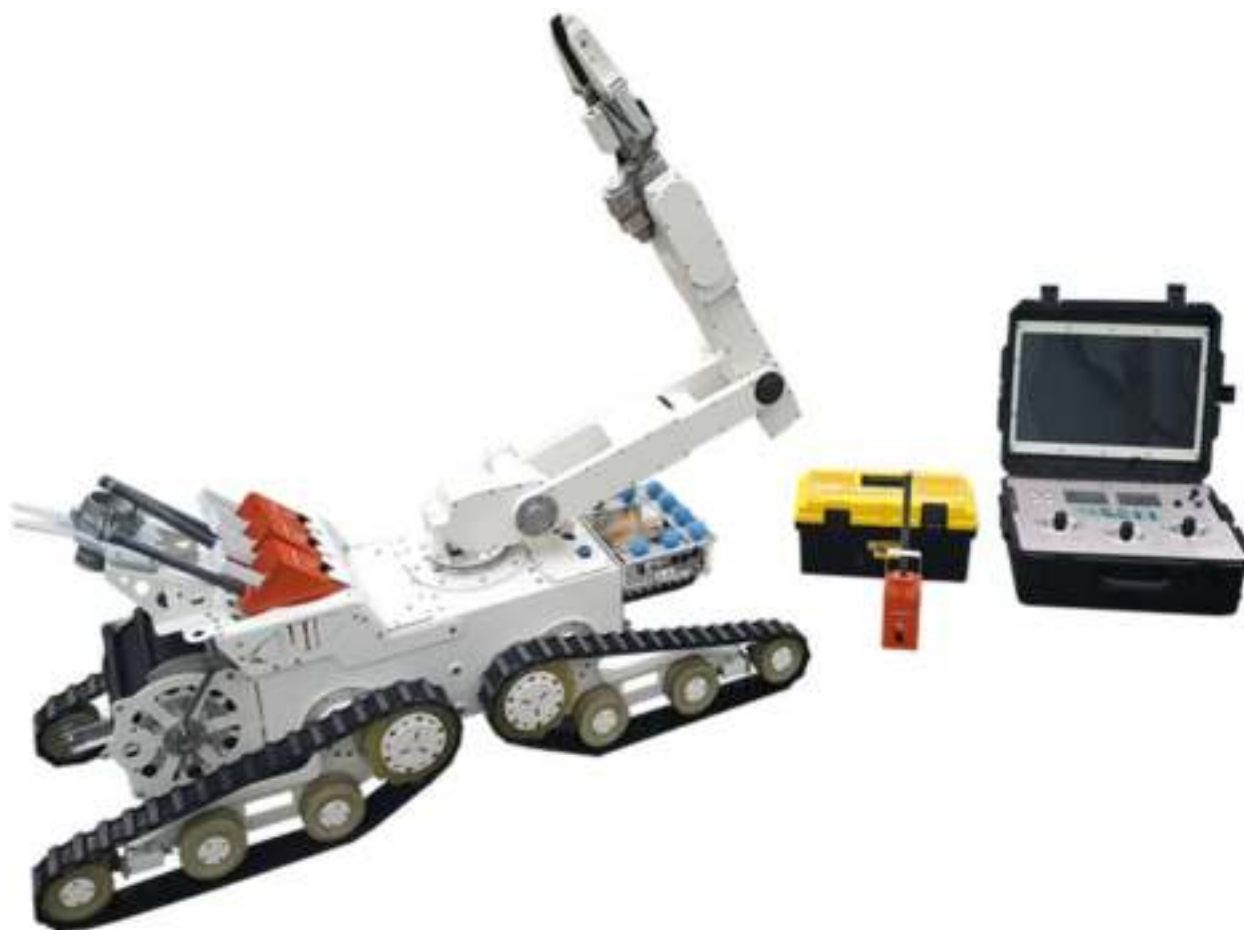
Рис. 5.227. Мобильный робототехнический комплекс МРК-100 «Паук» с пультом управления и вспомогательным оборудованием
