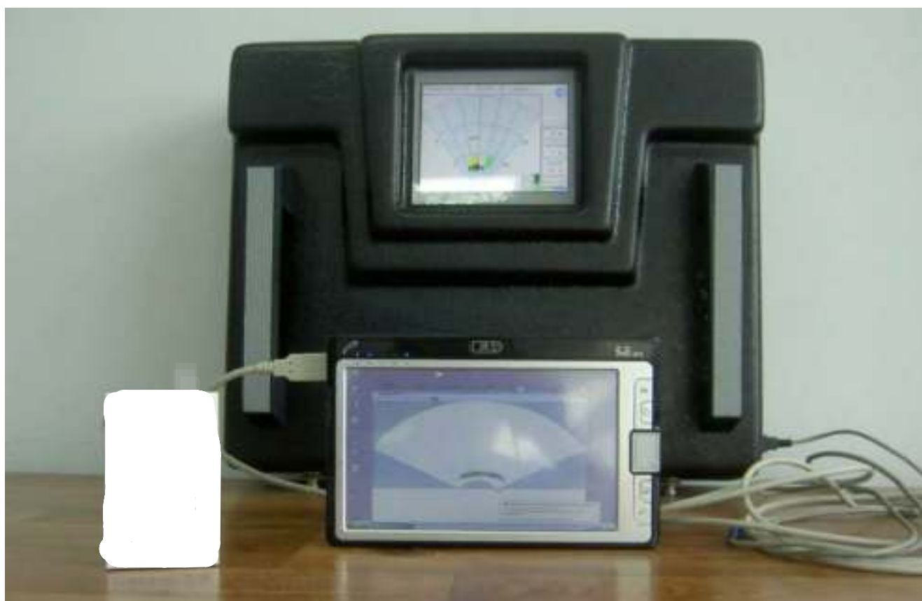
Рис. 5.198. Радиолокатор для обнаружения людей за стенами «Данник-5»
