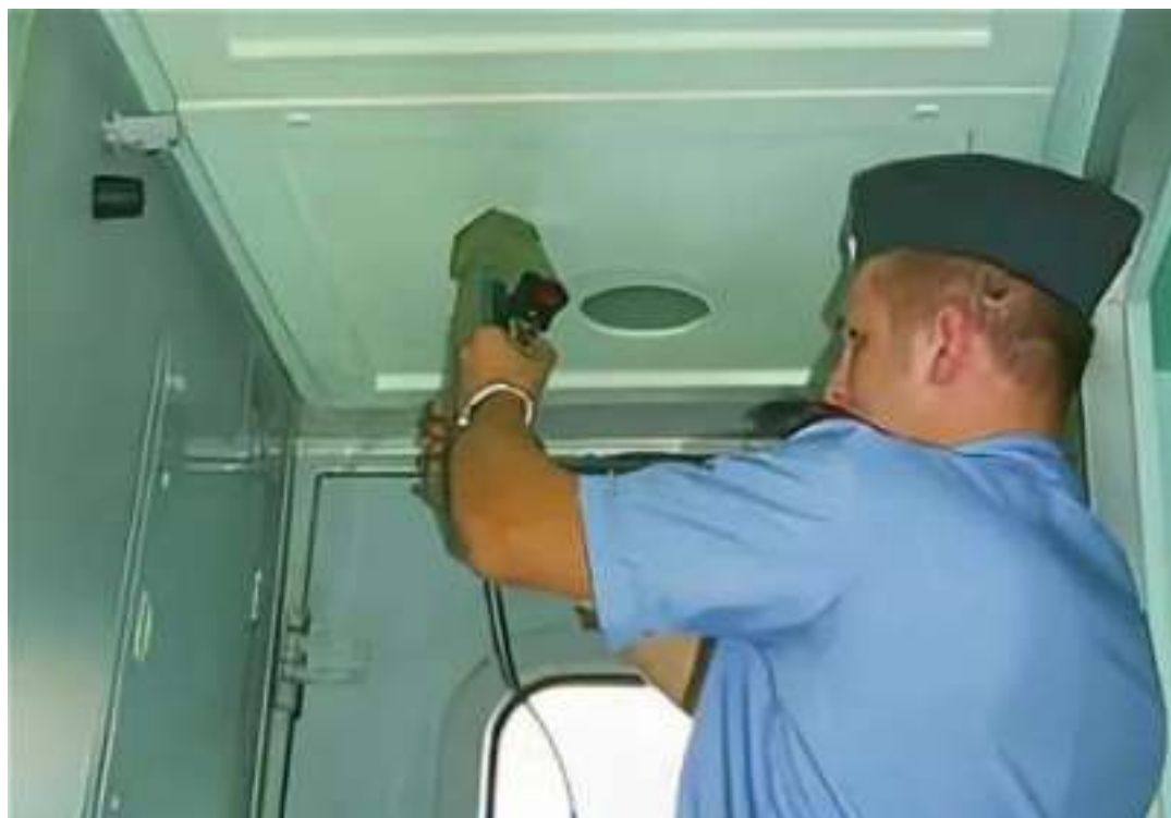
Рис. 5.137. Использование ручного рентгеновского сканера «Ватсон» для проведения досмотра полостей железнодорожного вагона
