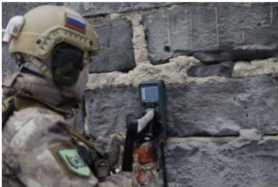
Рис. 5.180. Применение стеновизора РО-900 в режиме «радара-обнаружителя» в боевой обстановке
