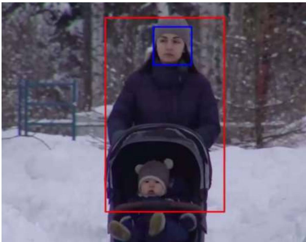
Рис. 5.284. Фрагмент видео с детекцией фигуры и лица человека роботом «Трал Патруль 5.2»
