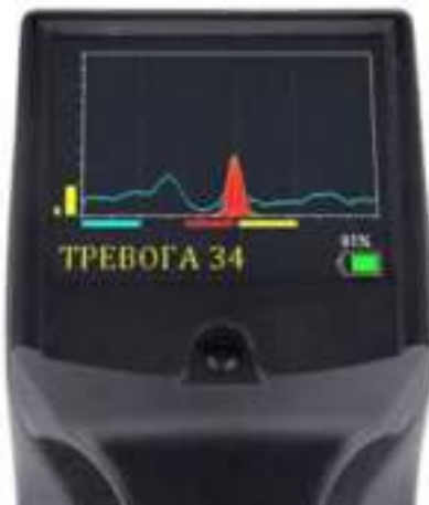
Рис. 5.67. Цветной графический дисплей портативного обнаружителя паров взрывчатых веществ «Пилот-М1 премиум»
