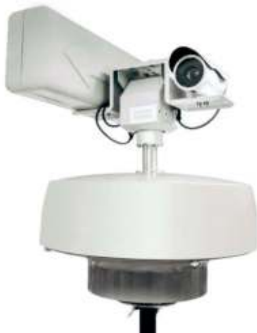
Рис. 6.166. РЛС «Енот» с видеокамерой и системой радиоэлектронного подавления на поворотной платформе
