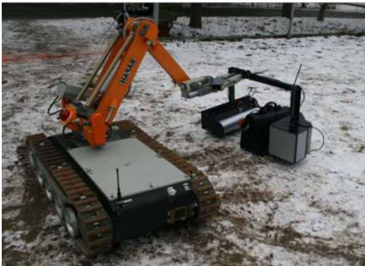
Рис. 5.222. Применение портативной рентгенотелевизионной установки «Шелест» в составе мобильного робототехнического комплекса «Варан»
