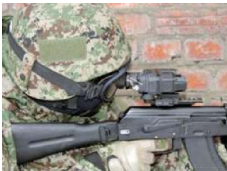
Рис. 6.77. Пример установки тепловизионного прибора «КАТРАН-М» на оружие
