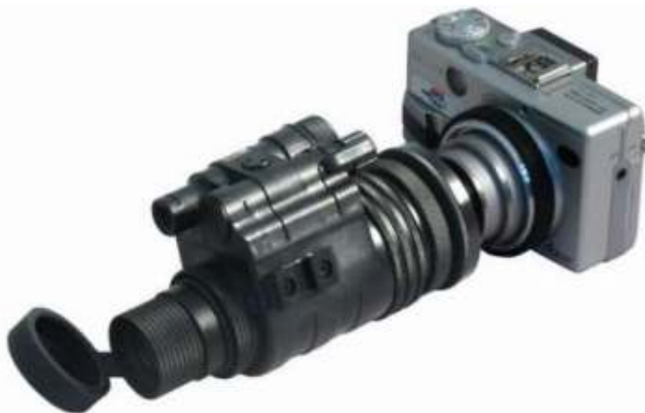
Рис. 6.30. Пример адаптации ПНВ Dedal-370-DK3/bw с фотоаппаратом
