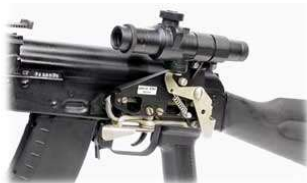
Рис. 6.39. ЦЛН-1К, установленный на автомате Калашникова
