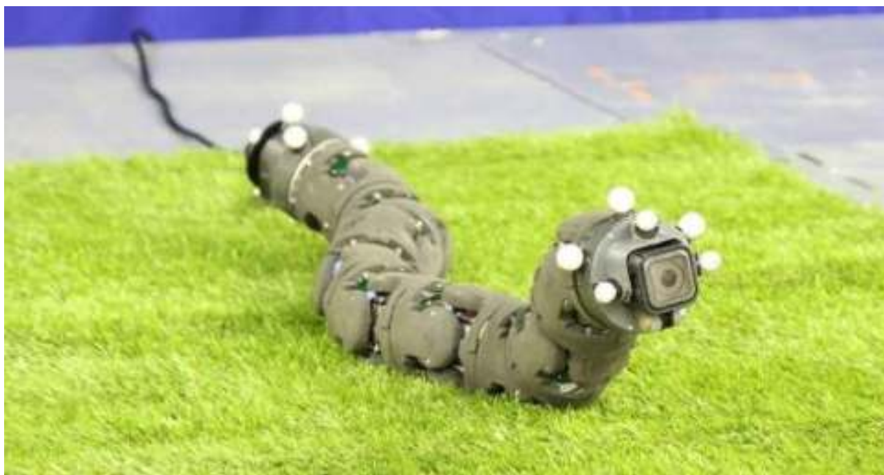
Рис. 5.279. Движение робота «Змеелок-3М» по прямой
