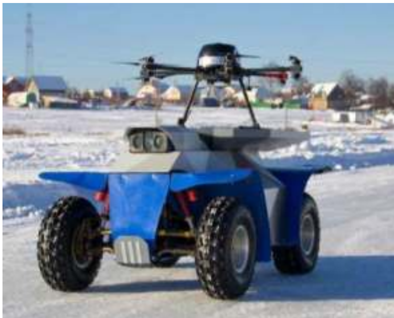
Рис. 5.317. Мобильный роботизированный комплекс наземно-воздушного наблюдения «Макс» на основе колёсного робота SRX 3
