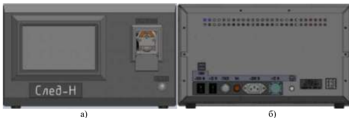
Рис. 5.54. Прибор обнаружения наркотических веществ «След-Н» а) — передняя панель прибора; б) — задняя панель прибора
