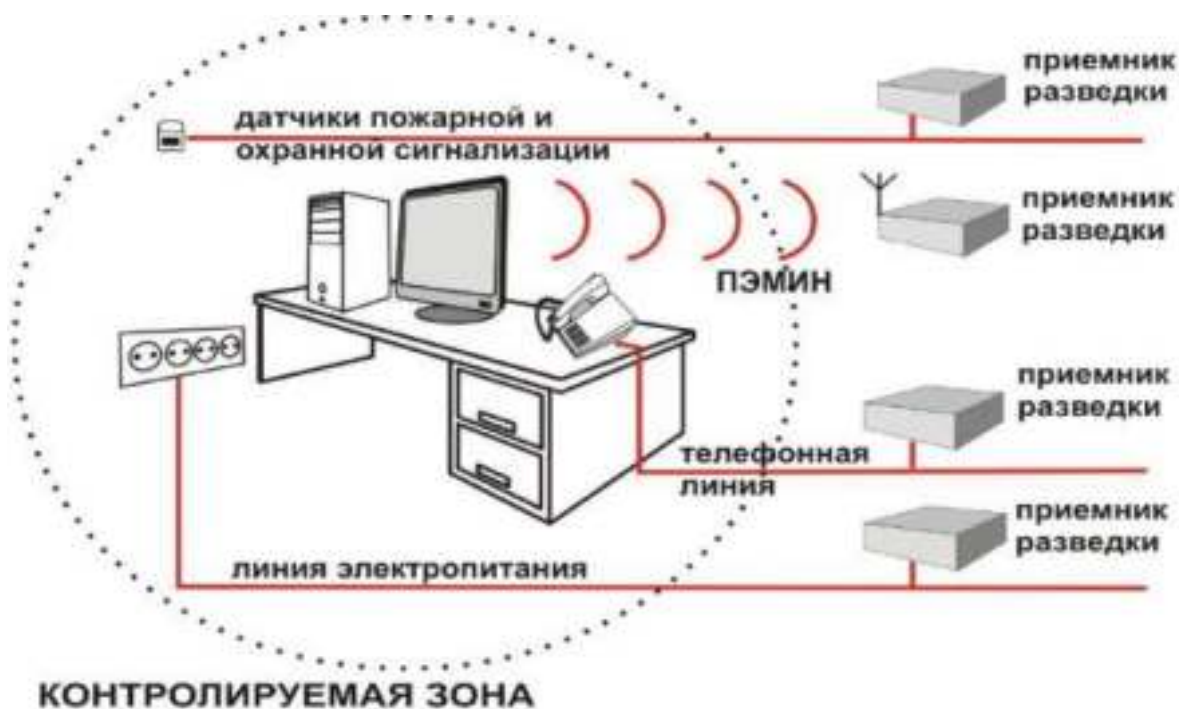
Рис. 7.3. Каналы утечки информации по проводным линиям
