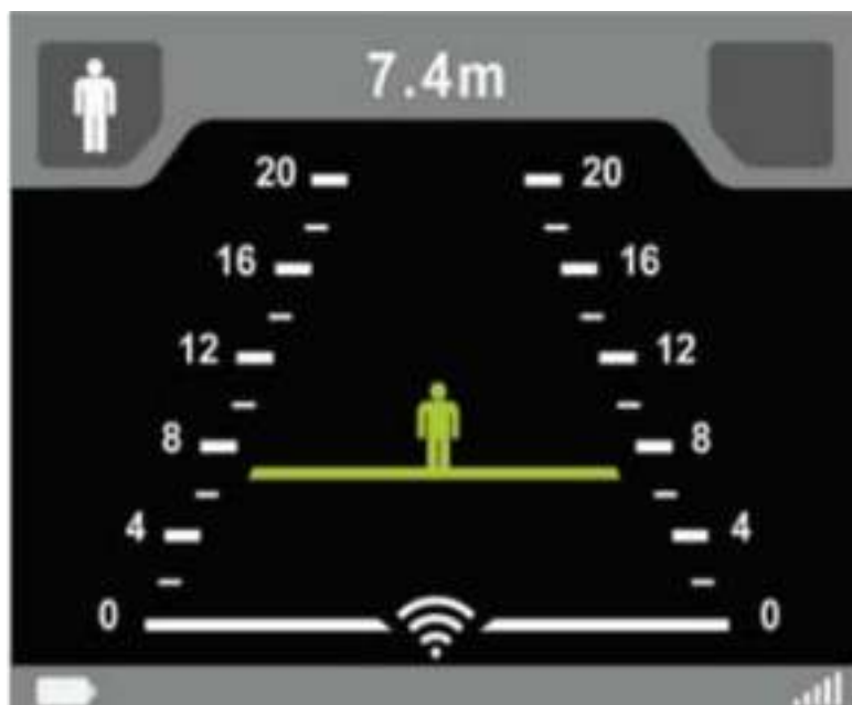
Рис. 5.147. Пример отображения результатов обнаружения живого объекта на экране стеновизора «Xaver-100»
