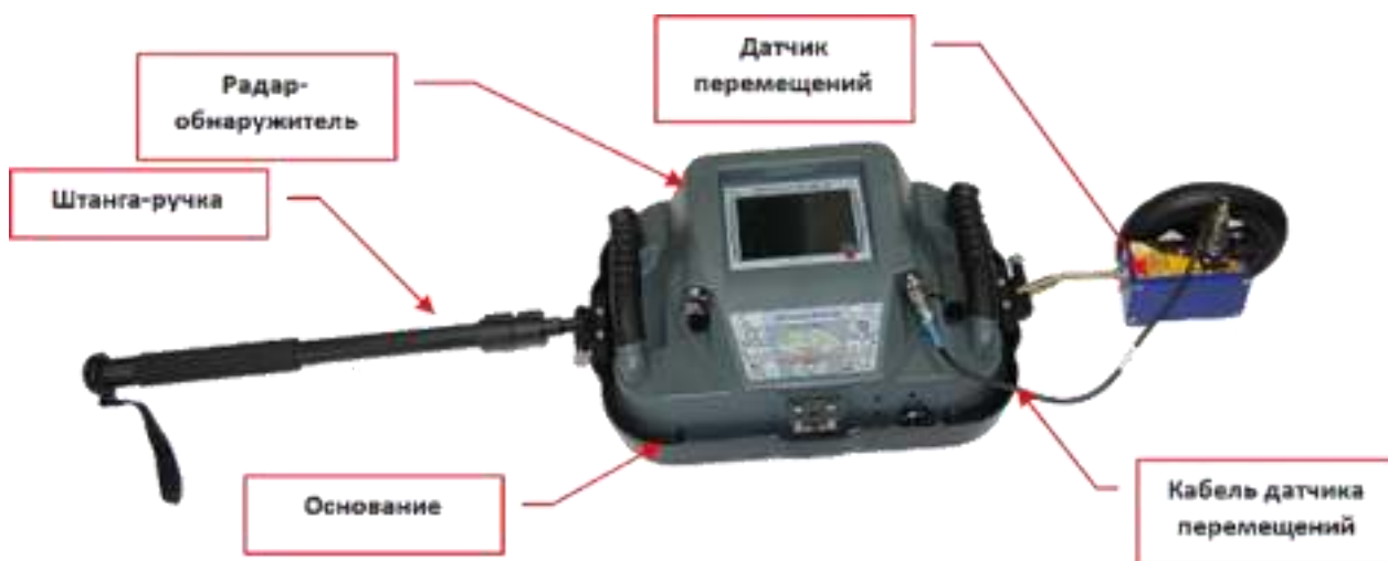
Рис. 5.195. Конфигурация элементов РО-400/2D, необходимых для проведения зондирования в режиме поискового георадара
