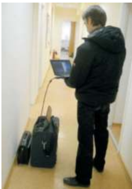
Рис. 5.130. Исследование содержимого портфеля, оставленного у стены, с помощью рентгеновского устройства досмотра полостей «Феникс»
