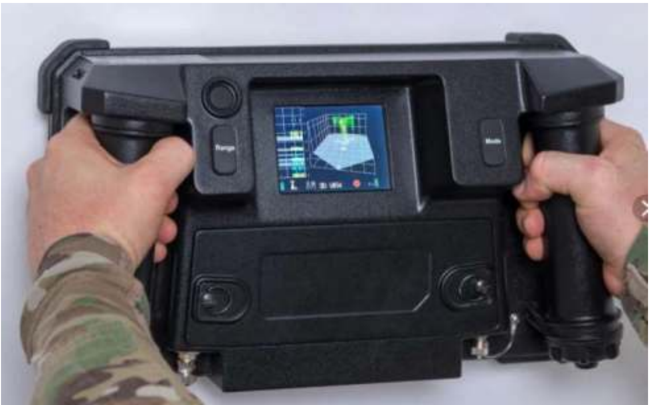
Рис. 5.155. Стеновизор «Xaver-400» в режиме трехмерного изображения
