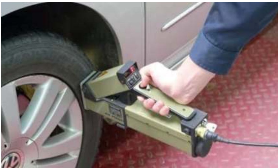
Рис. 5.135. Использование ручного рентгеновского сканера «Ватсон» для проведения досмотра колеса
