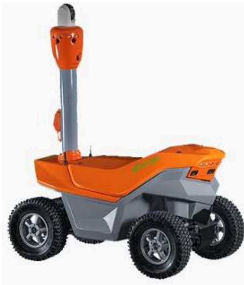
Рис. 5.283. Охранный робот 5-го поколения с интеллектуальной системой видеонаблюдения «Трал Патруль 5.2»
