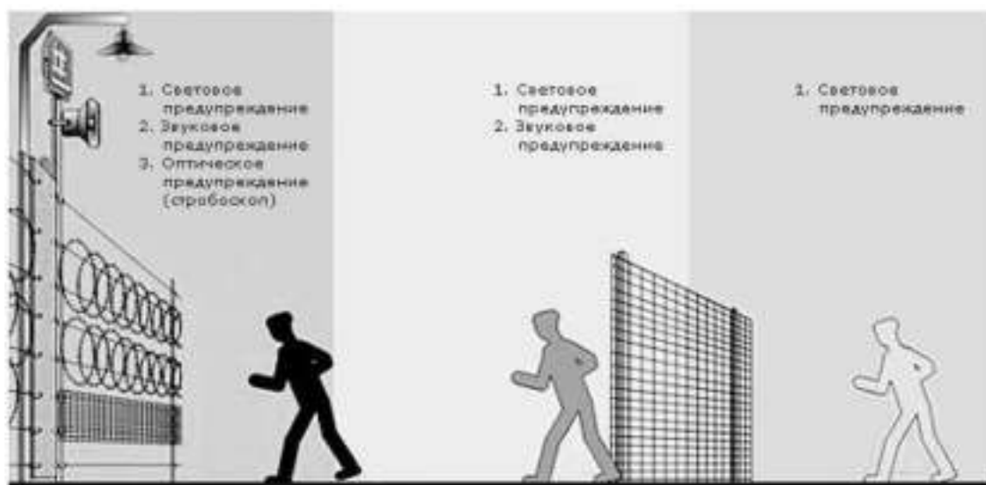
Рис. 7.7. Принцип предотвращения доступа на объект с использованием комплекса средств
