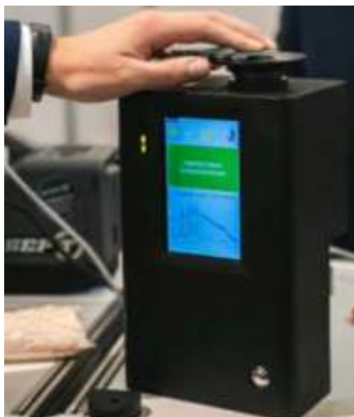
Рис. 5.63. Спектрометр «ХимЭксперт-Т» идентифицировал парацетамол сквозь герметичную упаковку
