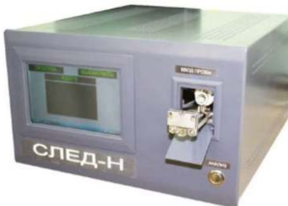
Рис. 5.55. Прибор обнаружения наркотических веществ «След-Н» с открытым устройством ввода пробы
