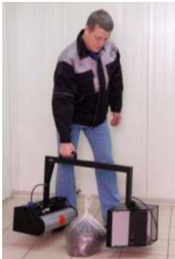
Рис. 5.224. Применение портативной рентгенотелевизионной установки «Шелест» в ручном исполнении
