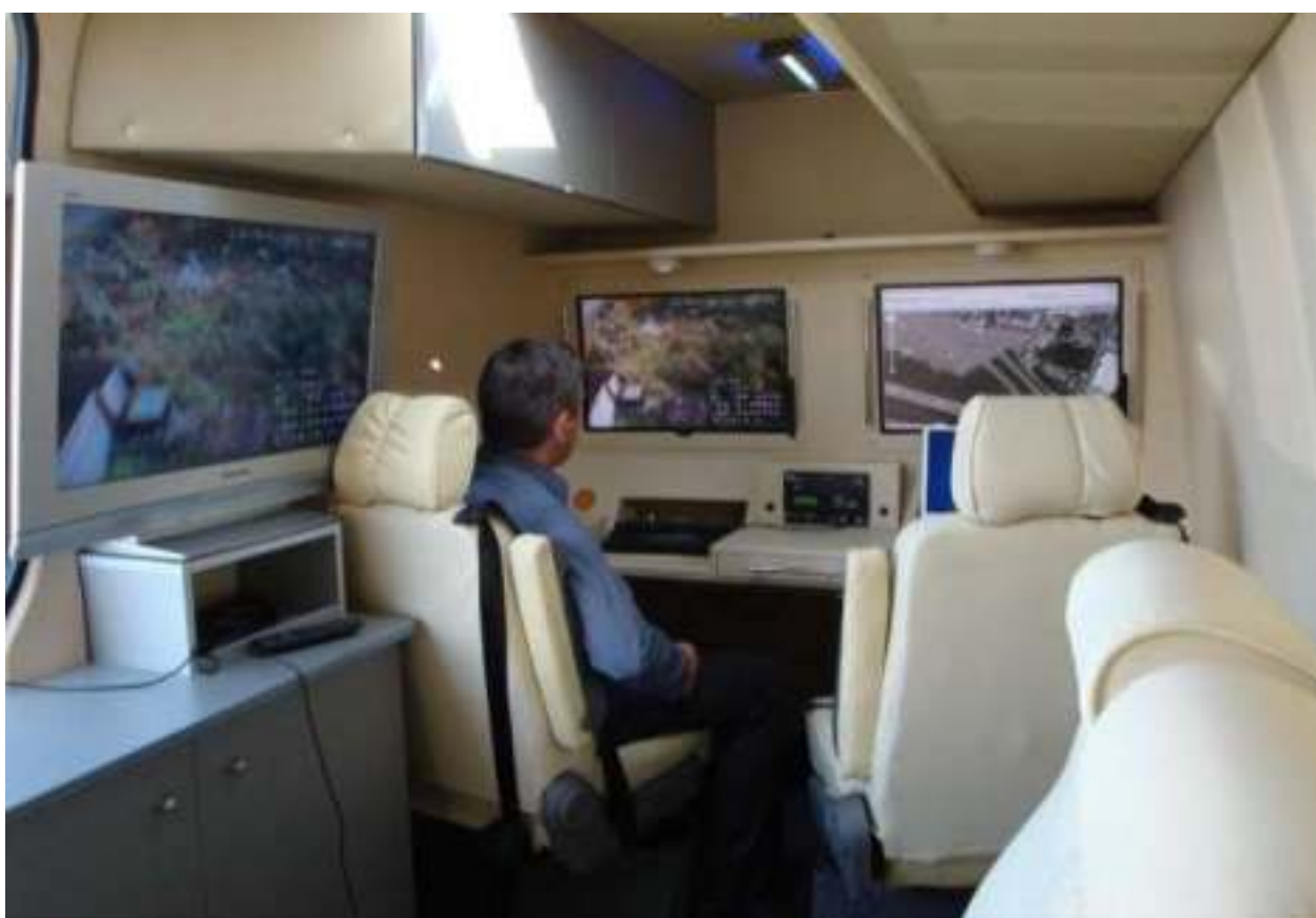
Рис. 5.333. Пункт управления привязного аэростатного комплекса «Пересвет»
