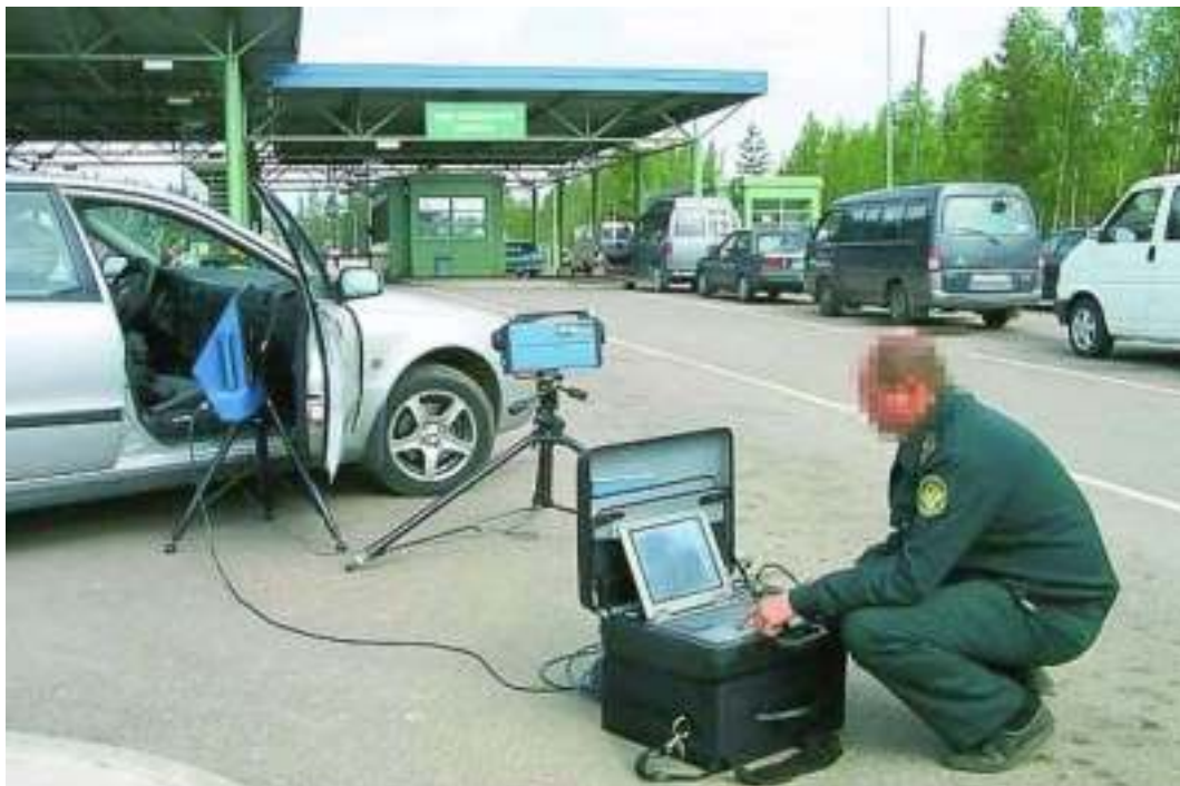
Рис. 5.125. Использование рентгентелевизионной установки «Шмель-240ТВ» для досмотра транспортных средств
