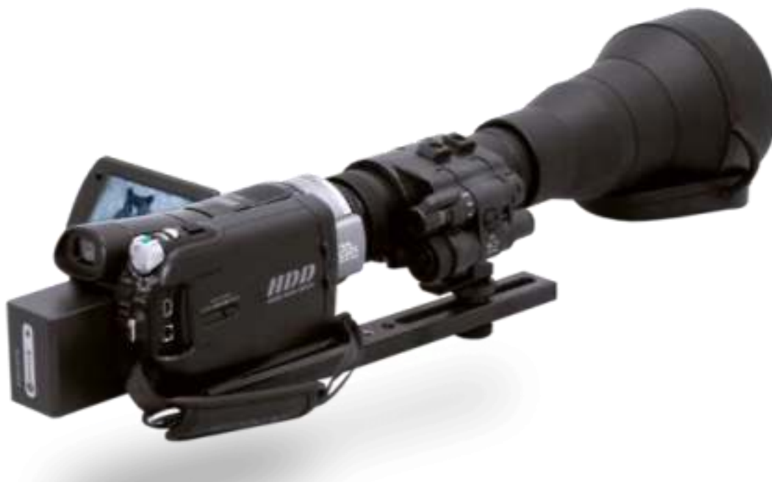
Рис. 6.31. Схема установки монокуляра ночного видения Dedal-370-DK3/b, оснащенного сменным светосильным объективом, на объектив видеокамеры
