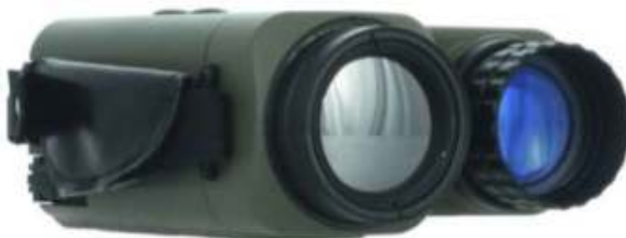
Рис. 6.120. Портативный комбинированный тепловизионно-ночной наблюдательный прибор «ТНК-5» (вид со стороны объективов)
