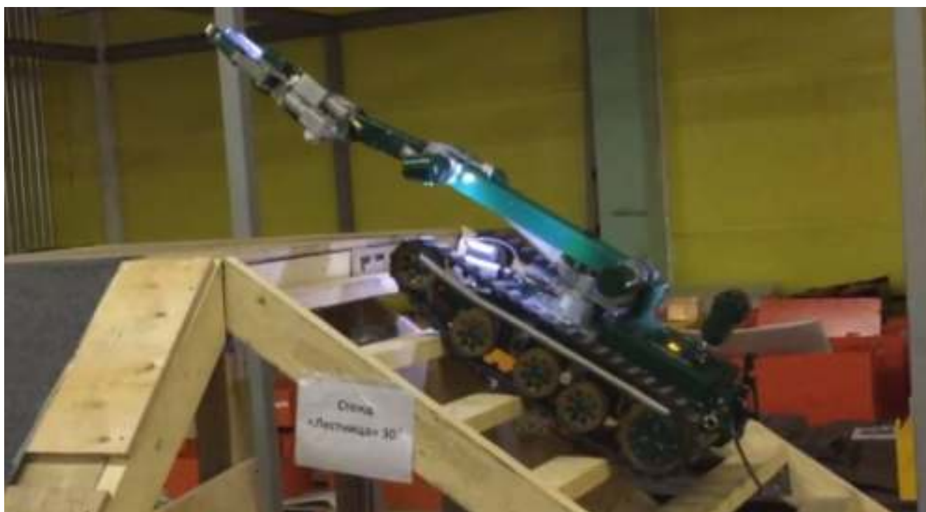
Рис. 5.214. Преодоление лестницы с углом наклона не более 25^\circ и шириной ступени не более 300 мм.
