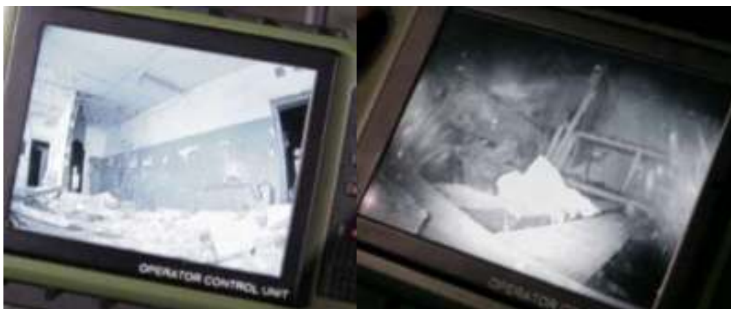
Рис. 5.29. Приём и отображение видеоинформации, передаваемой по радиоканалу от управляемого досмотрового устройства «Скарабей»
