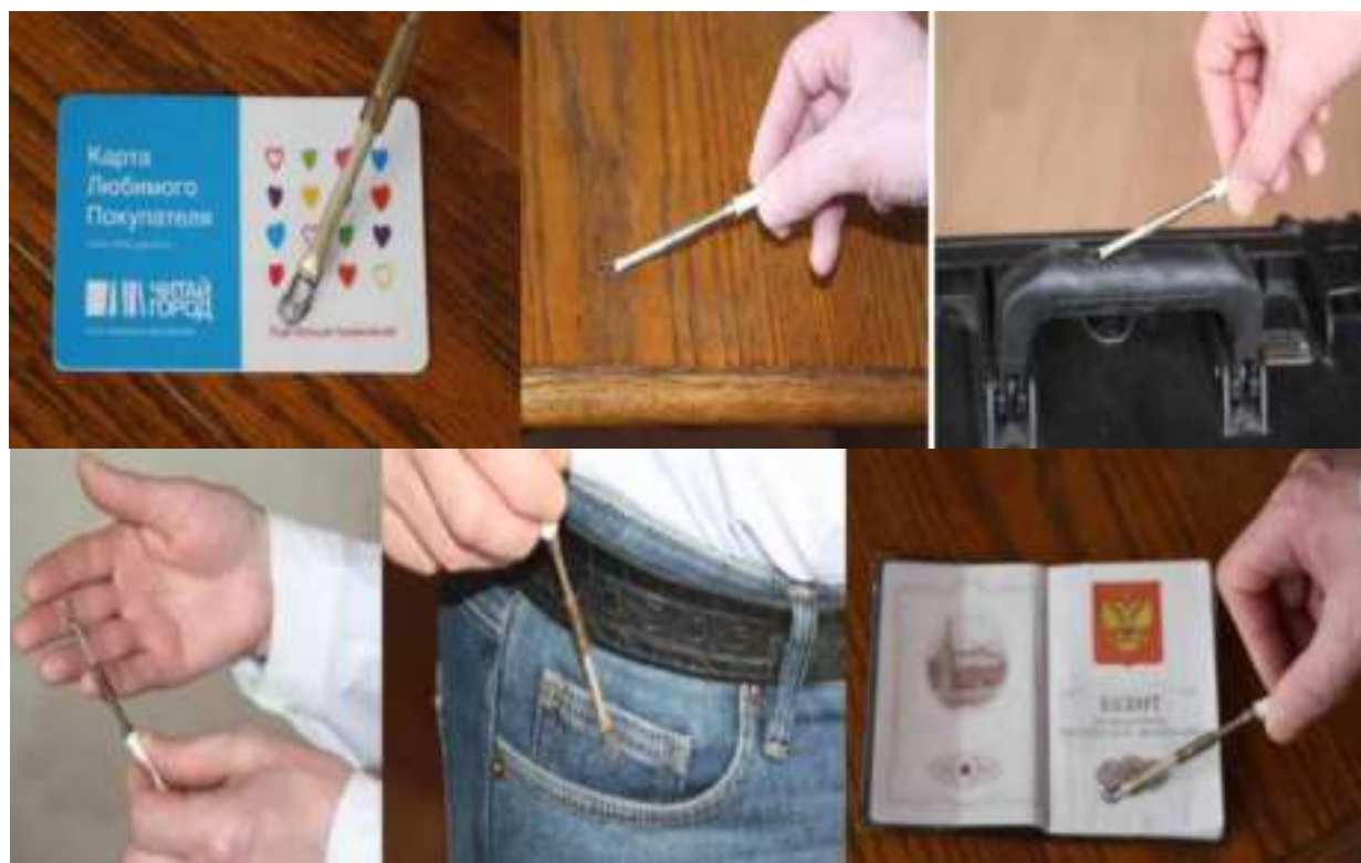
Рис. 5.47. Отбор проб с различных поверхностей
