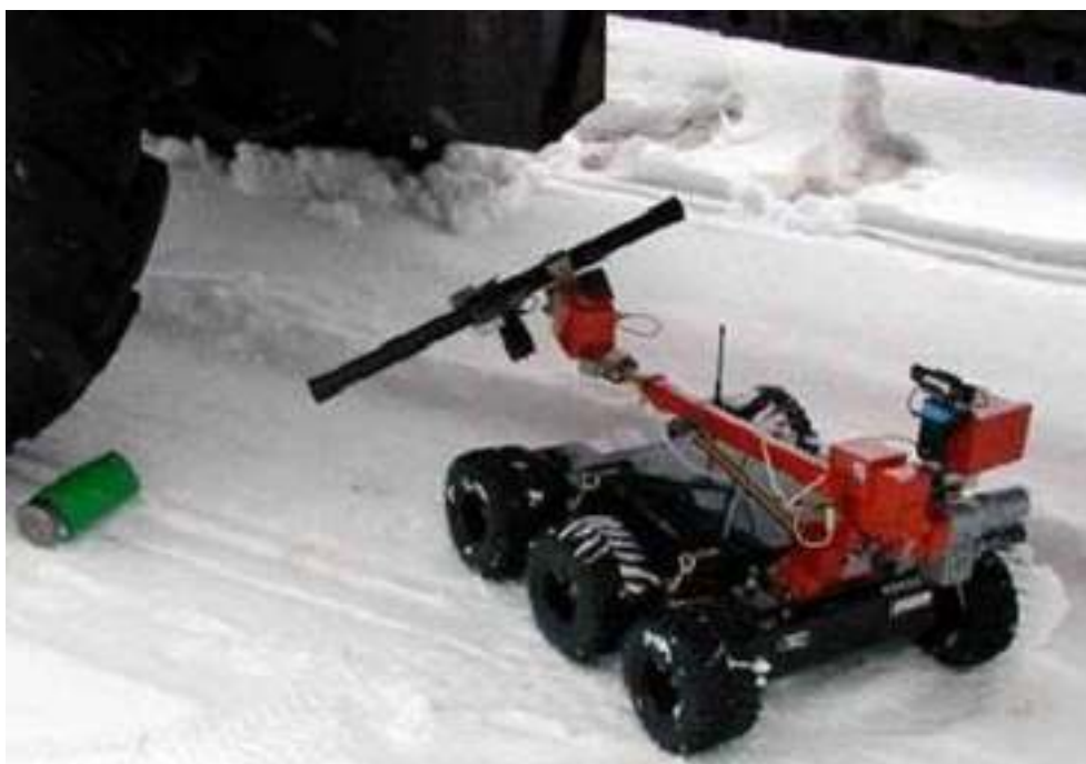
Рис. 5.231. Уничтожение подозрительного предмета с помощью гидроразрушителя
