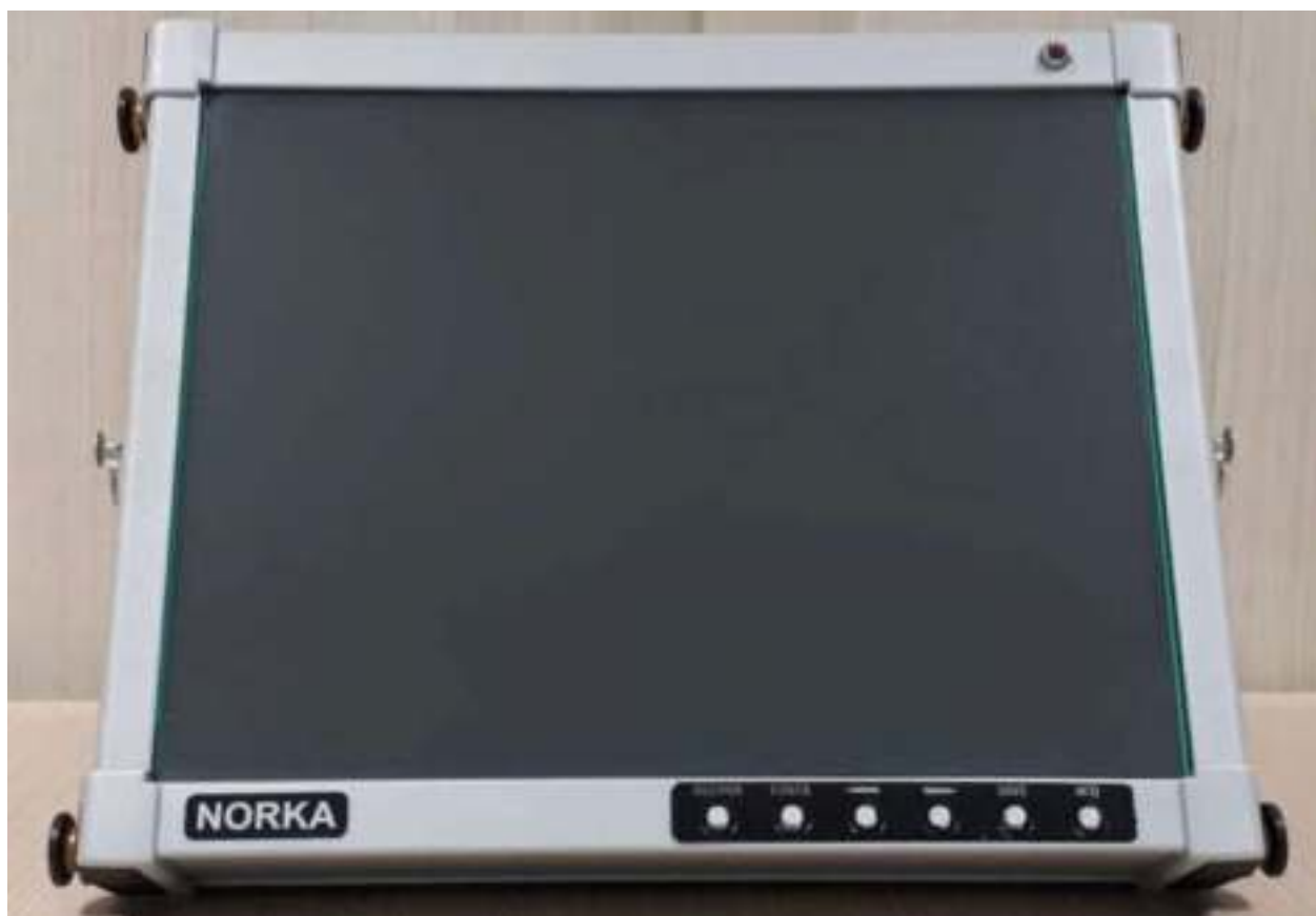
Рис. 5.120. Блок управления рентгентелевизионного комплекса «Норка»
