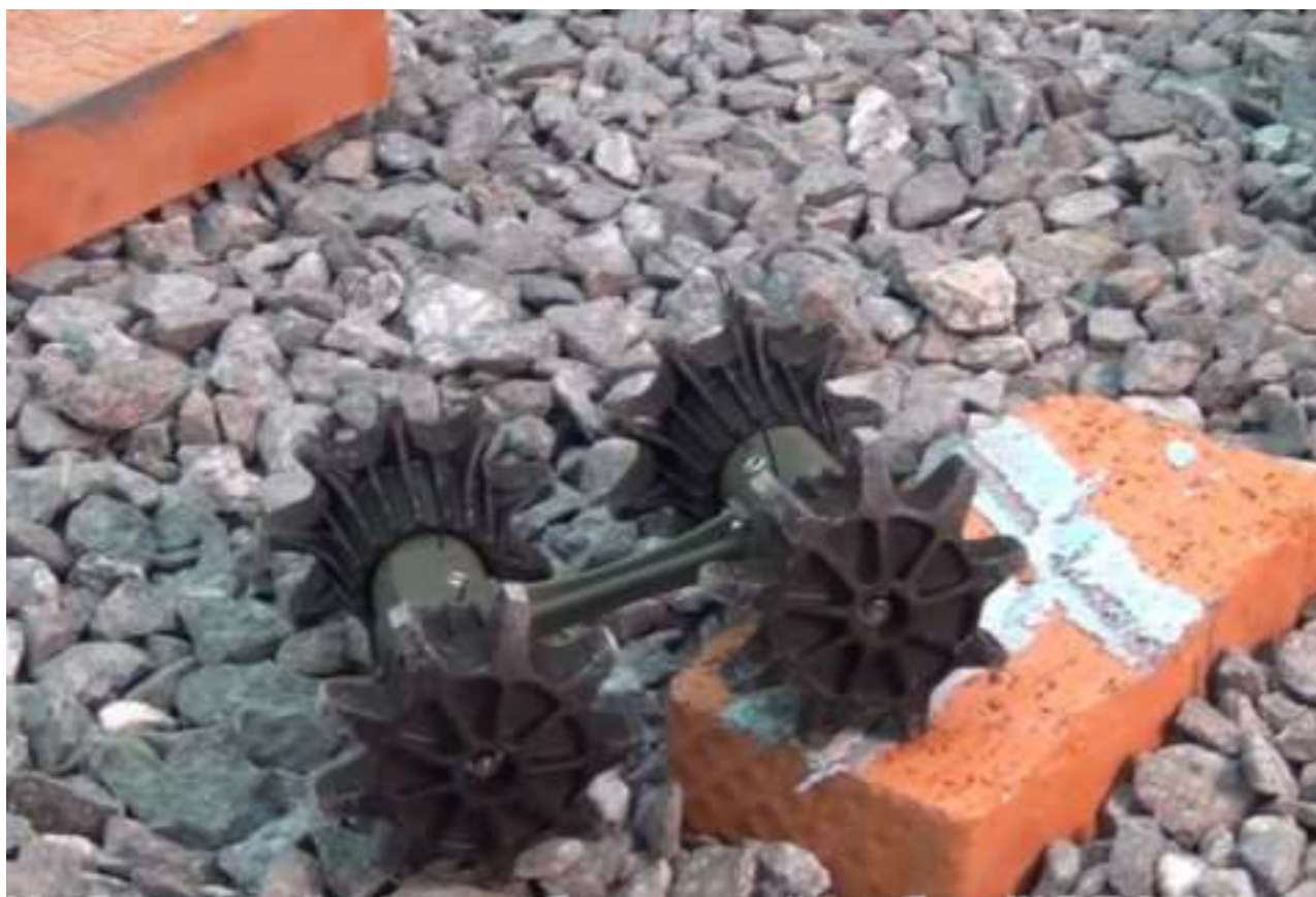
Рис. 5.270. Спаренный вариант робота «Юла-2»
