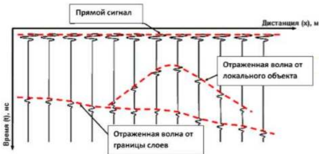
Рис. 5.201. Принцип образования отраженных волн от границ слоев локального объекта
