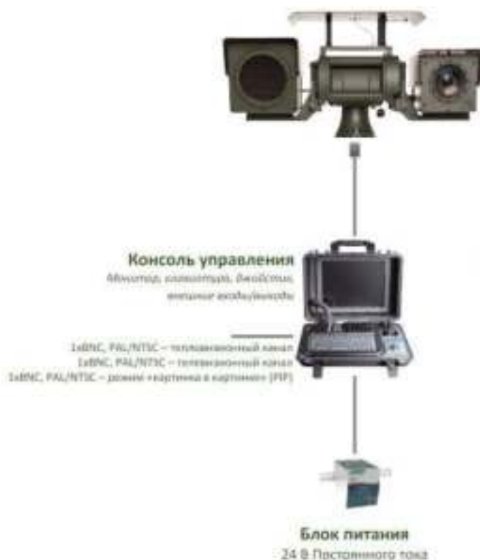
Рис. 6.131. Первый вариант схемы подключения конструктивных элементов системы RTR-900M
