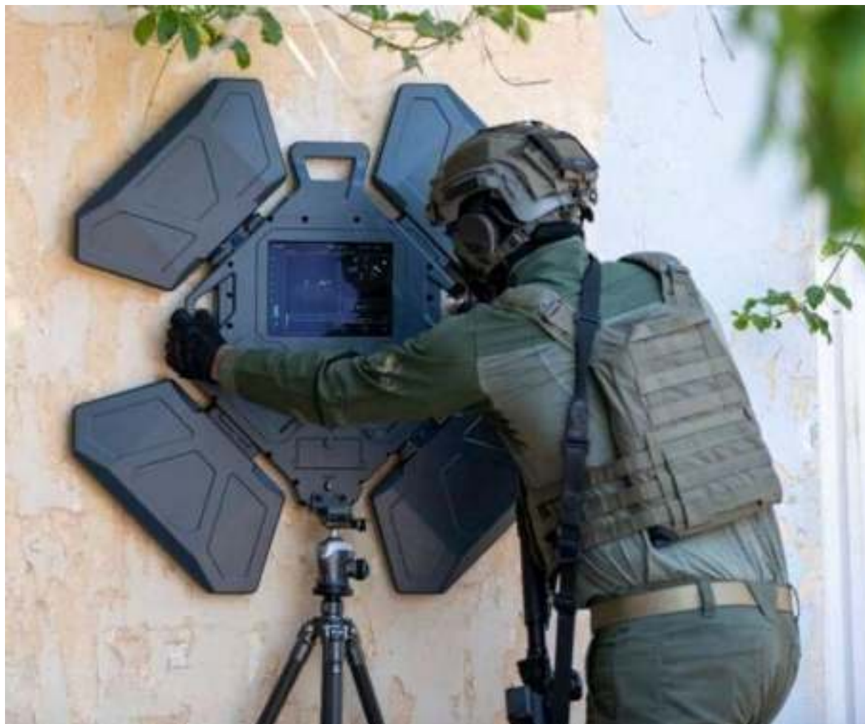
Рис. 5.169. Пример использования стеновизора «Xaver-1000» в боевых условиях
