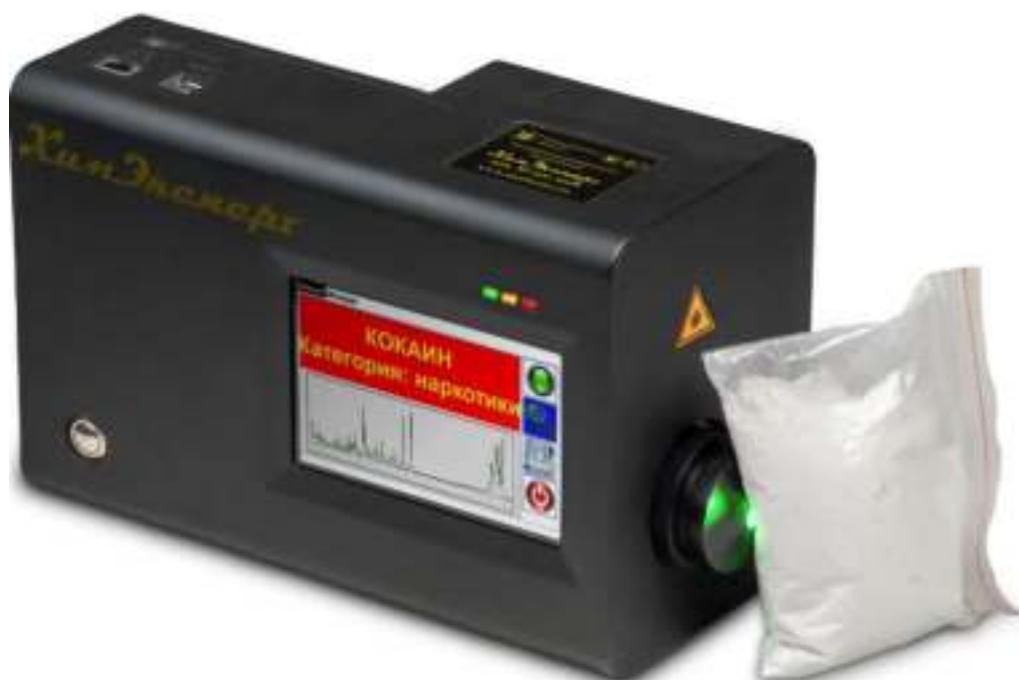
Рис. 5.65. Идентификация наркотических веществ (кокаин) в герметичной упаковке
