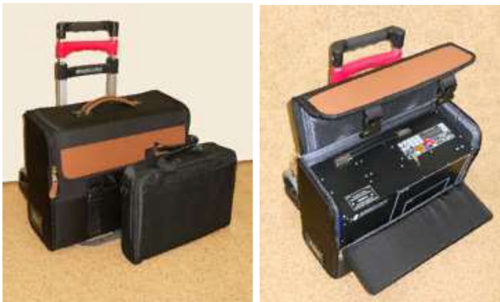
Рис. 5.129. Сканирующее устройство в армированной сумке и портативный компьютер из состава рентгеновского устройства досмотра полостей «Феникс»
