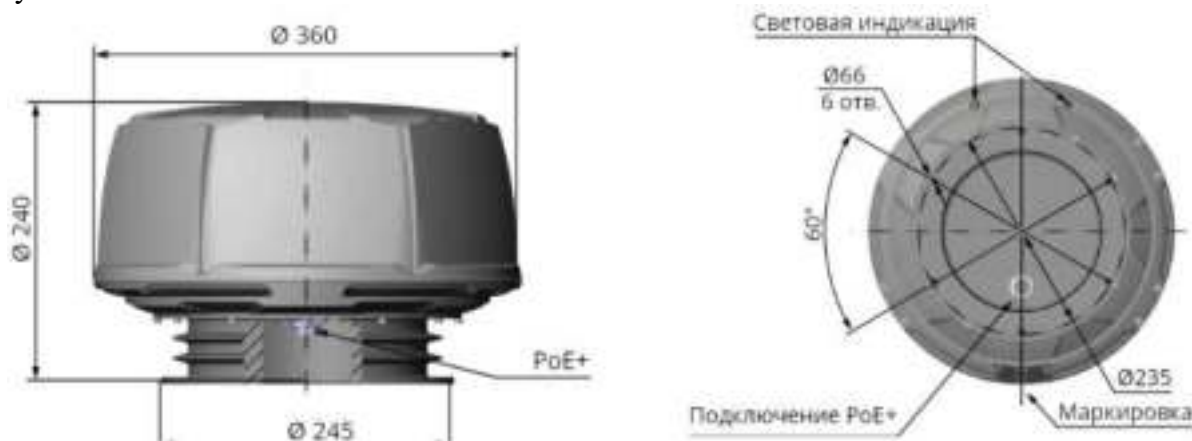
Рис. 6.139. Конструктивные особенности радара наземного наблюдения GR-800
