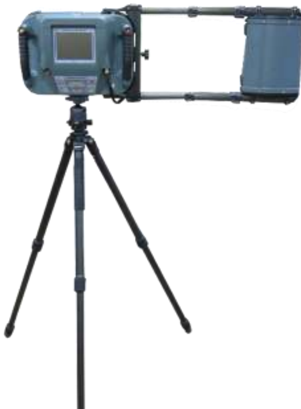
Рис. 5.190. Смонтированный на треноге радар-обнаружитель РО-400 2D с дополнительной антенной в режиме обнаружения движущихся объектов
