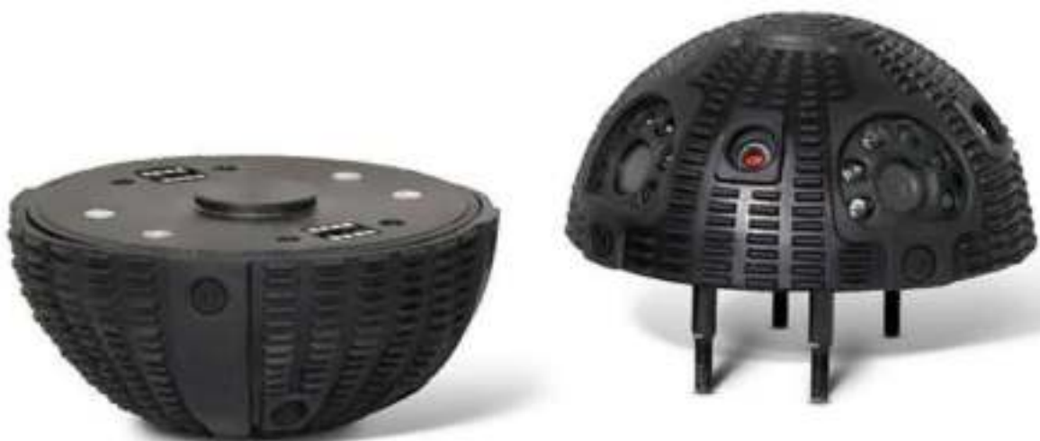
Рис. 5.250. Блок передачи информации (справа) и сменный аккумуляторный блок беспроводного досмотрового устройства «Сфера»
