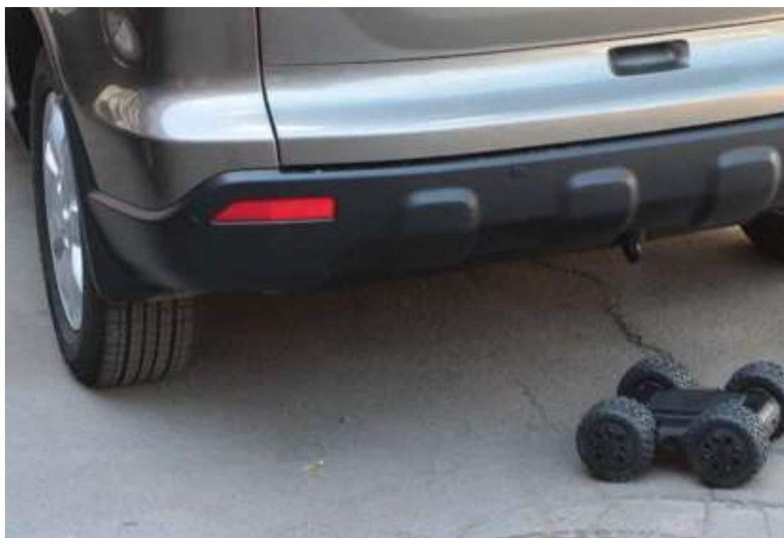
Рис. 5.23. Применение комплекса «Скарабей» для досмотра днища автомобиля
