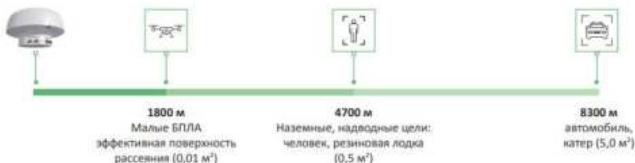
Рис. 6.165. Диапазон дальности обнаружения наземных, надводных и воздушных целей радиолокационной системой «Енот»
