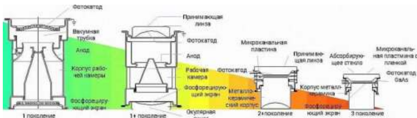
Рис. 6.12. Отличия в конструкции ПНВ различных поколений
