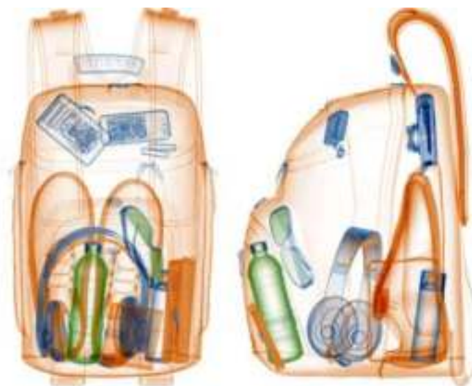
Рис. 5.112. Визуализация материалов различной плотности на рентгеноскопическом изображении современного интроскопа
