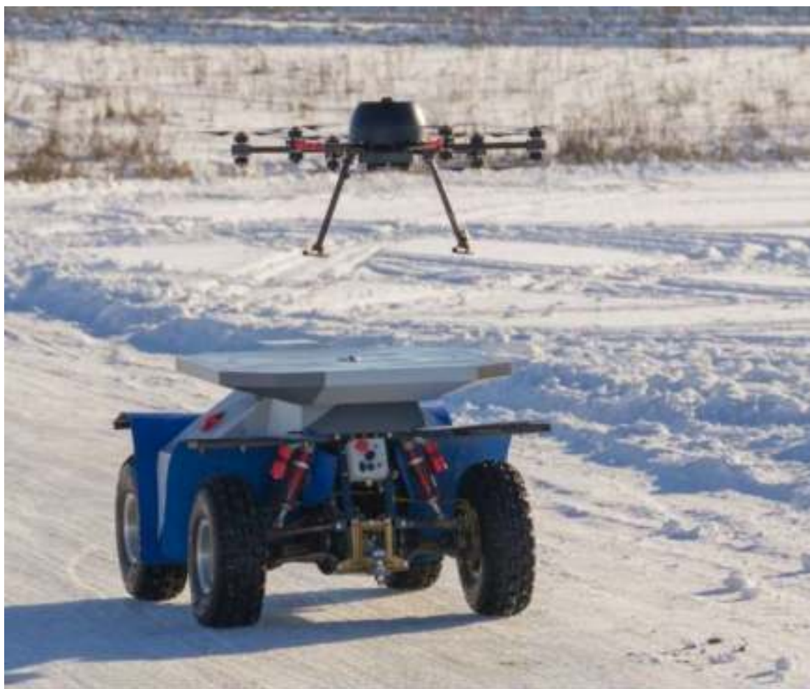
Рис. 5.319. Посадка мультикоптера на «мобильную авиабазу»
