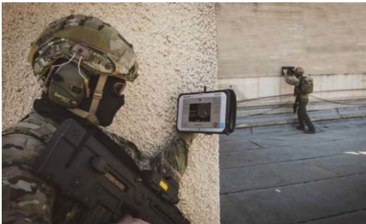
Рис. 5.162. Пример использования системы «XaverNet» для дистанционного получения информации о запреградном пространстве от стеновизора «Xaver-400»
