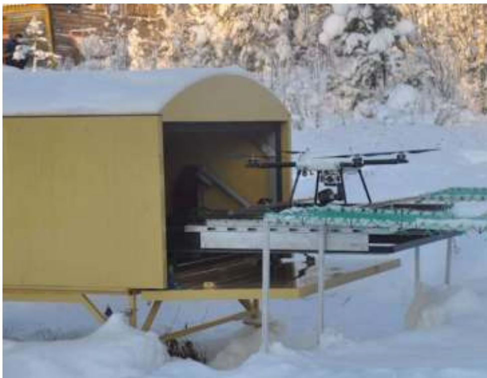
Рис. 5.313. Стартовый контейнер ПС5 с беспилотным летательным аппаратом «Скайрон ПС» на посадочной площадке
