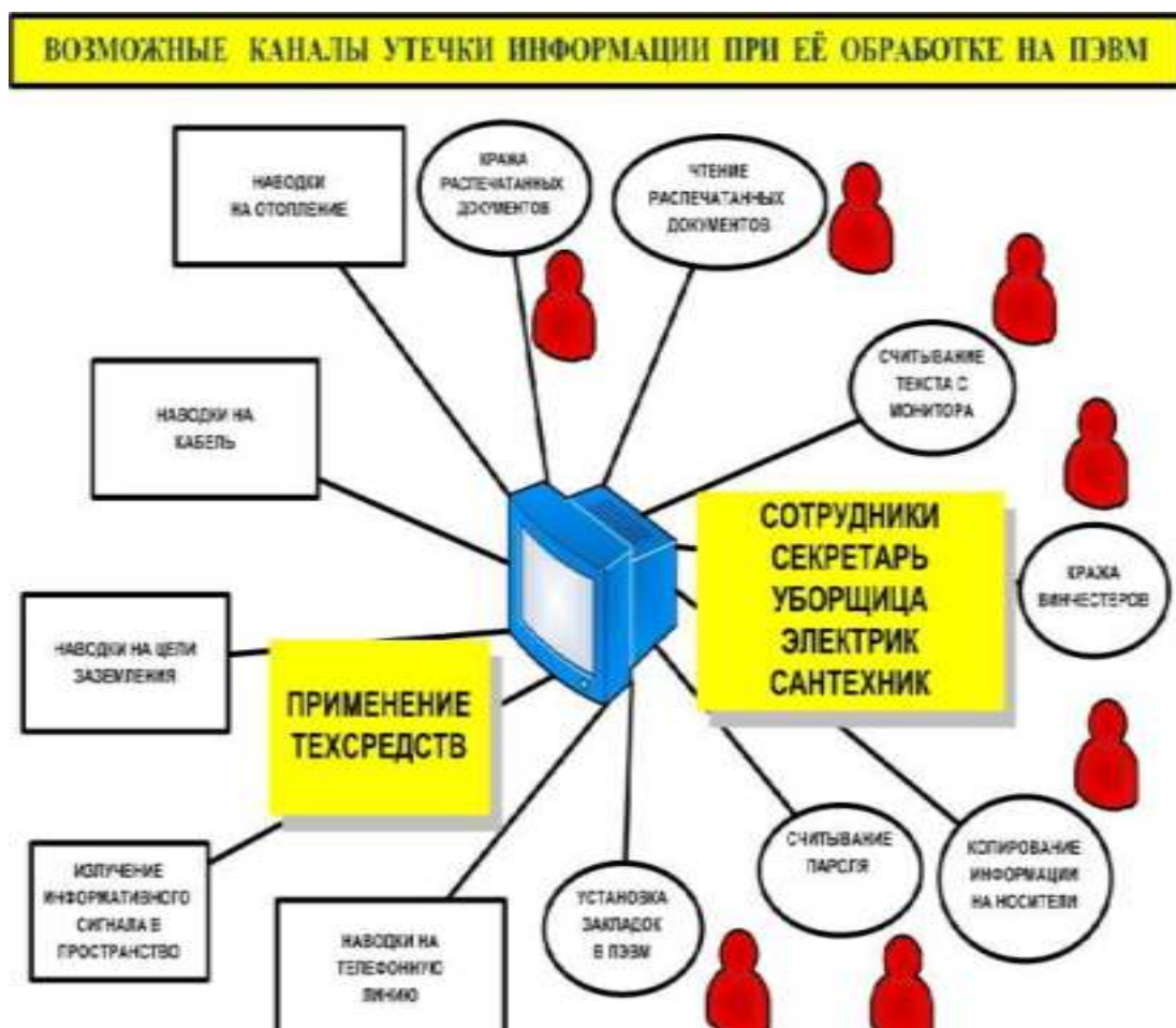
Рис. 7.2. Каналы утечки информации при её обработке на компьютерах
