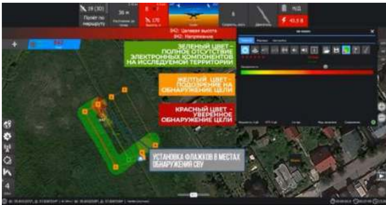
Рис. 5.329. Красными флажками помечено место, в котором обнаружено взрывное устройство при ведении поиска в автоматическом режиме
