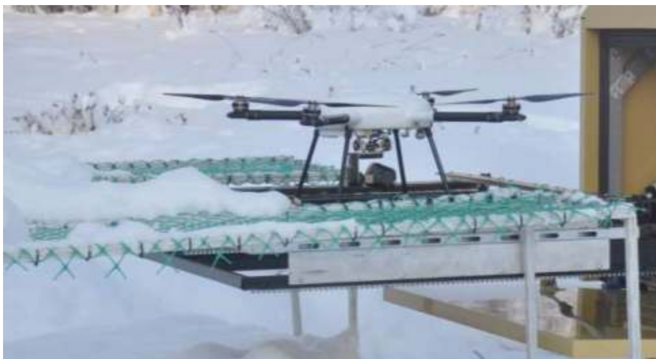
Рис. 5.315. Беспилотный летательный аппарат «Скайрон ПС» на посадочной площадке стартового контейнера ПС5
