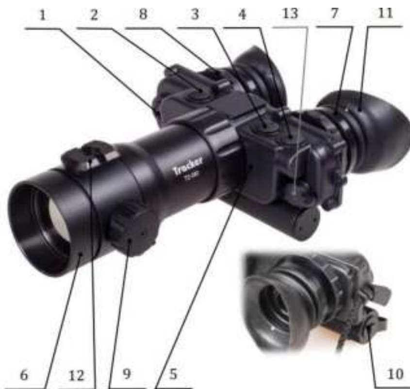
Рис. 6.95. Основные конструктивные элементы и органы управления тепловизионного бинокля Tracker-T4.642
