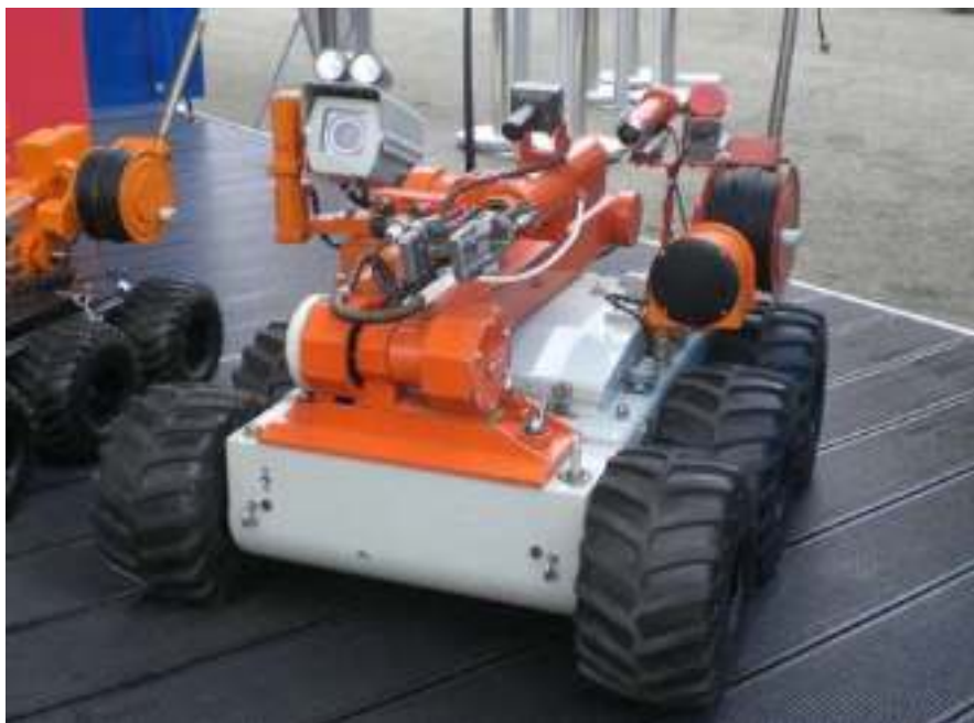
Рис. 5.233. Многофункциональный мобильный робототехнический комплекс сверхлегкого класса «Вездеход-ТМ5» (вид спереди)
