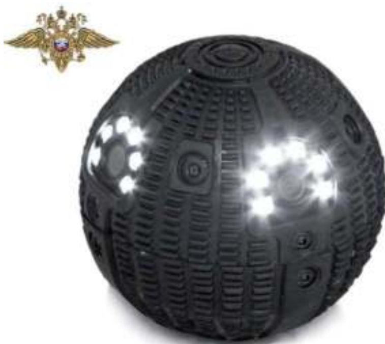
Рис. 5.249. Беспроводное досмотровое устройство «Сфера» с включенной светодиодной подсветкой
