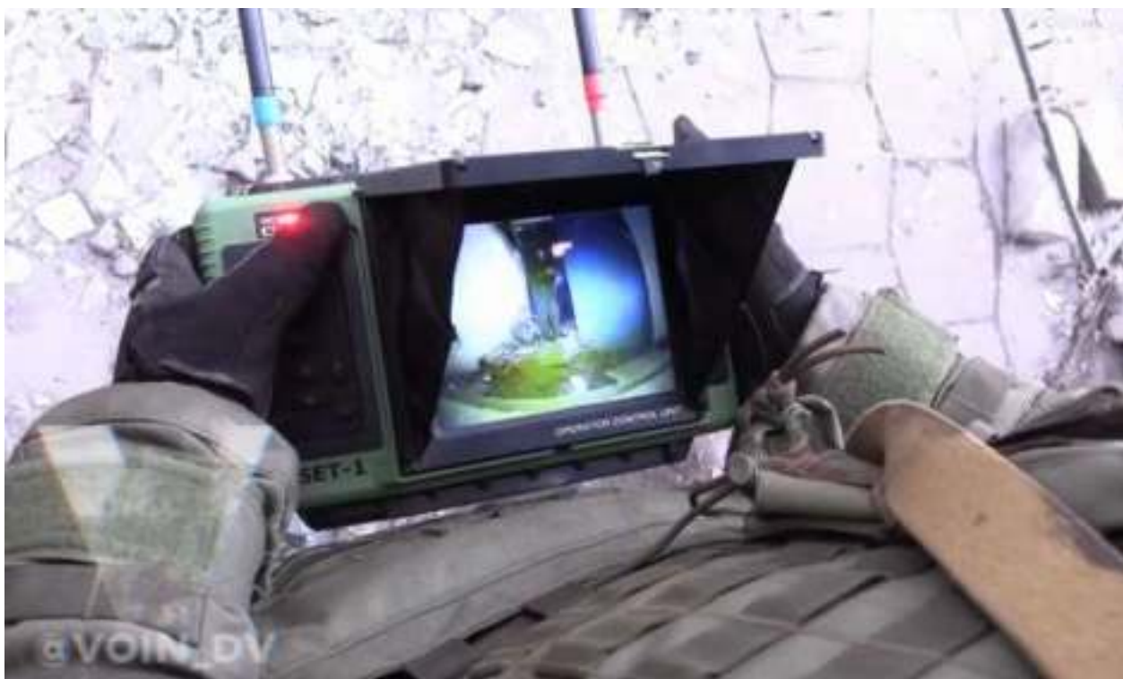
Рис. 5.242. Отображение на пульте управления аудиовизуальной информации, поступающей от комплекса «Скарабей»
