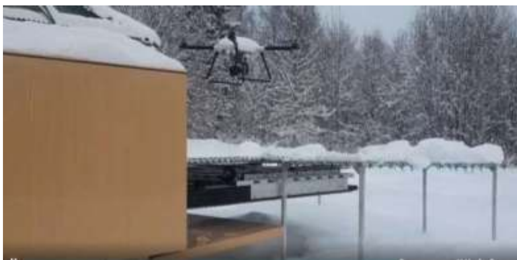
Рис. 5.314. Автоматическая посадка БПЛА «Скайрон ПС» на площадку стартового контейнера ПС5
