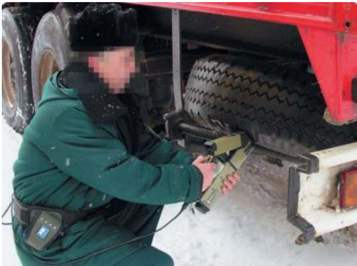
Рис. 5.136. Использование ручного рентгеновского сканера «Ватсон» для проведения досмотра колеса
