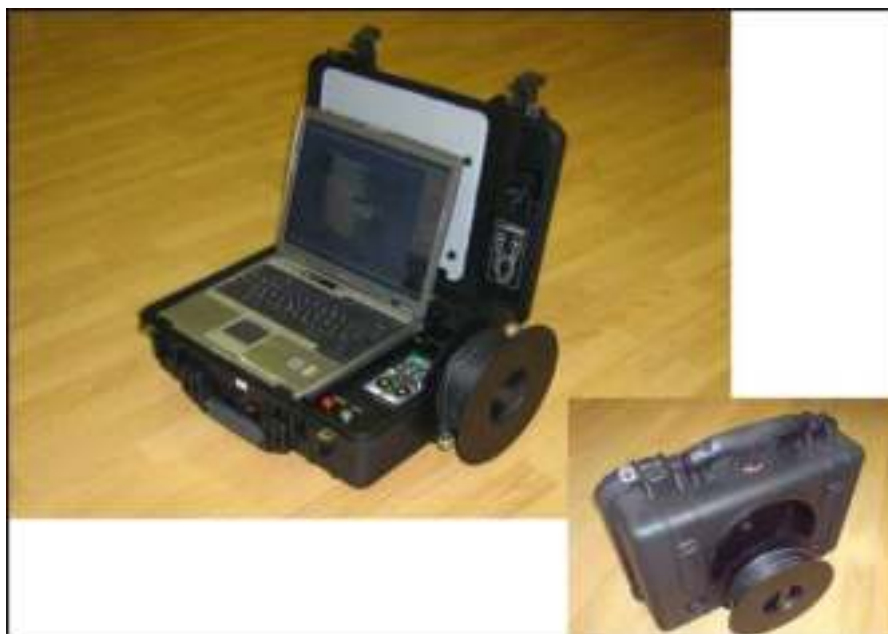
Рис. 5.124. Блок управления и обработки изображения со встроенным компьютером
