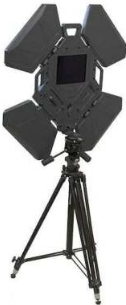
Рис. 5.168. Портативное радарное устройство для запреградного обнаружения живых объектов (стеновизор) «Xaver-1000»
