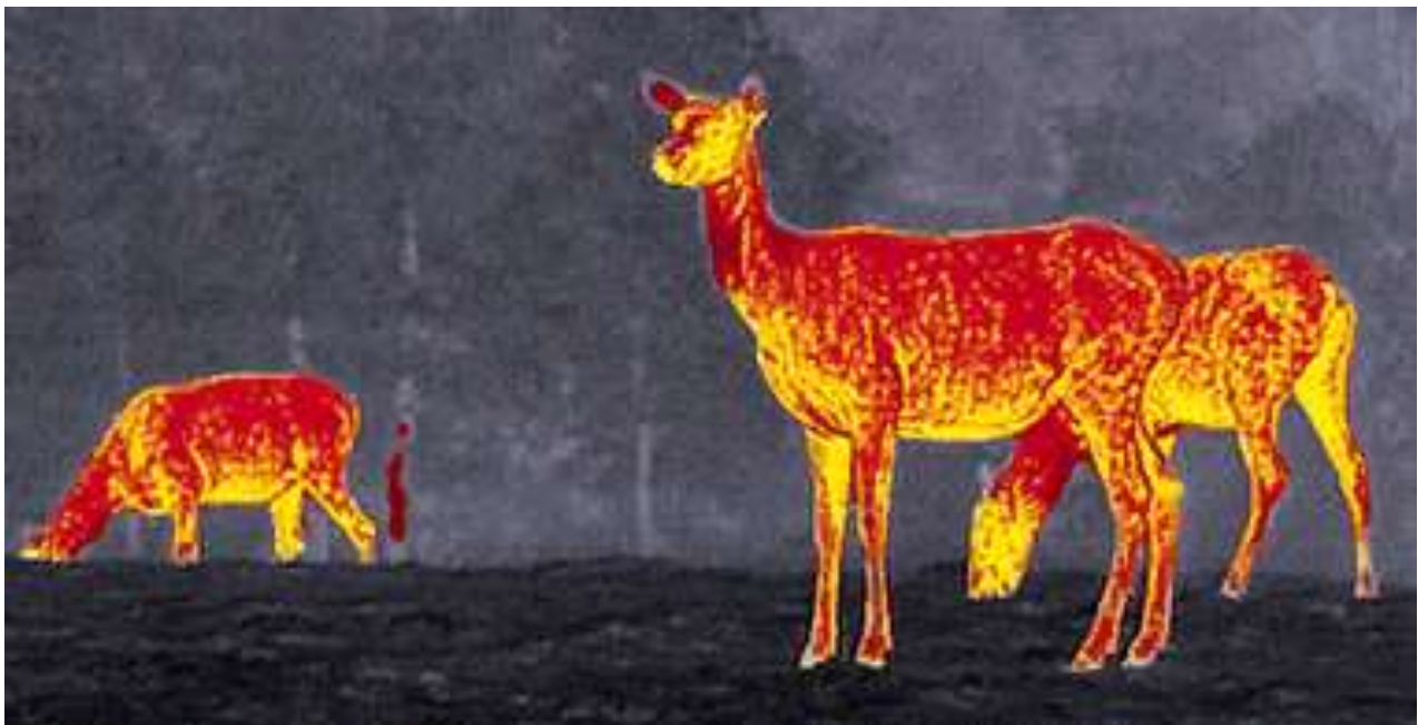
Рис. 6.70. Использование цветовой схемы с выделением тепловой цели красным цветом на черно-белом фоне
