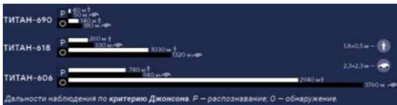
Рис. 6.102. Дальность обнаружения и распознавания наземных объектов для некоторых модификаций тепловизоров «Титан»
