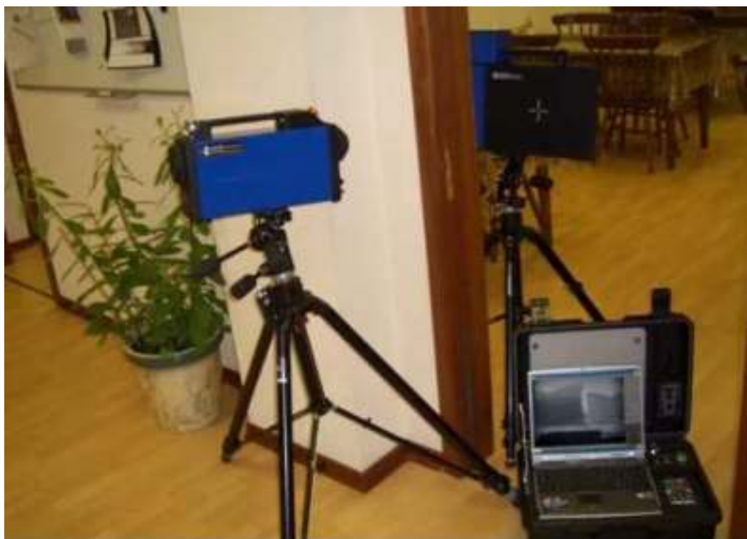
Рис. 5.127. Использование рентгентелевизионной установки «Шмель-240ТВ» для поиска устройств съема информации в помещениях
