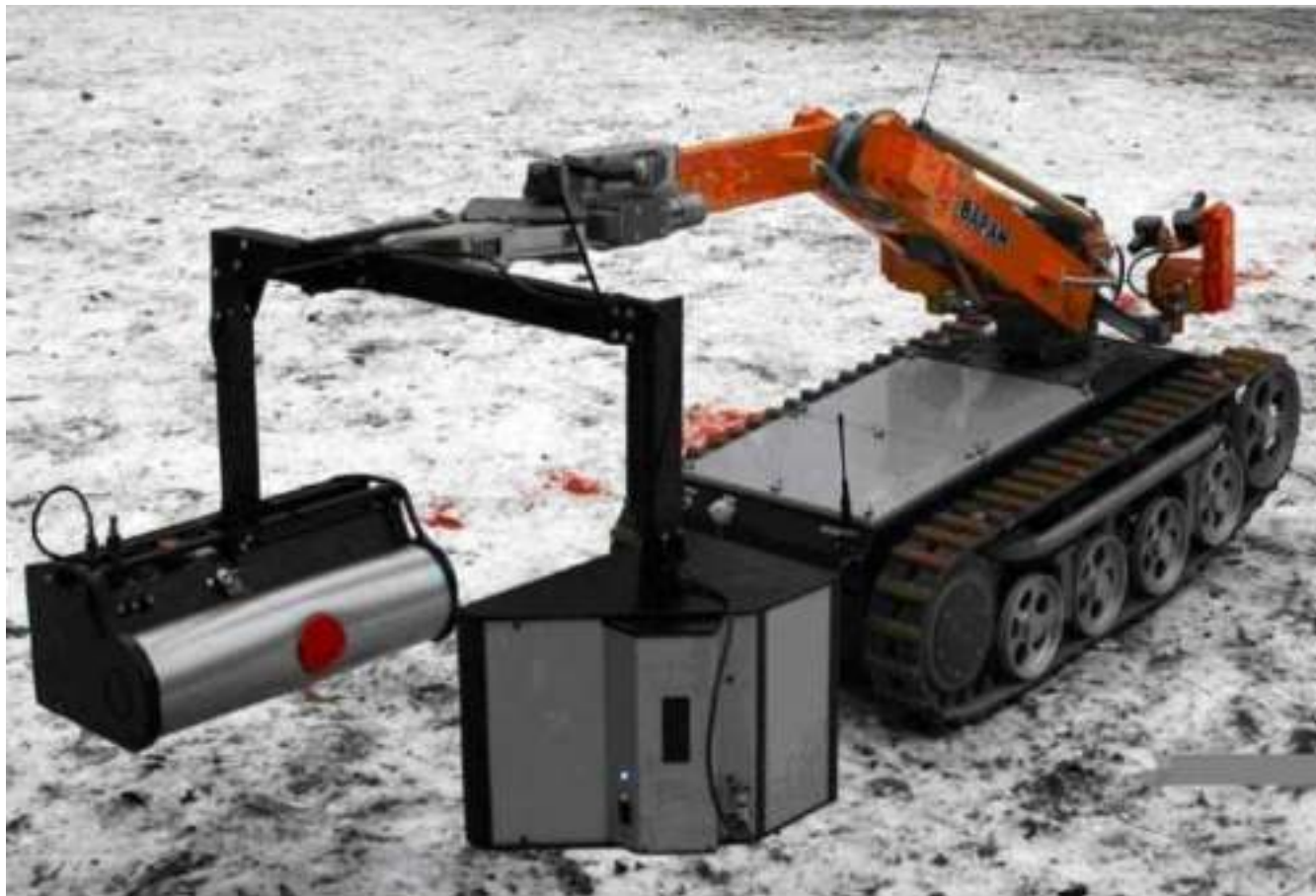
Рис. 5.219. Мобильный робототехнический комплекс «Варан» с портативной рентгентелевизионной установкой «Шелест»
