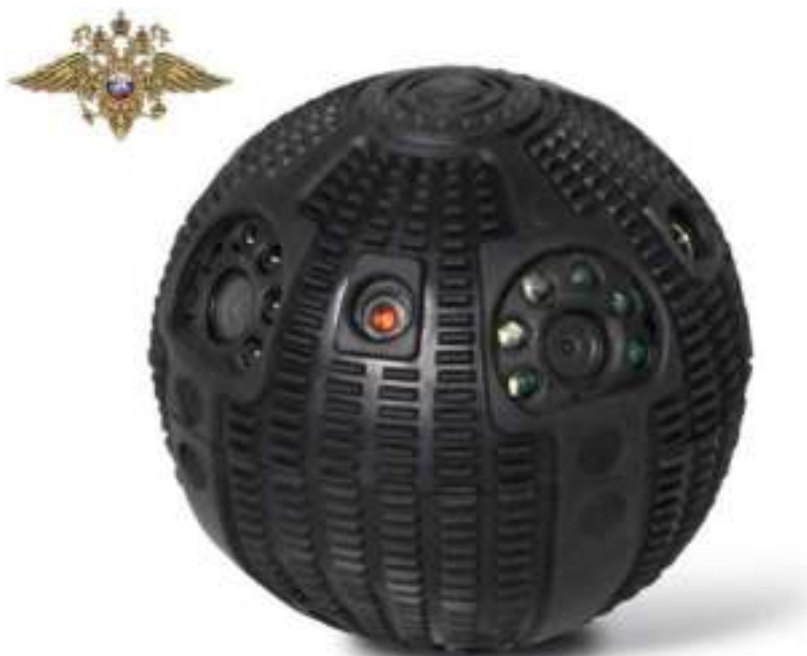
Рис. 5.248. Беспроводное досмотровое устройство «Сфера» с выключенной светодиодной подсветкой
