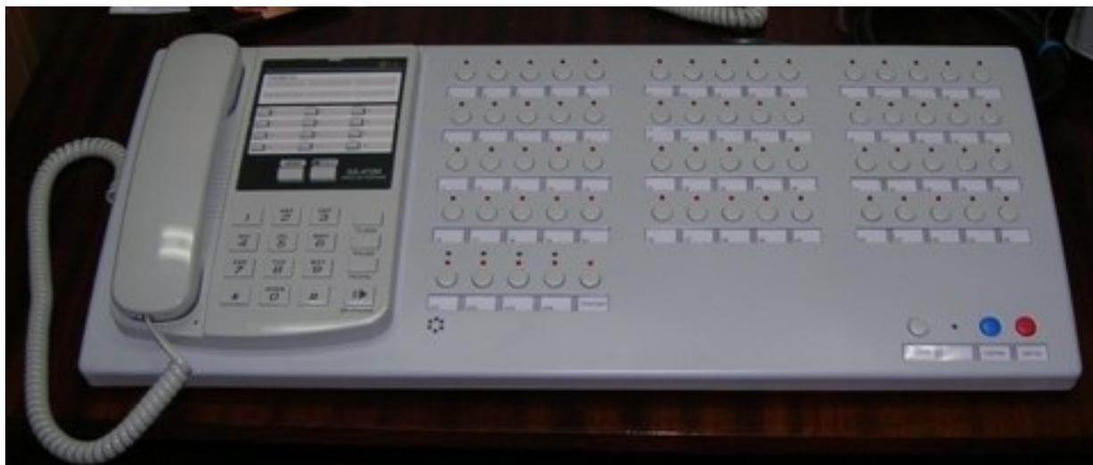
*Фото 10. Установка оперативной телефонной связи УОТС-60/4-М1*
