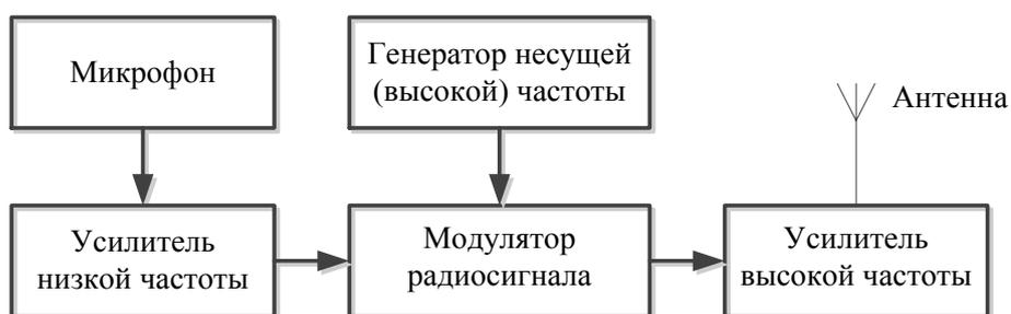
Рисунок 19. Структурная схема передатчика
