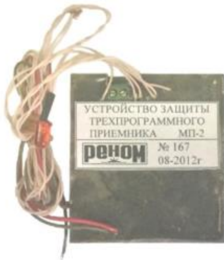
Рис. 6.36. МП-2 – средство исключения утечки по трансляционной сети
