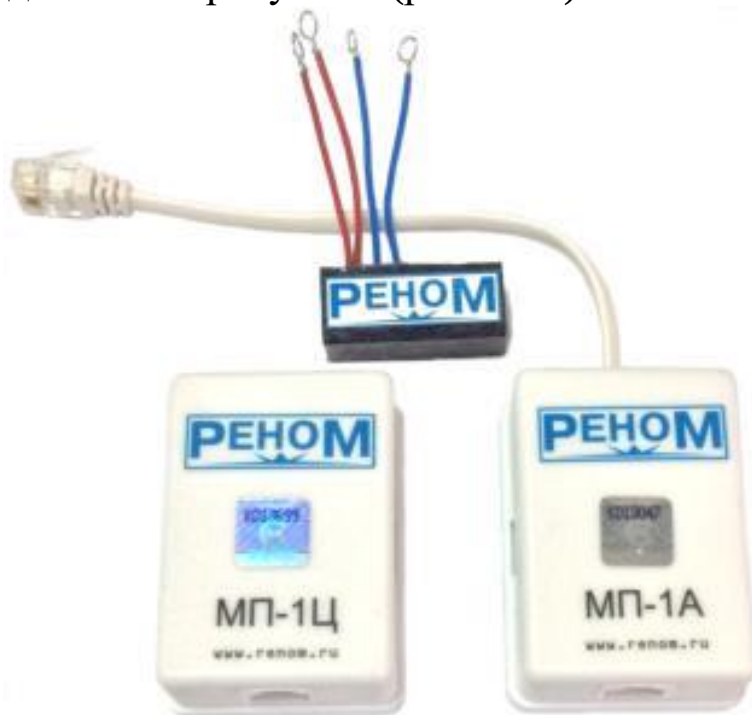
Рис. 6.35. МП-1А в евророзетке – устройство аналогового ТА
