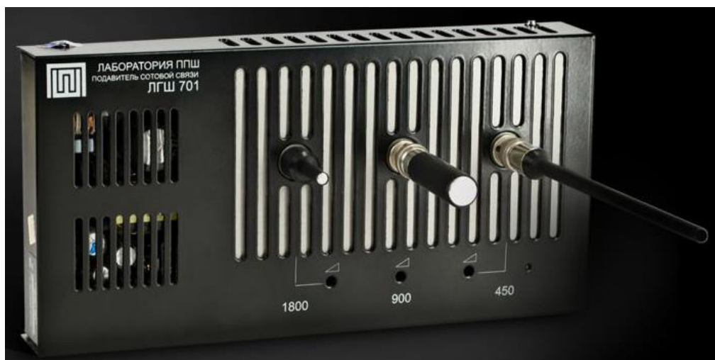
Рис. 6.45. ЛГШ-701 – подавитель сотовой связи
