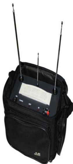
Рис. 6.18. Широкополосный генератор радишума ПРП-1500
