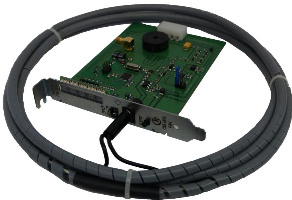
Рис. 6.23. ГШ-К-1800МС, генератор шума
