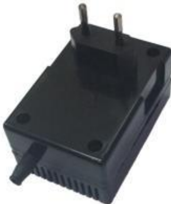
Фото 6.37. МП-3 – средство для исключения утечки информации в сеть питания
