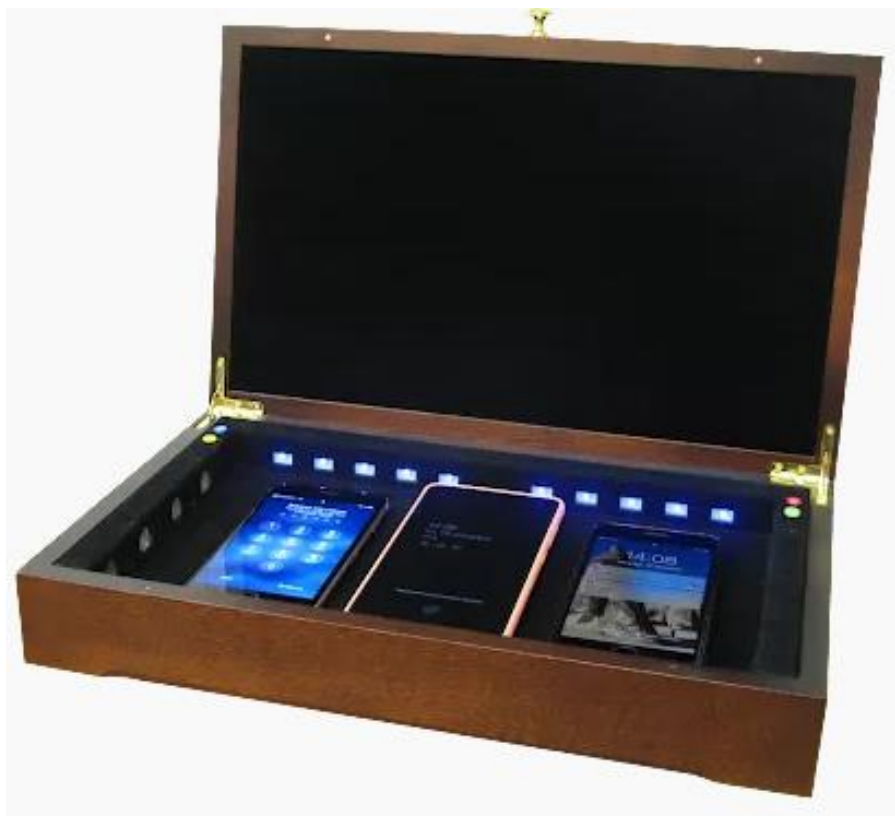
Рис. 5.47. Акустический сейф «Ларец-УЗ»
