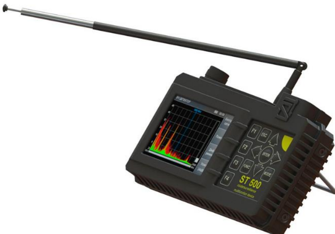
Фото 6.57. ST 500 ПИРАНЬЯ –многофункциональный поисковый прибор
