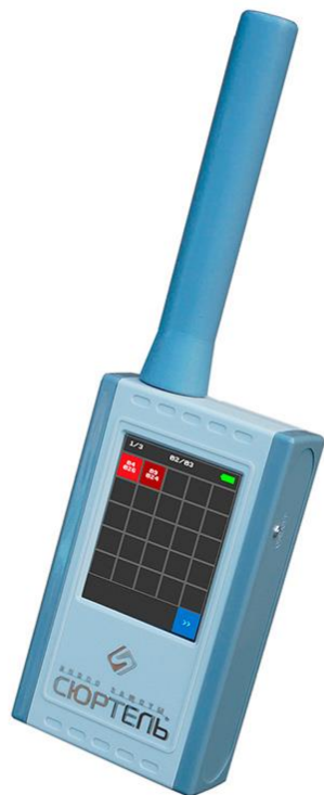
Рис. 6.62. SEL C-200 АРКАМ –электронный детектор скрытых видеокамер
