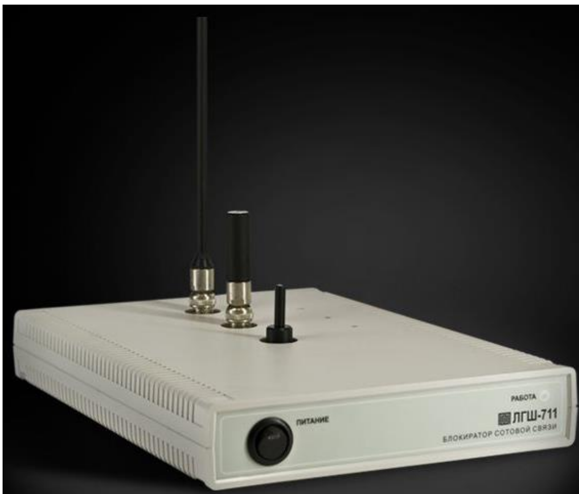
Рис. 6.47. ЛГШ-711 – подавитель сотовой связи
