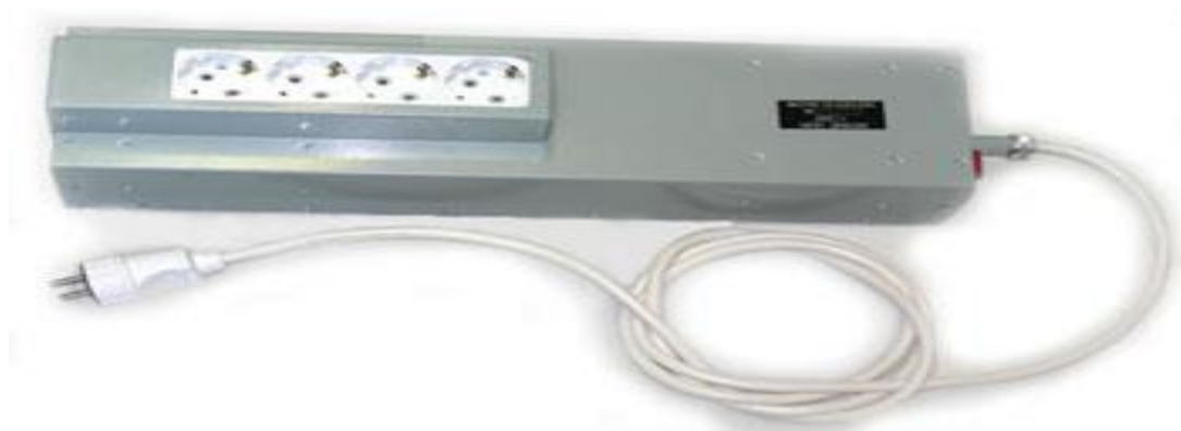
Рис. 6.53. ФСПК-10 – сетевой фильтр для защиты информации от утечки
