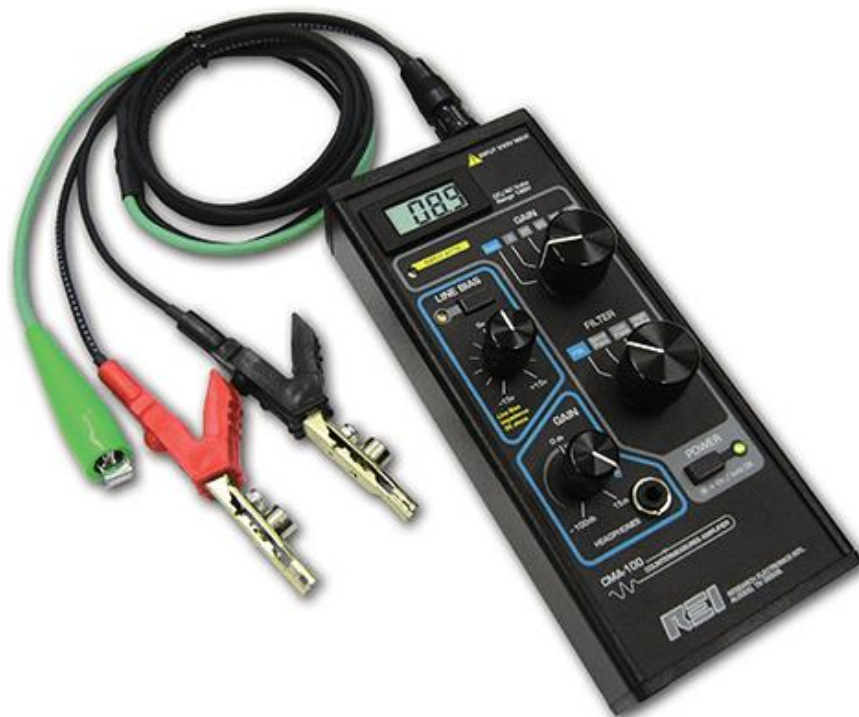
Рис. 6.61. СМА-100 – усилитель для обследования проводных линий
