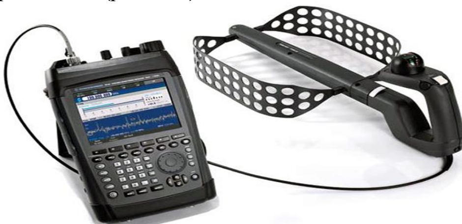
Рис. 6.62. Rohde& Schwarz®PR100 –мониторинговый приёмник
