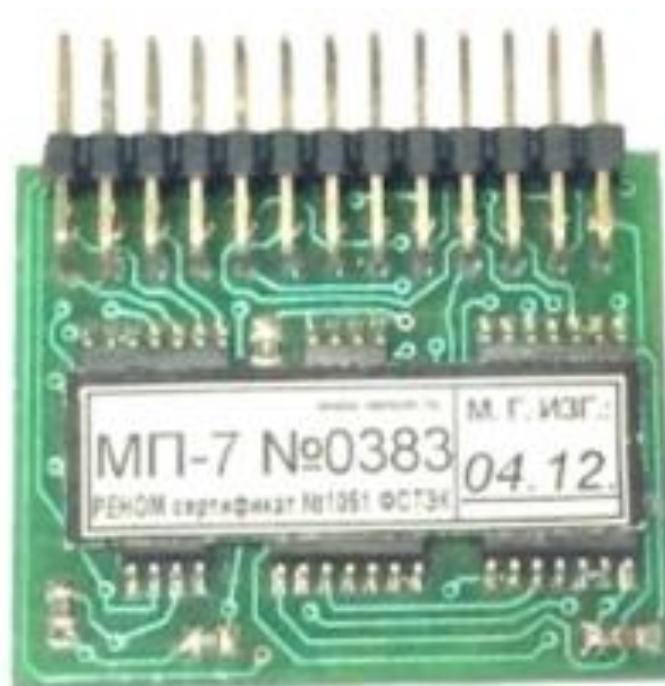
Рис. 6.40. МП-7 Гвард – защита телефонного аппарата (ТА), подключаемого на цифровой порт АТС, от утечки через акустоэлектрические преобразователи телефона акустических сигналов помещения (без исследований ТА и монтажа)
