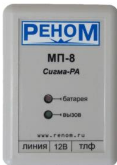
Рис. 6.41. МП-8, Сигма-РА – устройство защиты помещений от утечки речевой и другой акустической информации через телефонный аппарат
