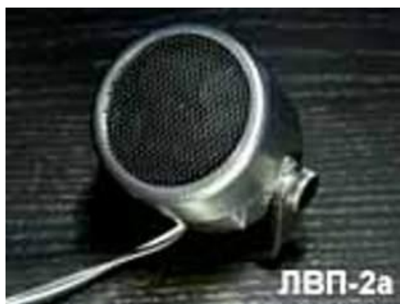
Рис. 6.31. ЛВП-2а, акустический излучатель
