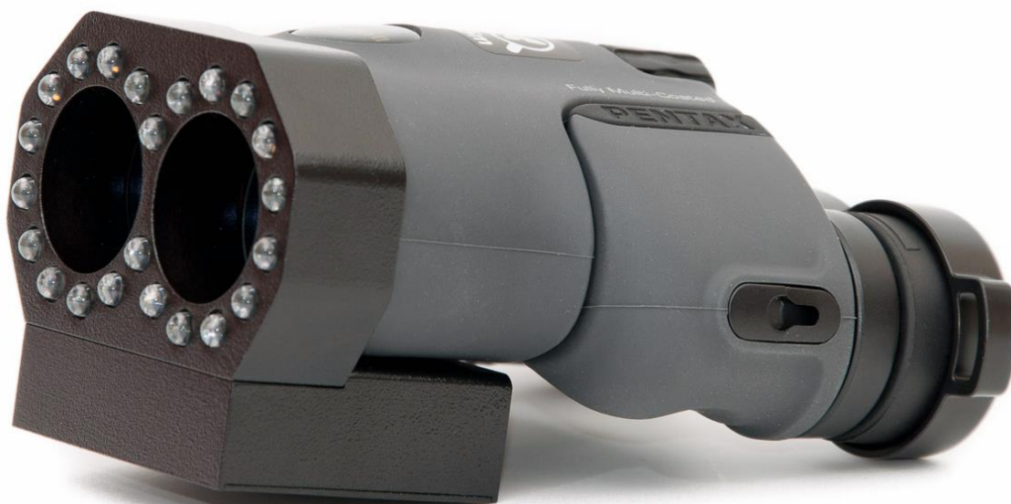
Рис. 6.59. ОПТИК-2 – профессиональный обнаружитель скрытых видеокамер
