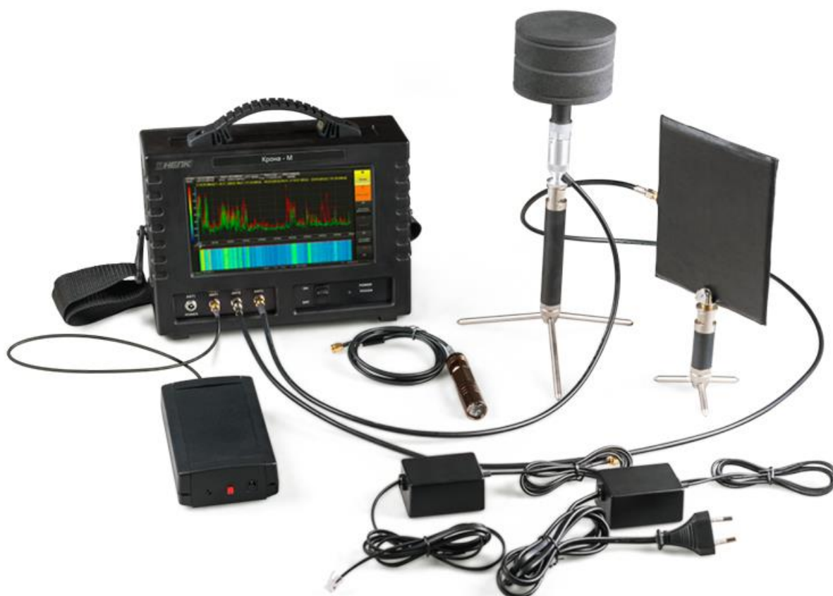
Рис. 6.63. КРОНА-М12 –портативный анализатор спектра реального времени
