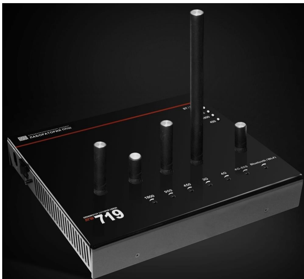
Рис. 6.48. ЛГШ-719 – блокиратор сотовой связи и сигналов 3G, LTE, Bluetooth, WiFi
