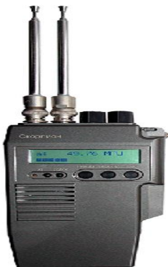
Рис. 6.58. СКОРПИОН 3.5 – скоростной поисковый приемник радиосигналов
