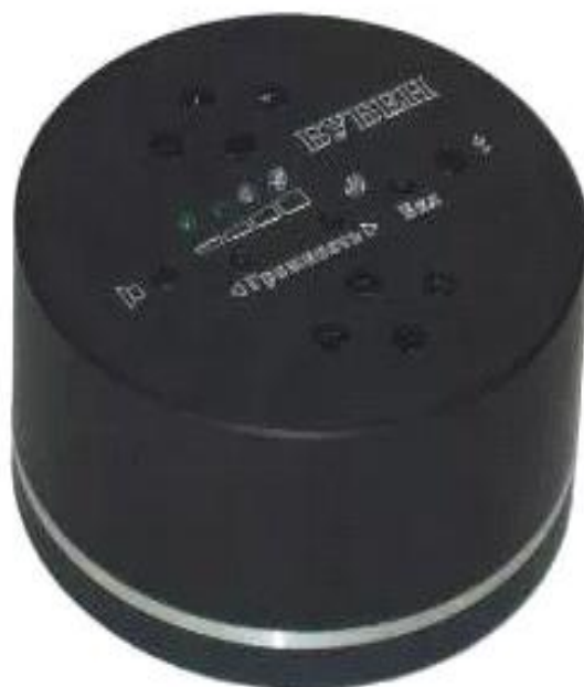
Рис. 5.23. Генератор акустической помехи «БУБЕН»
