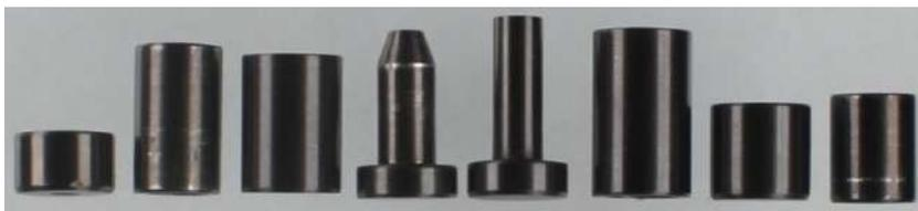
*Рис. 1. Общий вид (с боку) набора приспособлений самодельного изготовления, предназначенного для сборки и переснаряжения патронов 9x22 мм травматического действия*
