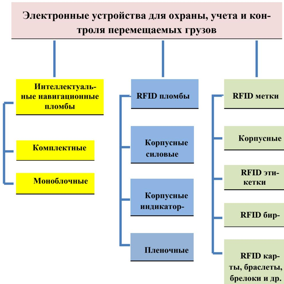
Рис. 1. Общая классификация электронных пломб
