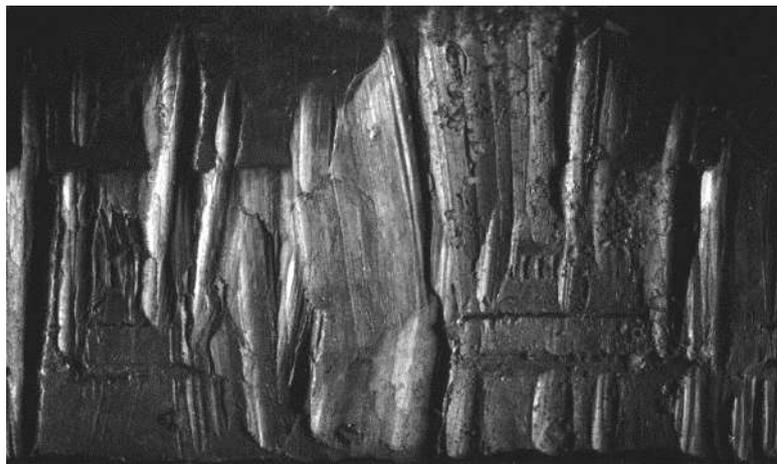
*Иллюстрация 5. Развертка поверхности пули, прошедшей через канал полимерной трубки*
