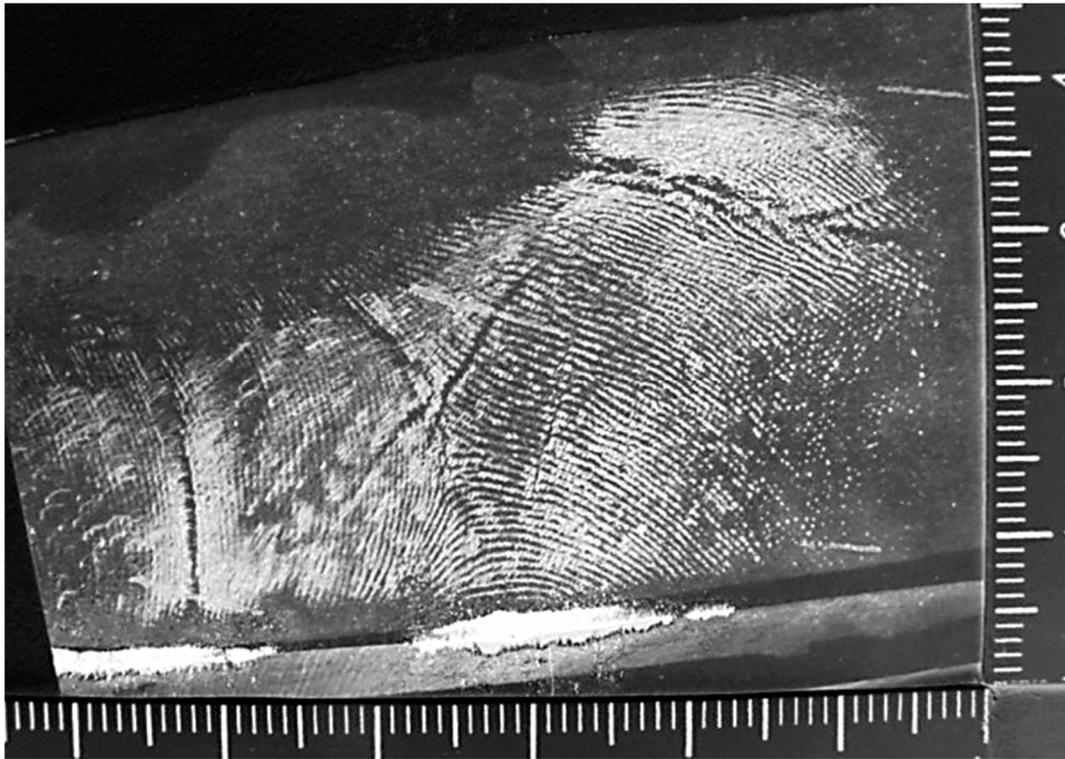
Фотоиллюстрация 3. Увеличенное изображение следа ладони руки размером 65x40 мм, откопированного с бутылки на отрезок темной дактилоскопической пленки размером 96x78 мм, до компьютерной обработки (масштаб 2:1)
