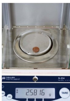
Рис. 64. Попытка измерить вес монеты на весах: напольные весы – монета ничего не весит ( a ); та же монета на кухонных весах ( б , в ); монета на лабораторных аналитических весах ( г , д , е )
