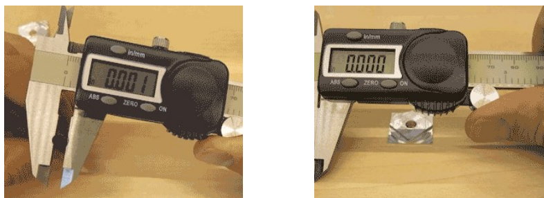
Рис. 18. Проверка средства измерения с помощью эталонного образца
