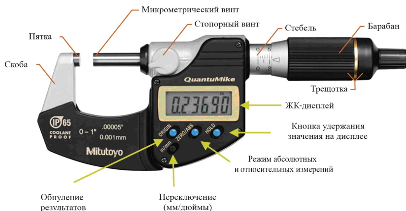
Рис. 26. Цифровой микрометр Mitutoyo QuantuMike Review
