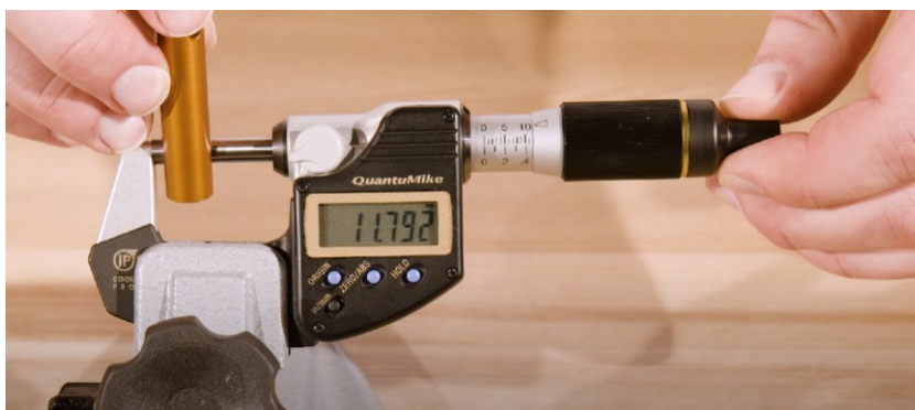
Рис. 28. Последовательность действий для измерений, выполняемых с помощью электронного микрометра: размещение объекта между шпинделем и пяткой (а); зажатие объекта с помощью хrapовика (б)
