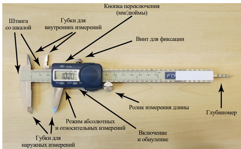
Рис. 16. Устройство электронного штангенциркуля с цифровой шкалой
