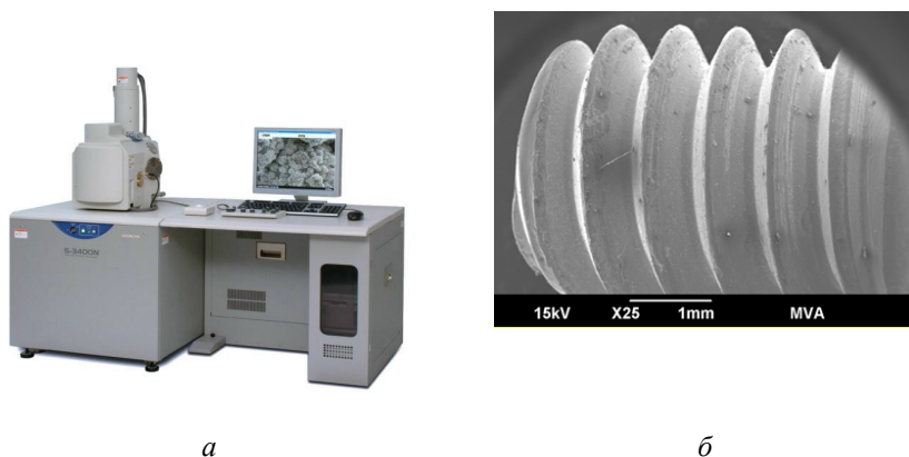
Рис. 56. Растровый электронный микроскоп HITACHI S-3400N (а), изображение рельефной поверхности, сформированное при помощи электронного микроскопа (б)
