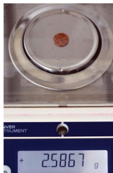
Рис. 64. Попытка измерить вес монеты на весах: напольные весы – монета ничего не весит ( a ); та же монета на кухонных весах ( б , в ); монета на лабораторных аналитических весах ( г , д , е )
