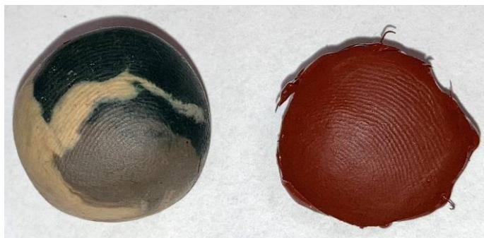
Рис. 57. Оттисковая масса Mikrosil (а), изображение слепка, полученного со следа пальца руки (б)
