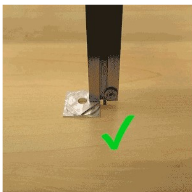
Рис. 21. Пример измерения, выполняемого с помощью глубиномера: правильное ( a ) и неправильное ( б ) положение инструмента относительно образца
