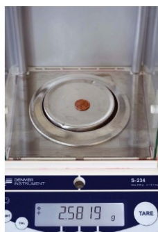
Рис. 64. Попытка измерить вес монеты на весах: напольные весы – монета ничего не весит ( a ); та же монета на кухонных весах ( б , в ); монета на лабораторных аналитических весах ( г , д , е )
