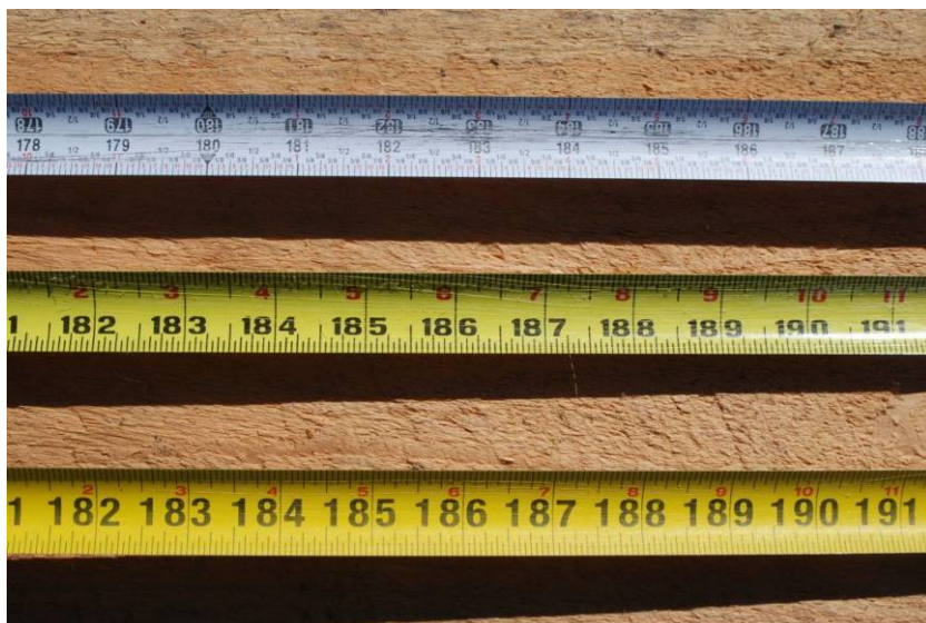
Рис. 61. Измерительные линейки и рулетки: школьная линейка (внизу), выровненная с прослеживаемой линейкой (вверху) (а); строительные металлические рулетки (внизу), выровненные с прослеживаемой рулеткой (вверху) (б)
