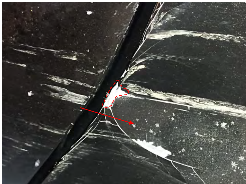
Рис. 4. Повреждение лакокрасочного покрытия двери в полости технологического углубления. Разметкой красного цвета отмечен след и его направление образования
