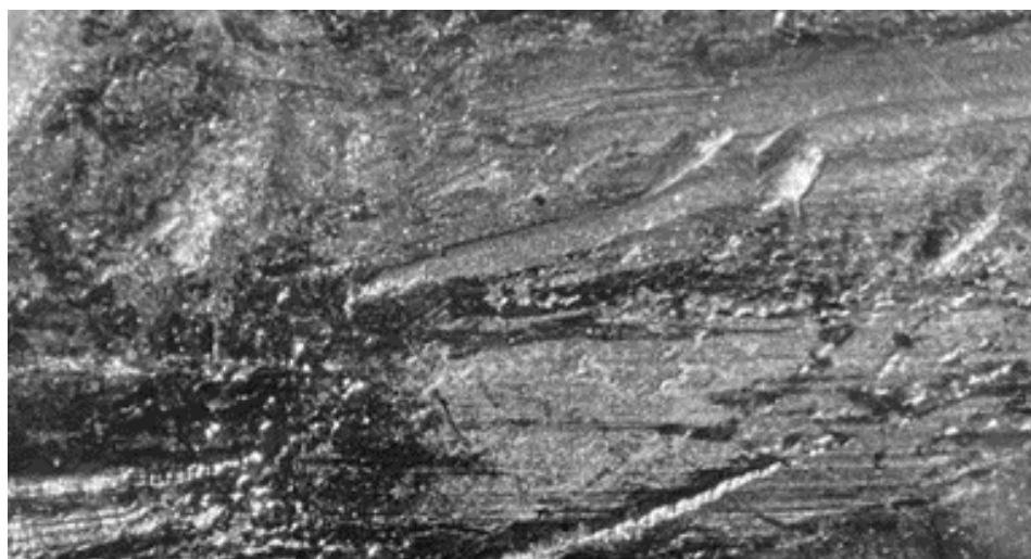
Рис. 7. Следы на поверхности скважины для ключа, располагающиеся вдоль канала скважины для ключа, ближе к зонам округлой формы от контакта головок кодовых штифтов с поверхностью ротора
