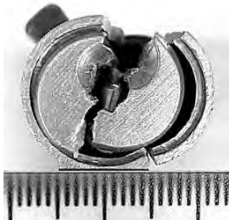
Рис. 10. Состояние цилиндра и ротора, после манипуляционного воздействия «свертышем»
