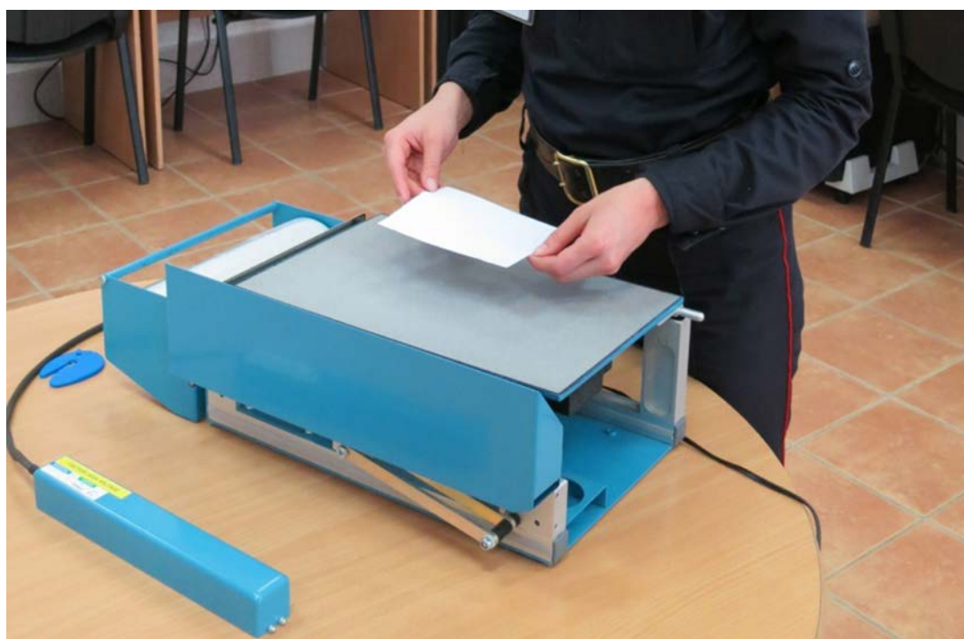
Рис. 6. Размещение исследуемого документа вакуумном столике установки «ESDA-Lite»
