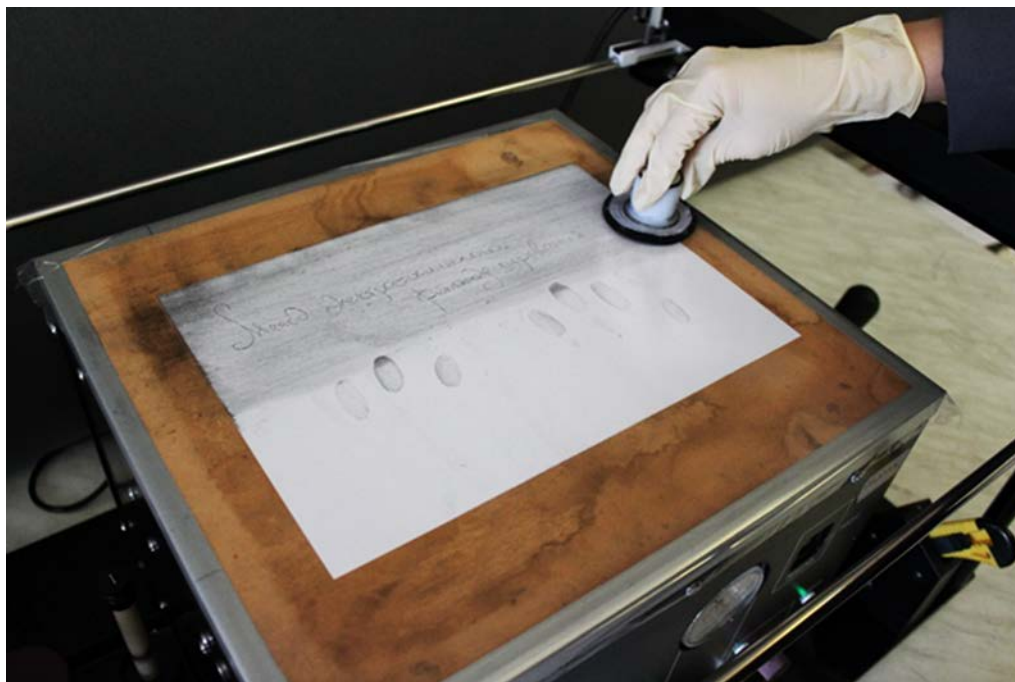
Рис. 9. Проявление скрытого изображения с помощью проявляющей подушечки
