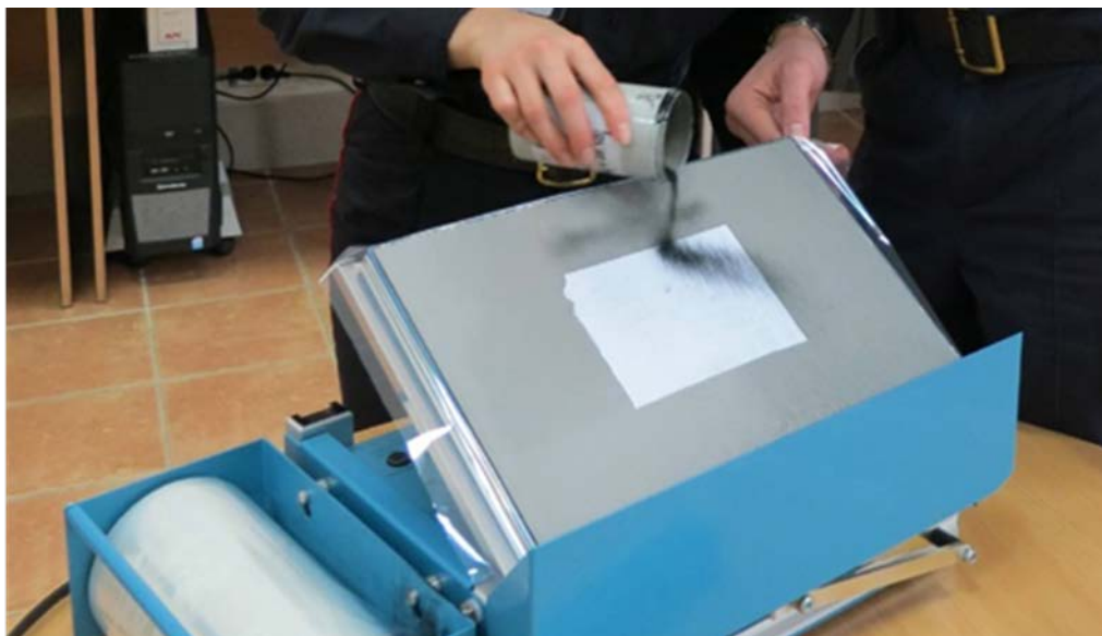
Рис. 10. Проявление скрытого изображения каскадным способом
