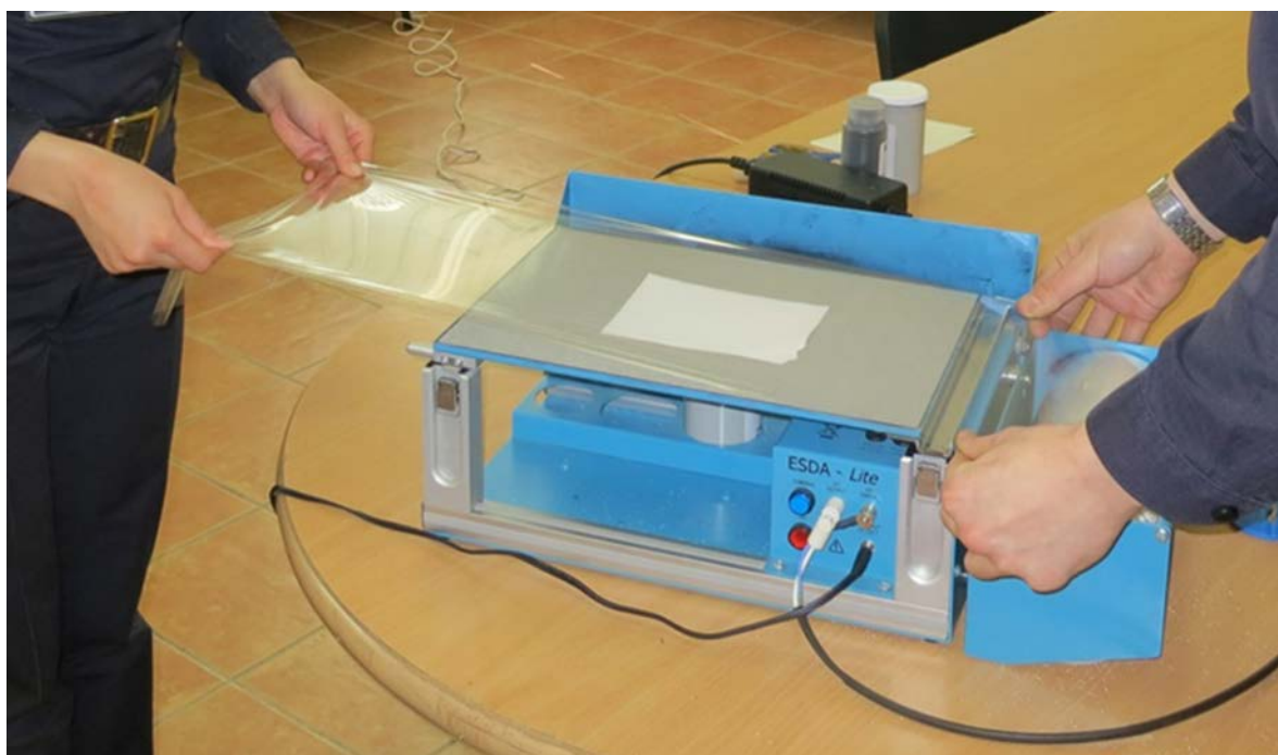
Рис. 7. Накрывание исследуемого документа диэлектрической пленкой на вакуумном столике установки «ESDA-Lite»
