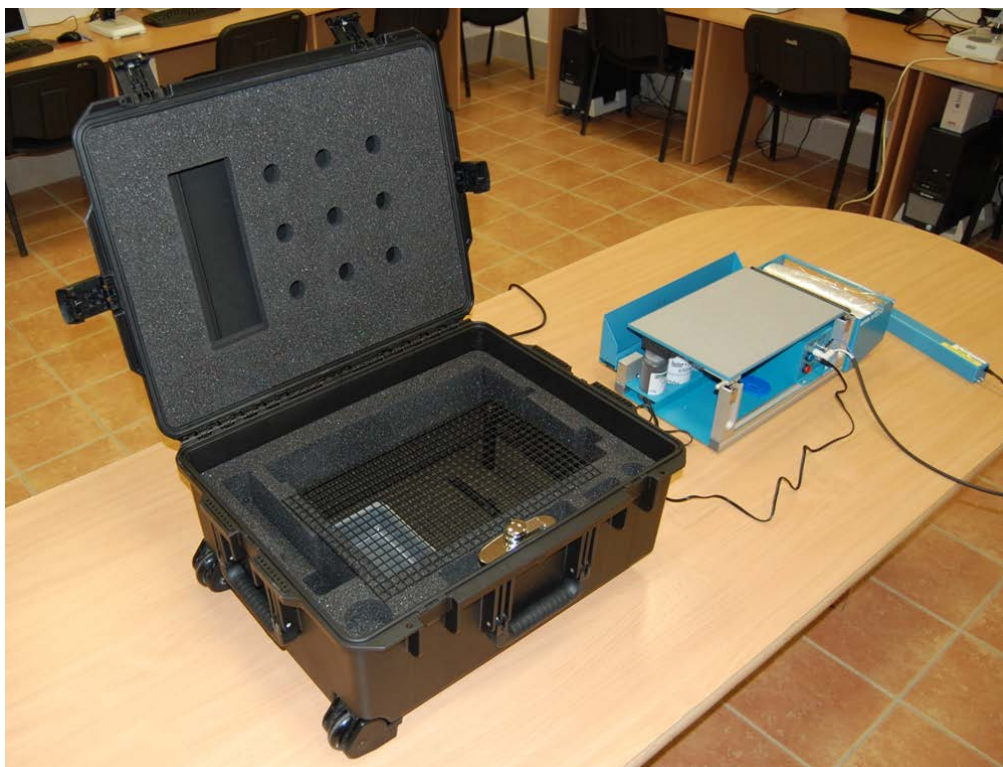
Рис. 4. Установка «ESDA-Lite» с футляром – увлажняющей камерой
