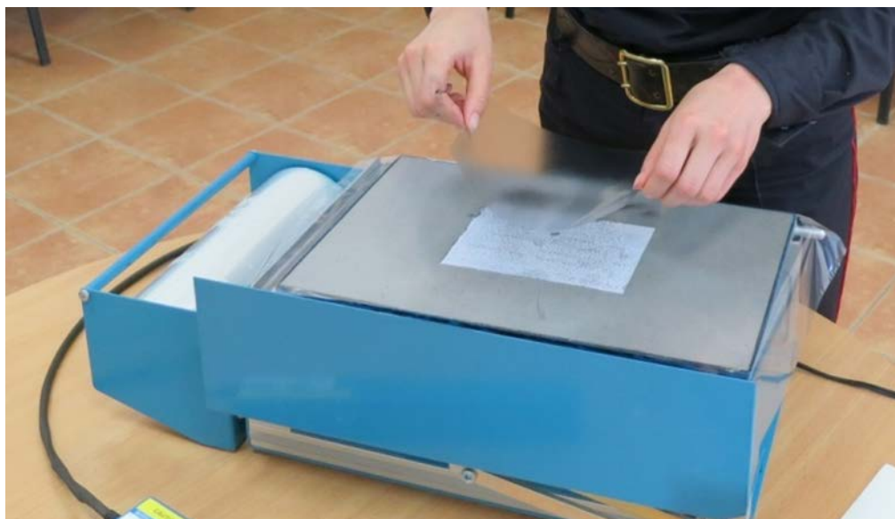
Рис. 12. Процесс фиксации выявленного скрытого изображения путем его заклеивания липкой пленкой на прозрачной основе
