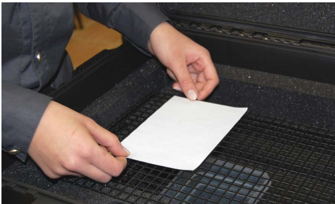
Рис. 5. Размещение исследуемого документа над кюветой с водой в увлажняющей камере установки «ESDA-Lite»
