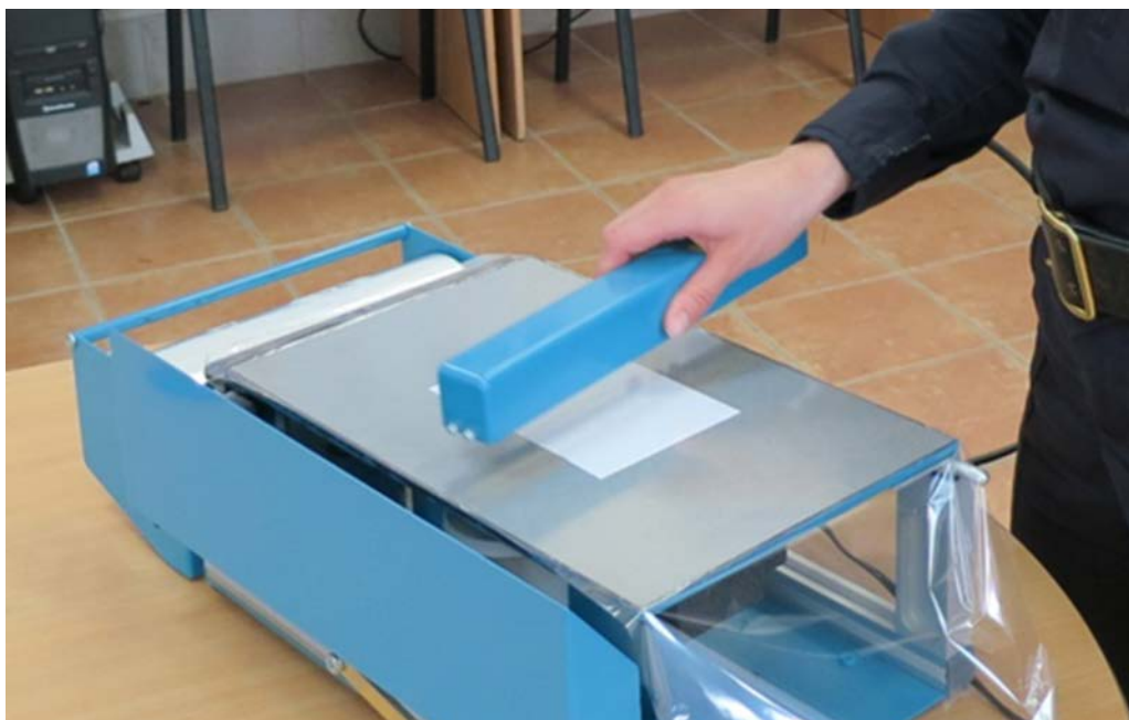
Рис. 8. Зарядка объекта исследования с помощью коронатора на вакуумном столике установки «ESDA-Lite»
