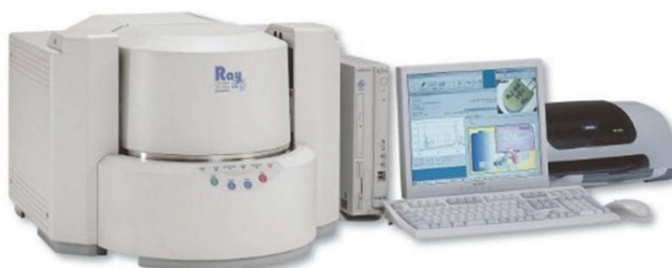
Рис. 31. Внешний вид РФА-спектрометра
