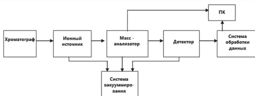
Рис. 38. Схема основных узлов хромато-масс-спектрометра
