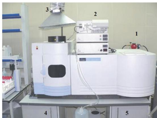
Рис. 27. Современный атомно-эмиссионный спектрометр:
