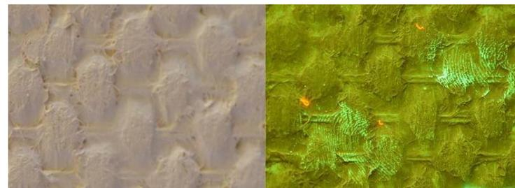
Слева – вид фрагмента стены в диапазоне видимого света, справа – вид фрагмента стены со следами рук в диапазоне синего света (420-470 нм)
