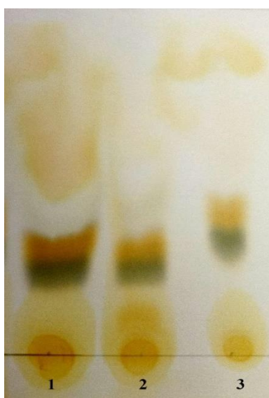
Рис. 3. Пример проявления хроматограммы (метод ТСХ) синтетических моторных масел парами йода: 1) «Шелл»; 2) «Субару»; 3) «Мобил»
