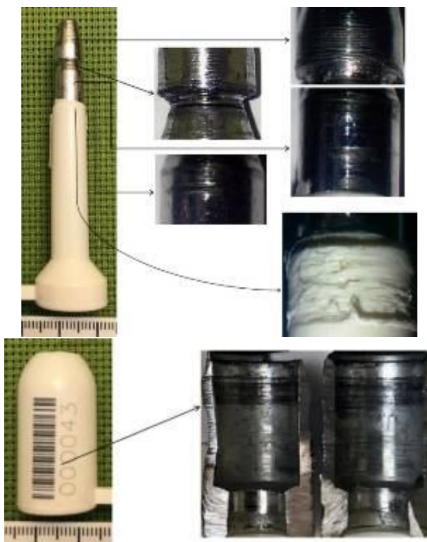
Рис. 3–4. Вид элементов стержневого ЗПУ, вскрытого способом прокрутки (стрелками черного цвета обозначены места, в которых образовались концентрические трассы)
