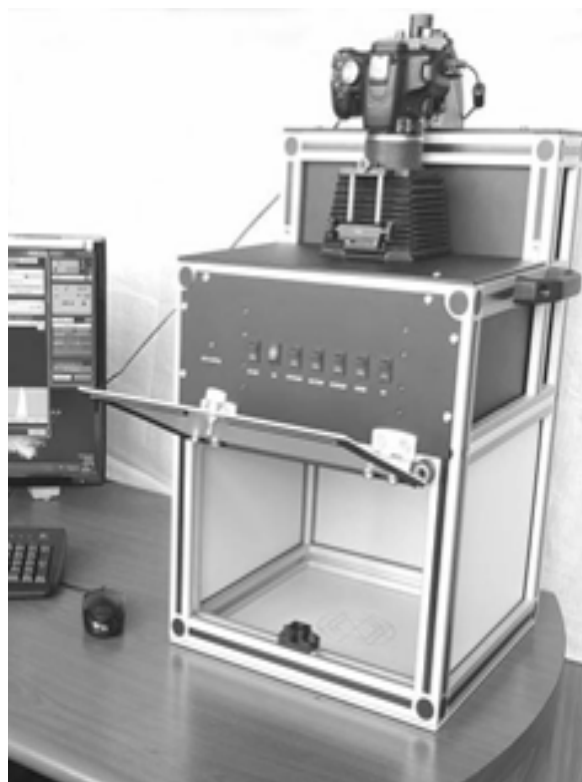
Рис. 1. Многофункциональный полупроводниковый осветитель «Фотобокс 3138»
