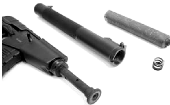
Рис. 2. Карабин модели «Винторез-СХ» со снятым глушителем [1]
