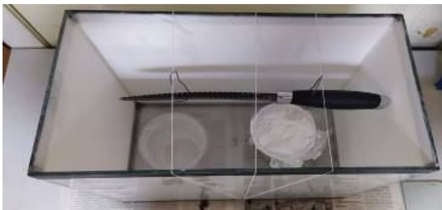
Рис. 3. Внутренняя часть цианакрилатной камеры
