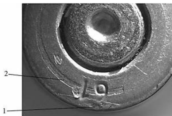
Рис. 3. Следы отражателя (1) и чашки затвора (2) на донной части гильзы
