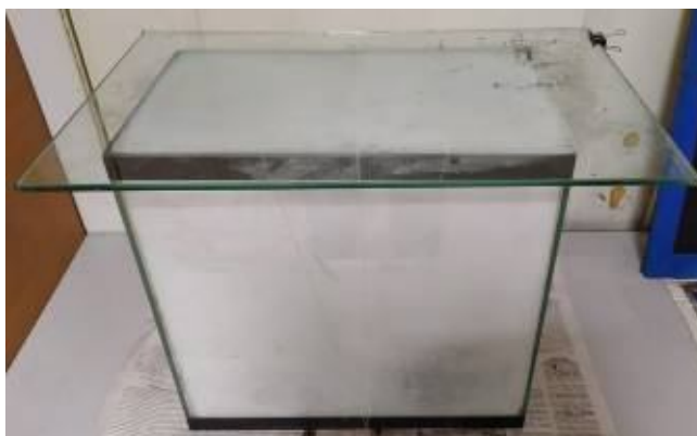
Рис. 2. Общий вид самодельной цианакрилатной камеры
