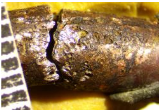
Рис. 2. Деформация тормозной трубки
