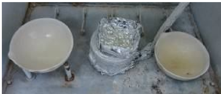
Рис. 5. Внутренняя часть самодельной цианакрилатной камеры
