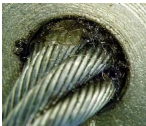
Рис. 6. Следы клеящего вещества вблизи корпуса ЗПУ
