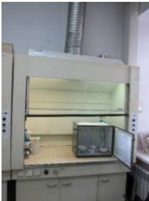
Рис. 4. Общий вид вытяжного шкафа и самодельной цианакрилатной камеры
