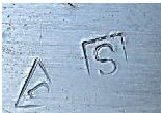
Рис. 6. Заводские клейма на внутренней части корпуса ствольной коробки
