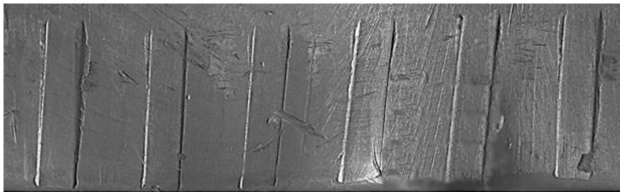
Рис. 1. Фоторазвертка следов канала ствола на пуле
