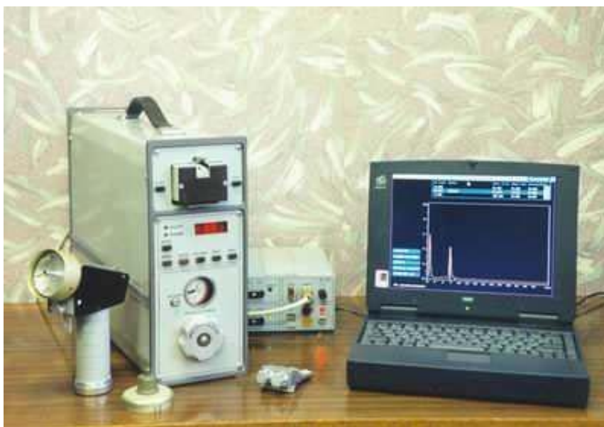
Рис. 7. Высокочувствительный газохроматографический анализатор взрывчатых веществ «ЭХО» (с детектором электронного захвата)
