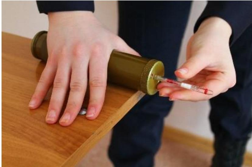
4. Осуществить прокачку воздуха через наполнитель индикаторной трубки.
