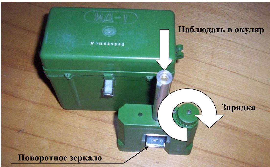
Подготовка дозиметра к работе заключается в его зарядке.
