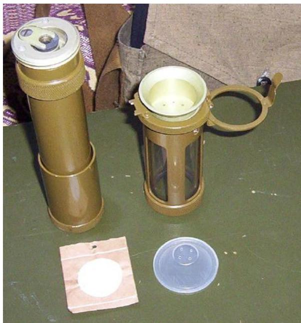
Насос, насадка к насосу, противодымный фильтр и защитный колпачок.
