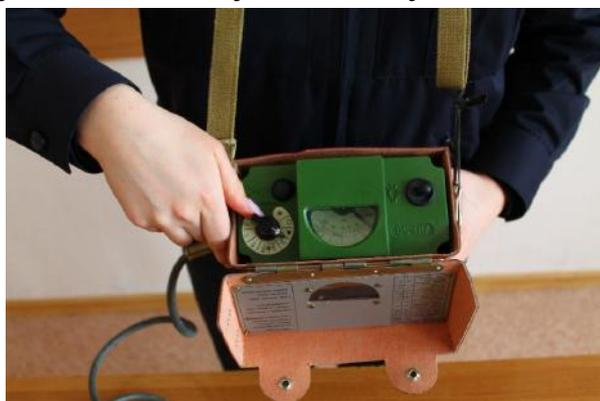
4. Включить прибор, поставив переключатель в положение  $\blacktriangle$ . Стрелка прибора должна установиться в районе черной черты, располагающейся между шкалами микроамперметра.
