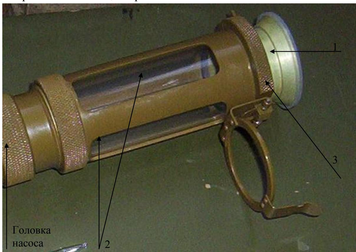
**Индикаторные трубки**, которые входят в комплект прибора, бывают четырех видов:
