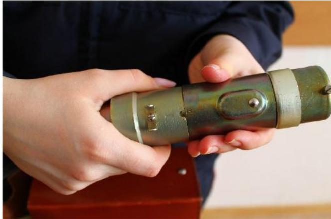
6. Ручку переключателя поддиапазонов, минуя режим «200», последовательно установить в положения «x1000», «x100», «x10», «x1» и «x0,1».
