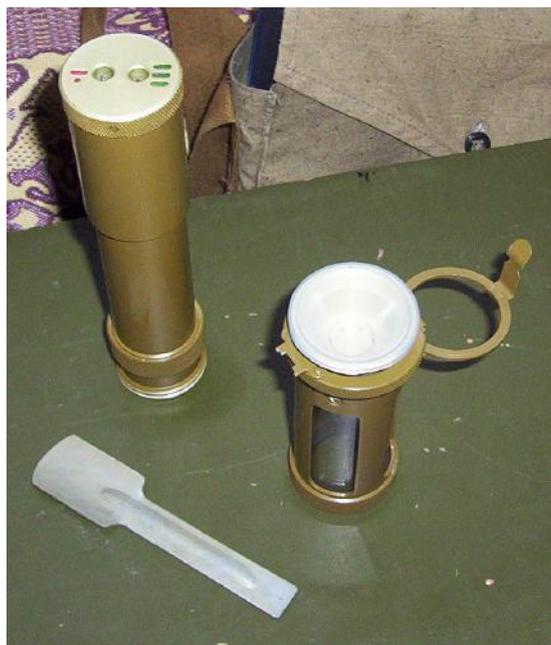
Насос, лопатка для забора проб, насадка к насосу с вставленным защитным колпачком.
