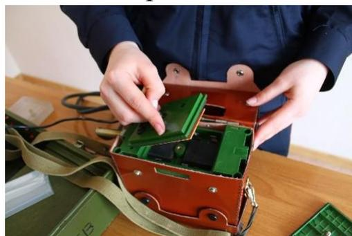
3. Закрывать крышку отсека питания, пристегнуть к футляру ремни и разместить прибор на груди, подключить головные телефоны, присоединить к зонду удлинительную штангу.
