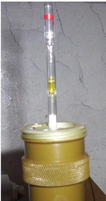
Индикаторная трубка вставляется в насос маркированным концом вверх после того, как была обрезана с обоих концов.
