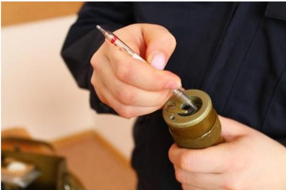
2. Обломить надпиленный конец трубки, используя отверстия в головке насоса.
