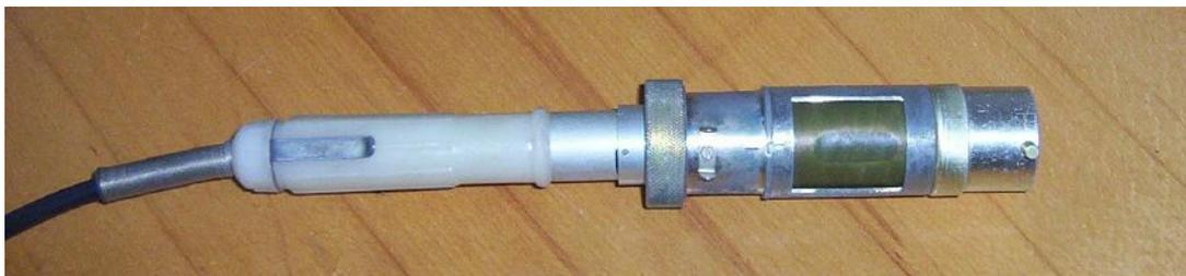
**Зонд** герметичен. В нем размещены монтажная плата с элементами электрической схемы, два газоразрядных счетчика СТС-5 (удлинённый) и СИ-ЗБГ. На плату надет стальной корпус с окном индикации бета-частиц. Окно заклеено водостойкой пленкой. Поверх кожуха имеется поворотный экран, фиксирующийся в положениях «Б» и «Г».
