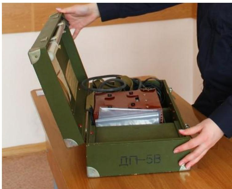
**Измеритель мощности дозы ДП-5В** предназначен для измерения мощности экспозиционной дозы гамма-излучения на радиоактивно зараженной местности, контроля зараженности объектов и продуктов питания, а также для обнаружения бета-излучения.
