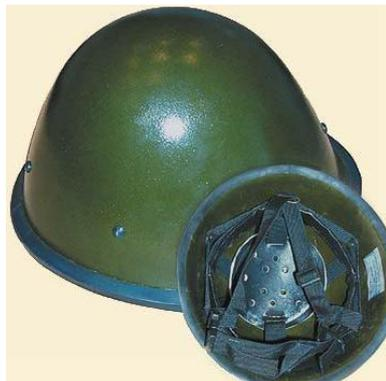
**Шлем стальной модернизированный «СШ-68Н»** обеспечивает защиту головы человека от пуль пистолета Макарова и револьвера системы Наган, а также осколков массой 1,1 г (стальной шарик 6,3 мм) и скоростью до 400 м/с.
