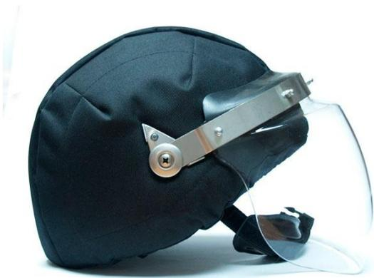
**Шлем защитный «Колпак-1»** предназначен для круговой защиты головы человека от воздействия ударных нагрузок различными поражающими элементами и холодным оружием (специальный класс защиты по ГОСТ, защита от холодного оружия – кинжал, нож – с энергией удара от 45 до 50 Дж, забрало – не более 25 Дж).
