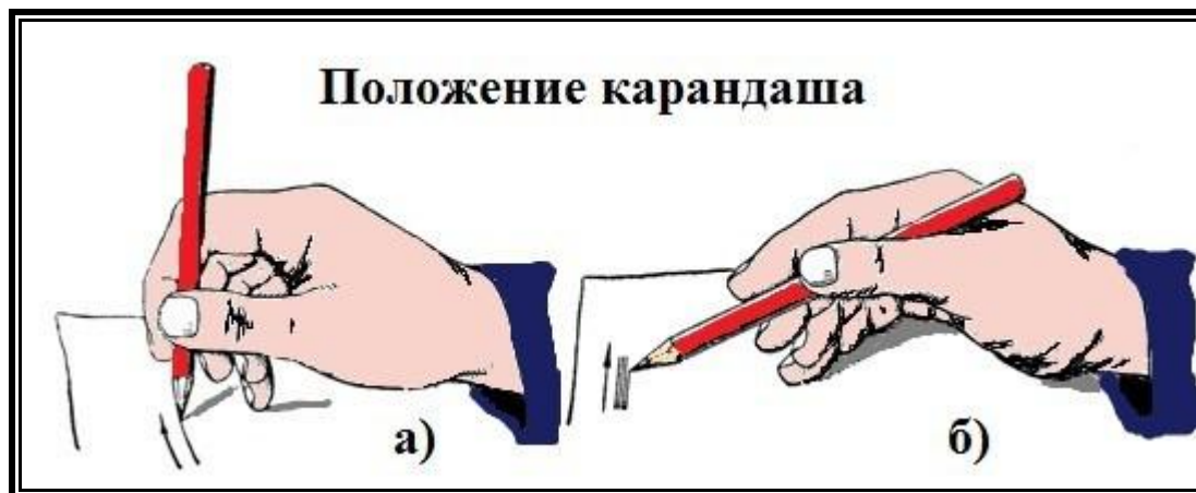
Рис. 89. Положение карандаша: а) при проведении линии; б) при штриховке
