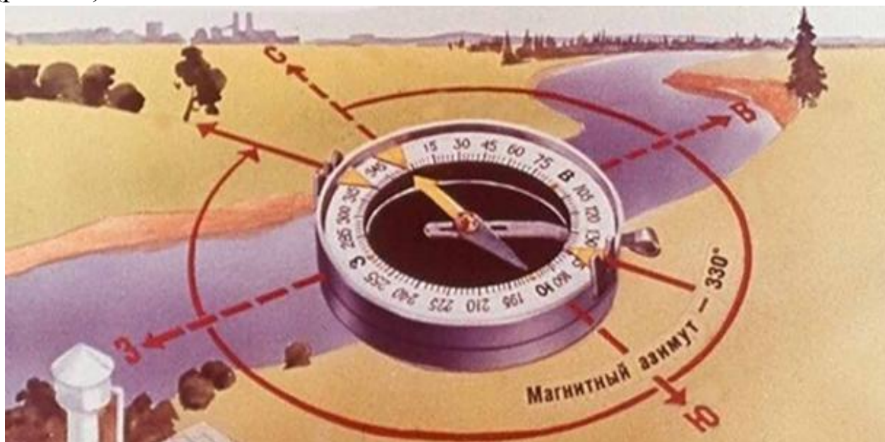
Рис. 58. Определение магнитного азимута отдельно стоящего дерева
