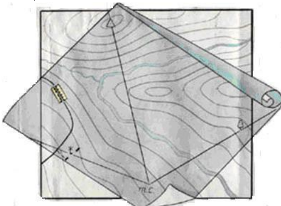
Рис 82. Наложение восковки на карту и совмещение направлений ориентиров
