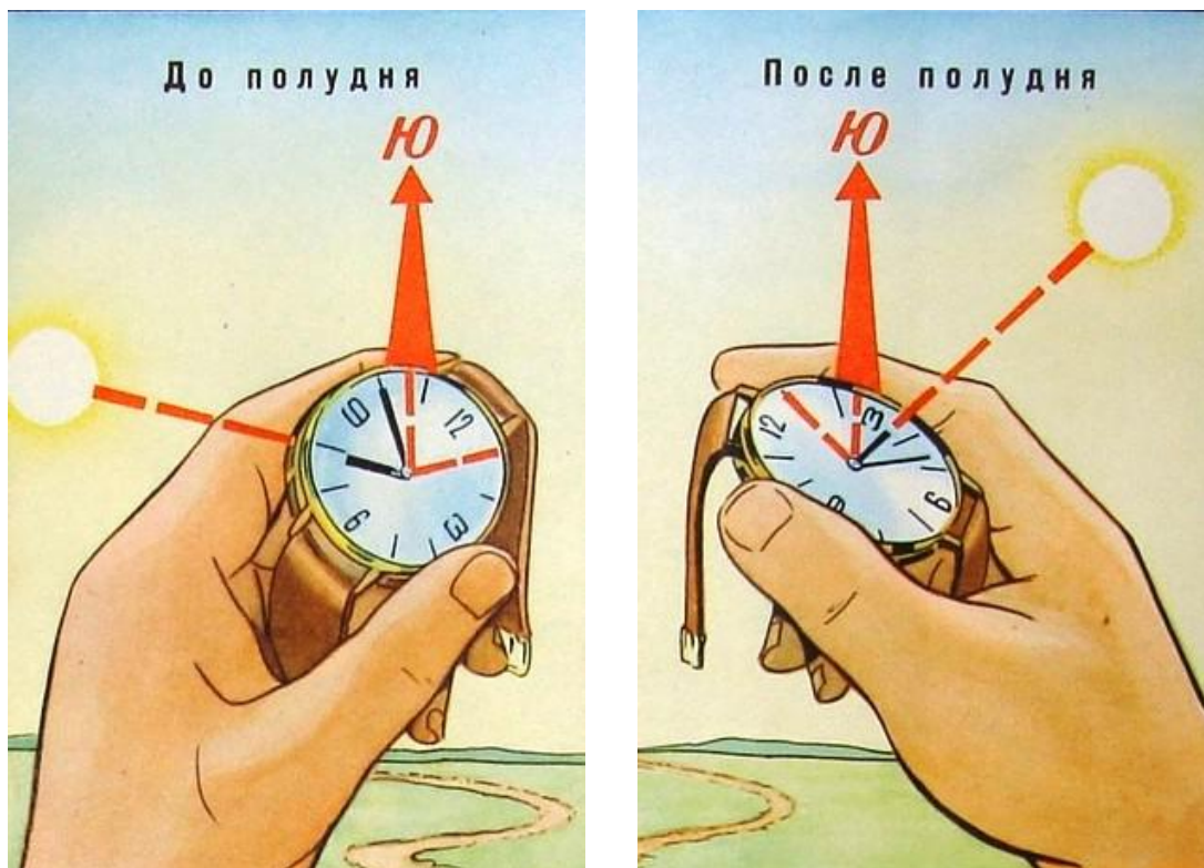
Рис. 59. Определение сторон горизонта по Солнцу и часам
