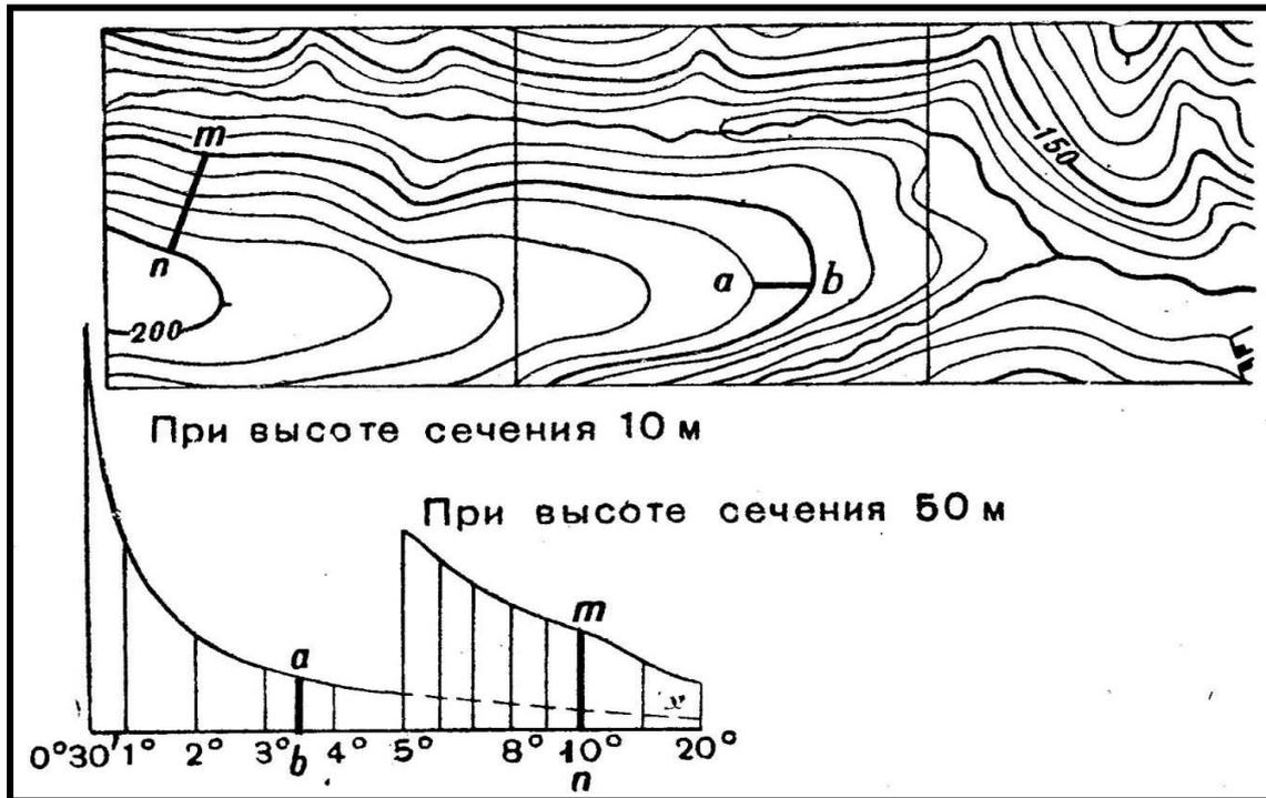
Рис. 3. Определение крутизны скатов с помощью шкалы заложений
