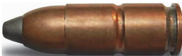
Учебный патрон предназначен для обучения правилам и приемам обращения с оружием и боеприпасами. Патроны используются также при заводских испытаниях оружия. Патрон состоит из компонентов боевого патрона, но не содержит порохового заряда, а капсюль охлажден. Как правило, патроны снаряжаются пулями со стальным сердечником «ПС», также известны образцы с пулями от патрона «РГ052» и пулями со свинцовым сердечником «СП-11».
