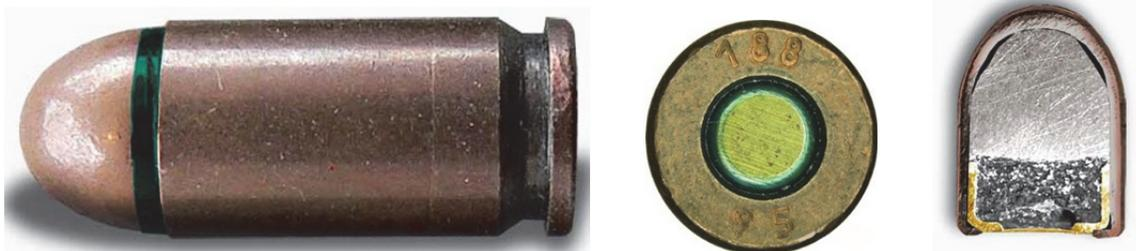
В 50-х годах конструкторами НИИ-61 В.В. Труновым и П.Ф. Сазоновым был разработан патрон с трассирующей пулей для пистолета Макарова. Пуля «ПТ» имела длину 12,5 мм, массу 6,3 грамма и начальную скорость 315-340 м/с. Данных о принятии патрона на вооружение тоже нет, что, вероятно, было связано с отсутствием необходимости в патроне с
