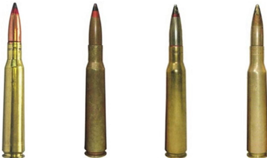
Образцы патронов 12,7x108 с бронебойно-зажигательной пулей Б-32 слева направо: современный патрон; патрон выпуска до 1941г.; патрон с оцинкованной пулей выпуска 1942 г.; патрон с латунированной пулей выпуска 1948 г.
