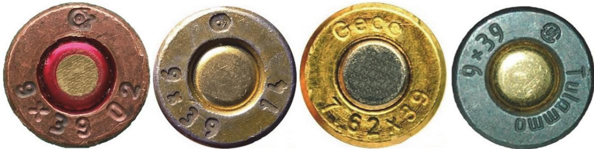
Маркировка гильз коммерческих патронов 9x39: КСПЗ; оружейная фирма Скат (предсерийный коммерческий патрон с использованием переобжатой латунной гильзы фирмы Geco) и «Tulammo» ТПЗ
