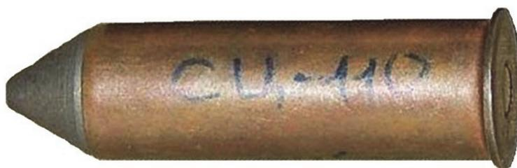
СЦ 110 – бронебойный патрон со стальной пулей массой 11 г и дульной энергией в 900 Дж. Такая пуля имеет начальную скорость полета 400 м/с и на дистанции в 50 метров пробивает лист стали толщиной 3 мм, на дистанции в 25 метров пуля в состоянии пробить стандартный элемент брони толщиной 4,5 мм. Это означает, что ни один бронежилет (до 4-го класса включительно) не в состоянии обеспечить защиту от данного патрона;
