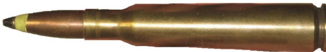
12,7-мм пулеметный патрон с бронебойно-зажигательной, фосфорной пулей БЗФ-46 обр. 1932 года (индекс 57-Б-532) (масса пули 48 г) разработан для авиационных пулеметов в ОКБ-46. Предназначался для стрельбы по
