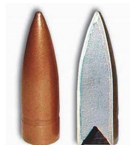
пуля с пониженной рикошетирующей способностью 7,62x54 винтовочного патрона ПРС
