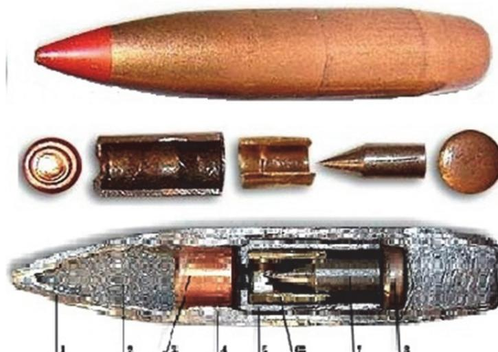
Пристрелочно-зажигательная пуля (7-3П-2): 1 – оболочка; 2 – зажигательный состав; 3 – капсюль-воспламенитель КВ-11; 4 – свинцовая рубашка; 5 – стаканчик; 6 – центробежно-инерциальный предохранитель; 7 – ударник; 8 – латунный кружок
