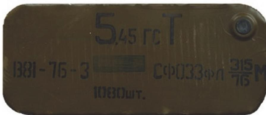
Образец маркировки на крышке металлической сварно-закатной коробки с патронами калибра 5,45мм с трассирующими пулями. Виден клапан для стравливания избыточного давления газов, выделяющихся со временем из трассирующих составов
