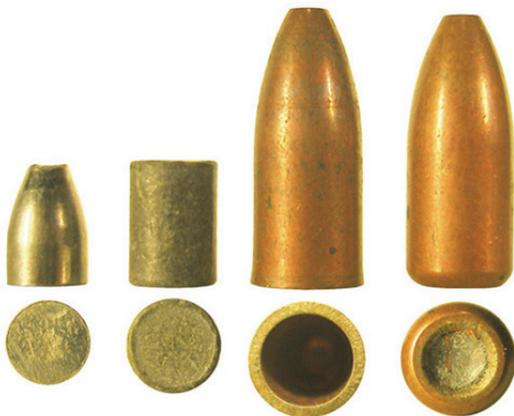
Компоненты пули 5,45 Пст: стальной сердечник, свинцовая рубашка и биметаллическая оболочка; справа – пуля, подготовленная к снаряжению
