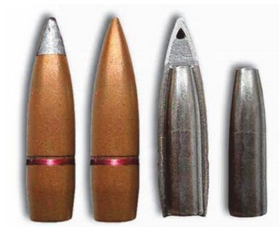
7,62-мм пуля со стальным сердечником 7,62x54 винтовочного патрона ЛПС
