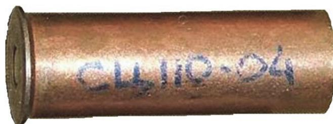
СЦ-110-04 – патрон, оснащенный свинцовой пулей массой 12 г и начальной скоростью полета пули 350 м/с. По своему останавливающему действию данная пуля превосходит абсолютное большинство современных револьверных и пистолетных пуль.
