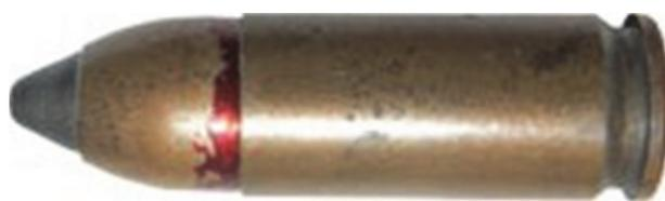
Уже в 1992 году пуля патрона «РГ052» была модернизирована. Новая пуля имела несколько большую длину - 20,28-20,5 мм, снаряжалась стальным сердечником с острой вершинкой (длина сердечника 19,2 мм и диаметром 7,15 мм), обработанным по технологии бесцентровой шлифовки.
