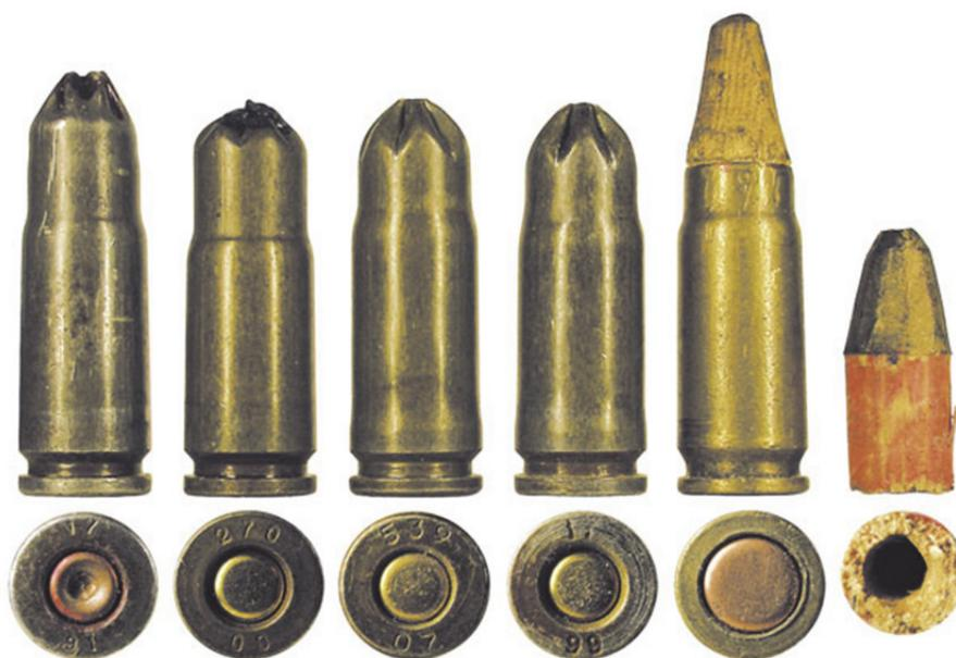
Различные холостые патроны: 1 – штатный армейский патрон 7X5; 2 – переделанный на киностудии патрон 7X5; 3 – серийный патрон в биметаллической гильзе, выпускавшийся для кино; 4–7 – кустарные холостые патроны, переобжатые из гильз патрона 5,45x39; 8 – самодельный холостой патрон с деревянной пулей
