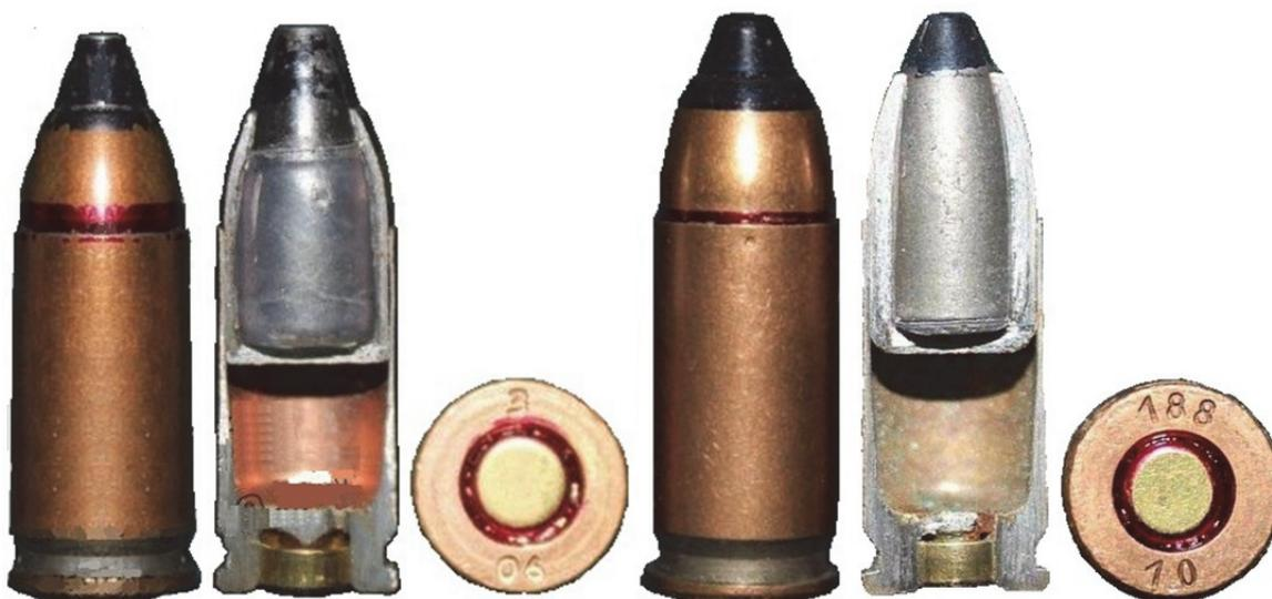
Слева патрон раннего выпуска. Сердечник помещен в полиэтиленовую рубашку, вершина сердечника выступает на 5 мм после оболочки пули. Дно пули прямое, без сужения краев. Справа патрон выпуска 2010 года, произведенный на Новосибирском патронном заводе. Сердечник помещен в свинцовую рубашку.
