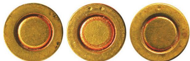
Варианты клейм патрона 5,45 МПЦ: без клейма производства ЦНИИТОЧМАШ с двумя точками – Юрюзаньский механический завод, с одной точкой – Тульский патронный завод
