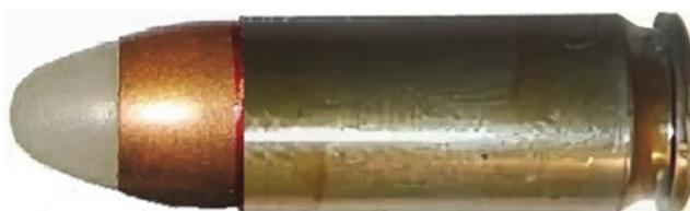
Ранние образцы пули «ПЭ» имели баллистический наконечник сферической формы, вследствие чего патрон имел меньшую длину, что вызывало проблемы при подаче патрона в патронник пистолета-пулемета, рассчитанного на патрон штатной длины с пулями «ПС». Так как использование экспансивных пуль в армии запрещено международными соглашениями, патрон принят на вооружение только спецподразделений ФСБ РФ и не имеет индекса ГРАУ. С 2006 года патроны «СП-12» выпускаются со стальными лакированными гильзами.
