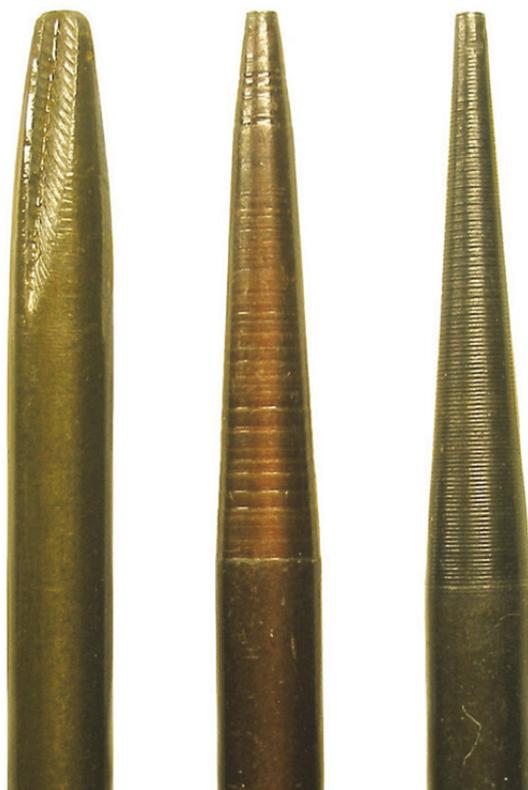
Головные части серийных пуль патрона 4,5-мм СПС: турбинного типа, с двойным конусом и с одинарным конусом
