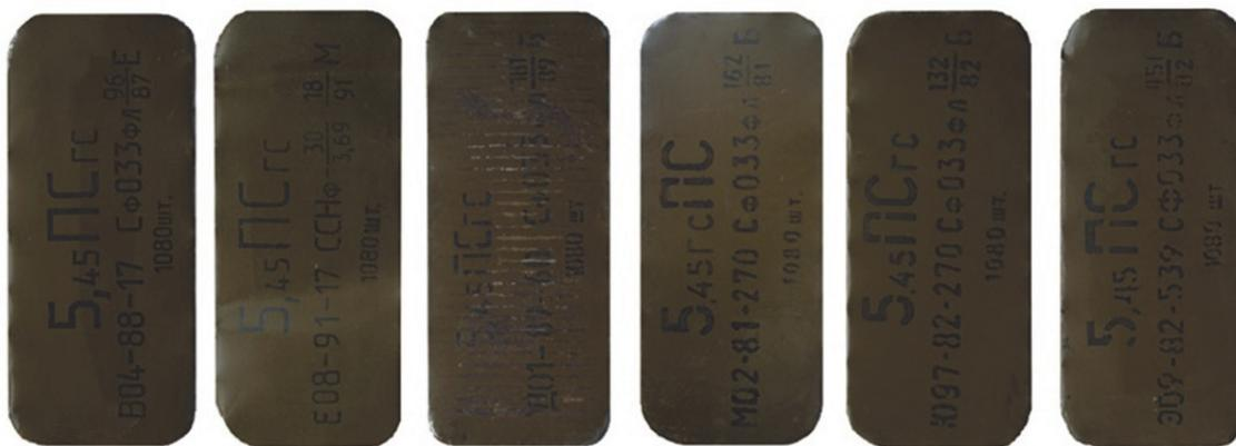
Варианты маркировки на крышках металлических сварно-закатных коробок с 1080 патронами калибра 5,45мм с обычными пулями ПС
