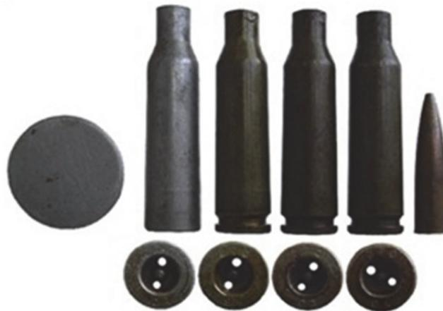
Фрагменты технологической последовательности изготовления гильз на примере Луганского патронного завода: стальной диск – исходный компонент для вытяжки гильзы; заготовка гильзы после обжатия дульца; еще не обрезанная по высоте, без проточки и лакового покрытия; конечный продукт – стальные лакированные гильзы, готовые к дальнейшему снаряжению, и пульная оболочка до запрессовки в нее сердечника
