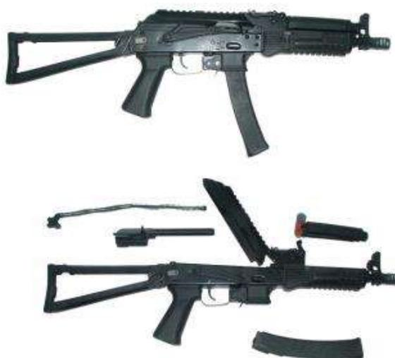
*Рис. 5. Общий вид и неполная разборка пистолета-пулемета «Витязь-СН»*
