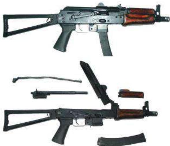
*Рис. 4. Общий вид и неполная разборка пистолета-пулемета «Витязь»*
