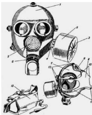
Рис. 1. Фильтрующий противогаз ГП-7: 1 – лицевая часть; 2 – фильтрующе-поглощающая коробка; 3 – трикотажный чехол; 4 – узел клапана вдоха; 5 – переговорное устройство (мембрана); 6 – узел клапана выдоха; 7 – obtюратор; 8 – изголовник (затылочная пластина); 9 – лобная лямка; 10 – височные лямки; 11 – щечные лямки; 12 – пряжки; 13 – сумка противогаза
