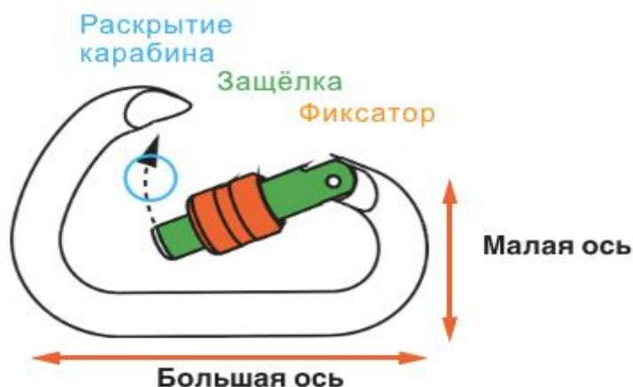
Рисунок 6. Соединительный элемент класса В.
