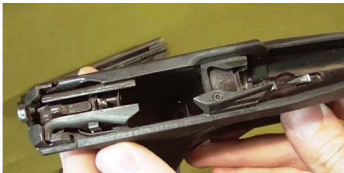
Рис. 3. Закладные стальные элементы в полиамидной рамке пистолета ГШ-18 (направляющие затвора, основание и фиксатор ствола)
