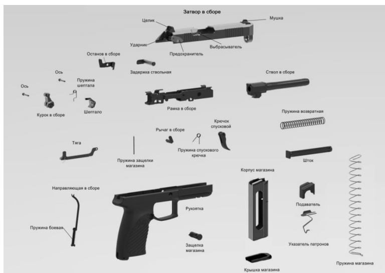
Рис. 5. Детали 9х21 мм пистолета 6П72 «Удав»
